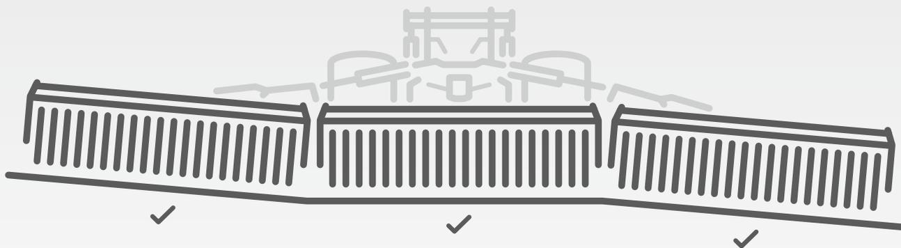
Благодаря ContourFrame компактная дисковая борона оптимально копирует рельеф также на пересеченной местности
