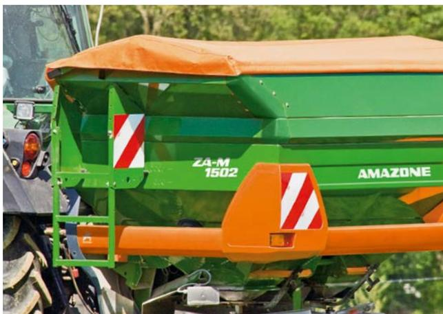
❗ «Защитный откидной тент также легко складывается и защищает бункер от загрязнений и дождя».
