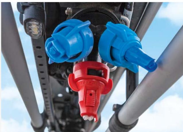
✔ Coupure électrique buse à buse AmaSwitch
