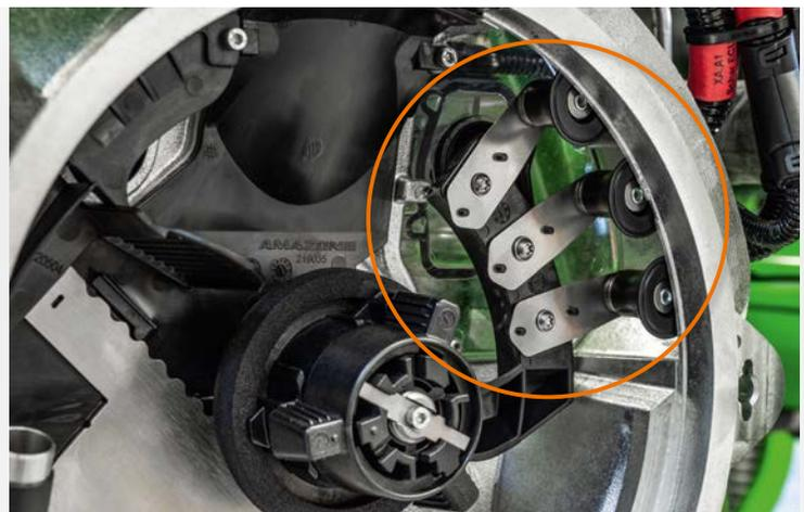
Le réglage automatique des sélecteurs SmartControl assure le réglage des sélecteurs en continu, permettant au chauffeur de rester concentré sur sa conduite
