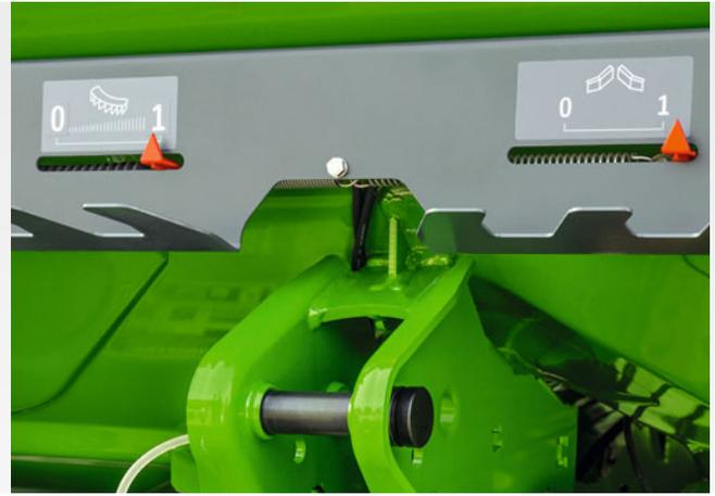
Affichage de position du Limiter (à gauche) et affichage de position du déflecteur pour travail en planches ou déflecteur de bordure (à droite)
