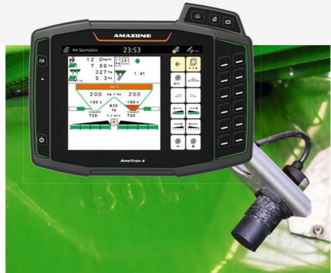
Le conducteur reçoit suffisamment tôt un message d'avertissement sur le terminal indiquant qu'un côté de trémie est presque vide.
