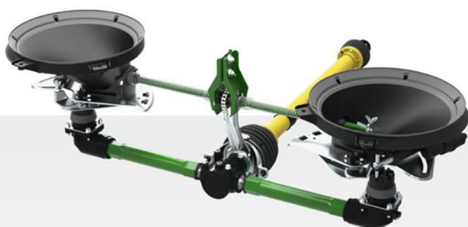
Représentation schématique du ZA-V entraîné mécaniquement
