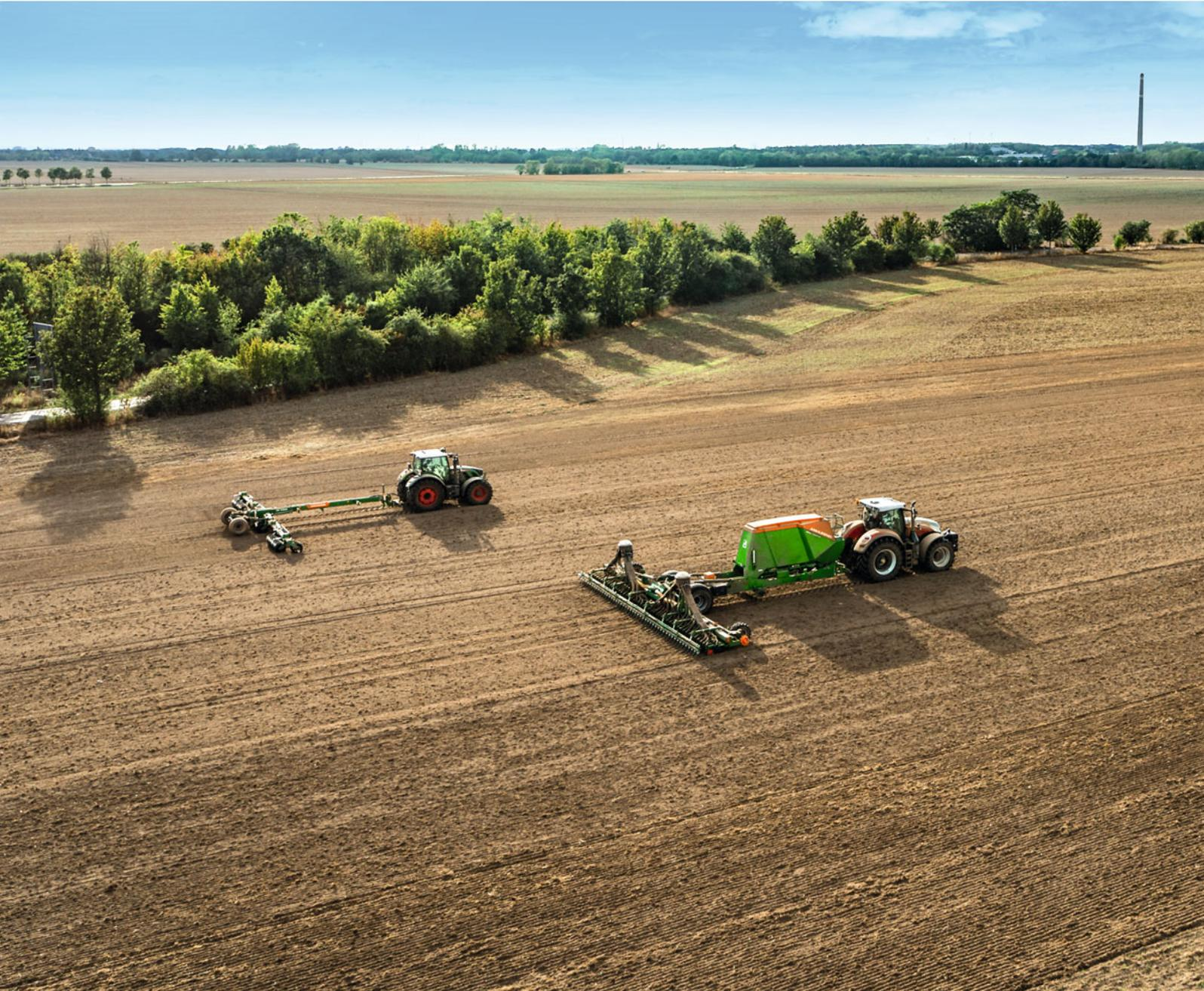
Die Anhängesämaschine Citan erzielt aufgrund ihrer Leichtzügigkeit und ihren Arbeitsbreiten von 12 m und 15 m sehr hohe Flächenleistungen. Mit ihrem 7.800 l Behältervolumen bietet die Citan eine enorme Schlagkraft besonders für den Großflächeneinsatz bei kleinen Saatzeitfenstern. Die Citan verfügt serienmäßig über einen 3-Kammerdruckbehälter, mit dem zusätzlich auch Dünger in die Säfurche abgelegt werden kann.
