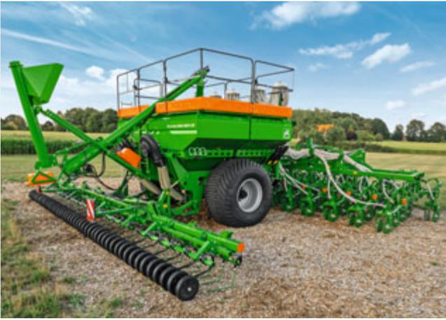
Primera DMC 9001-2C mit Befüllschnecke
