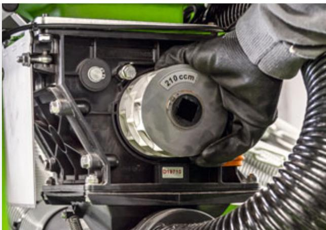
Einfacher Wechsel der Dosierwalzen für verschiedene Saatgutmengen und -arten
