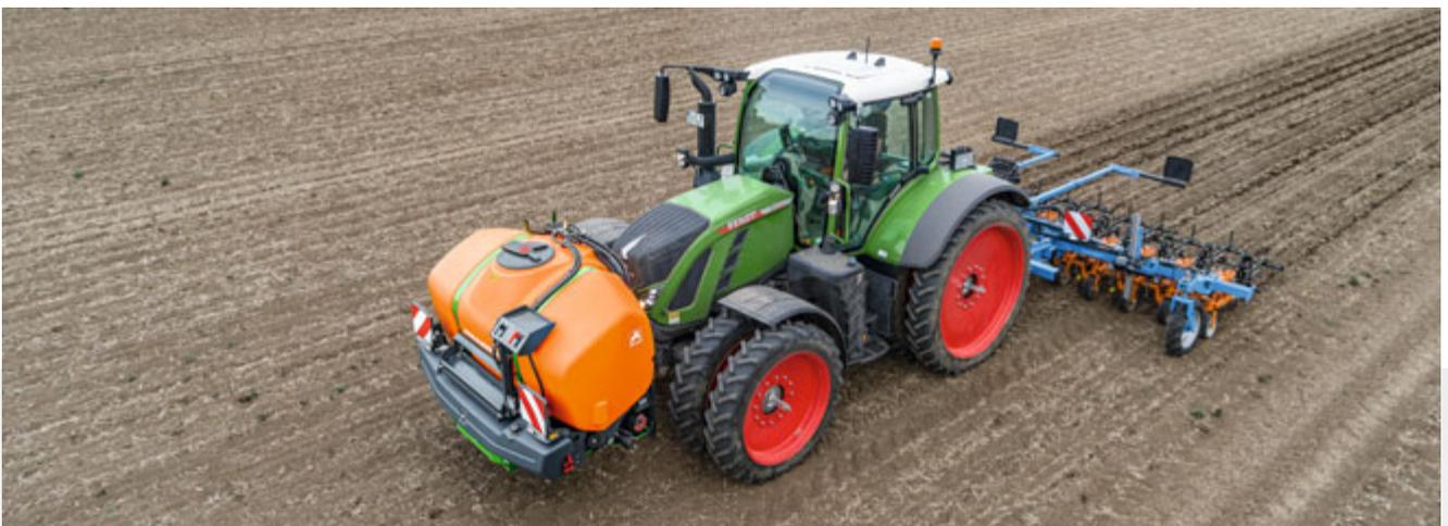
Der FT-P kann neben der Primera DMC auch mit vielen weiteren Maschinen kombiniert werden. Hier der autarke Fronttank FT-P im Einsatz mit einer Hacke von SCHMOTZER
