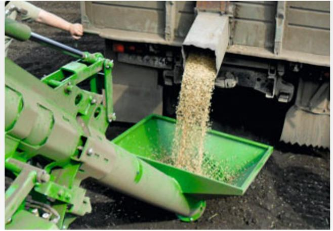
Um den Behälter der Primera DMC mit Saatgut und Dünger zu befüllen, bietet AMAZONE eine hydraulisch angetriebene Befüllschnecke an. Damit lassen sich die Befüllzeiten auf bis zu 15 Minuten reduzieren und die Arbeitsleistung der Maschine dementsprechend weiter erhöhen.
