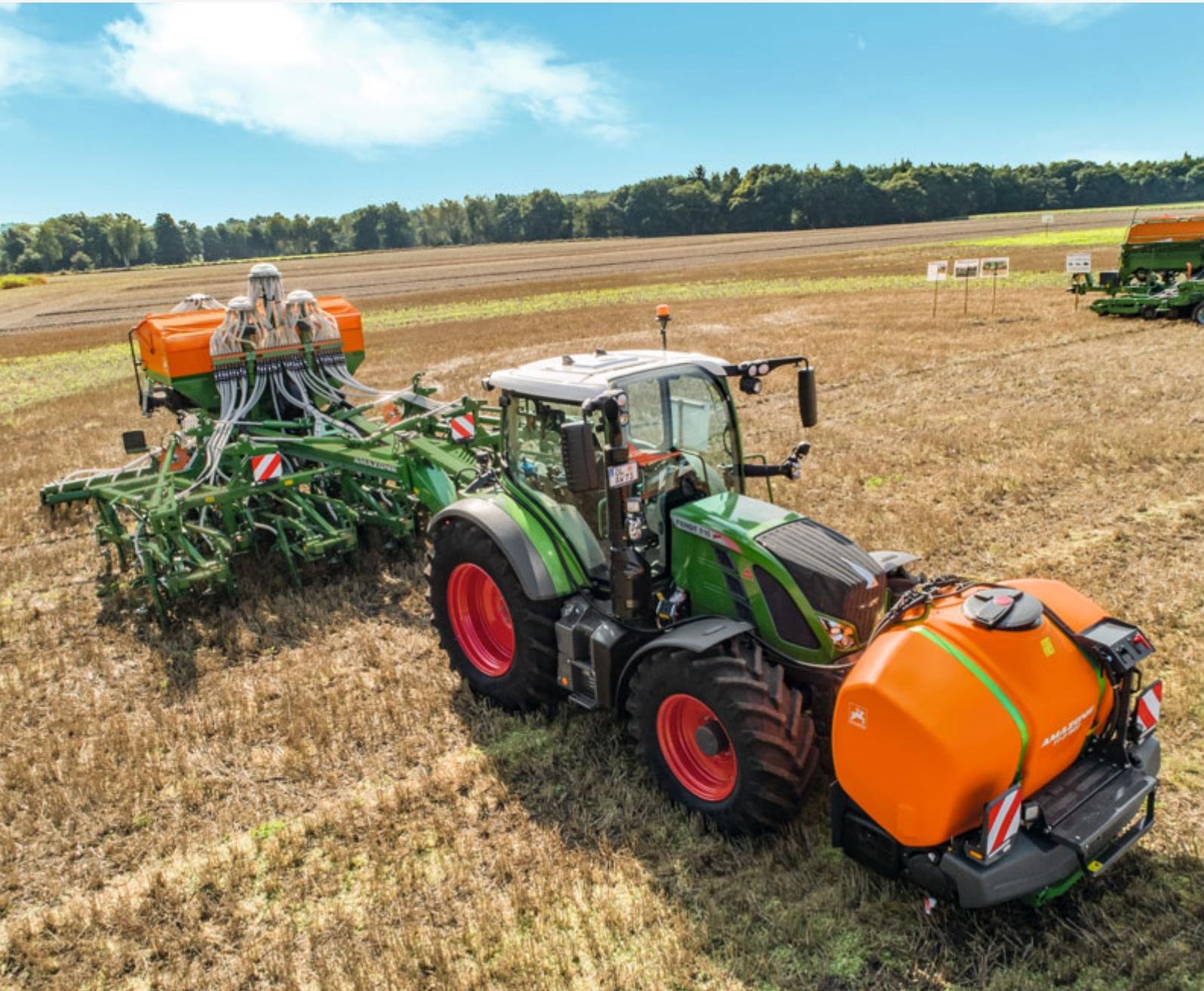
Der autarke Fronttank FT-P kombiniert mit einer Primera 6000-2C für die zusätzliche Ausbringung von Flüssigdünger zur Saat
