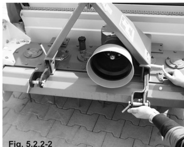
Les bras d'attelage inférieurs du tracteur doivent être accouplés aux bras d'attelage inférieurs de la herse rotative et immobilisés à l'aide de goupilles rabattables. Le tirant supérieur du tracteur doit être réglé de façon à ce que la herse rotative soit très légèrement inclinée vers l'arrière.
