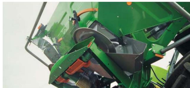
保護カバーによりトラクタおよびブロードキャストのコンポーネントが保護されています。肥料を加速する散布ディスクの回転数は 720 rpm と低いいため、ダストの発生や粒子の破壊が避けられます。
