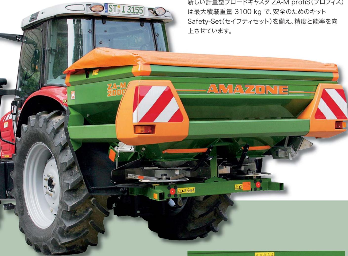
新しい計量型ブロードキャスタ ZA-M profiS(プロフィス)は最大積載重量 3100 kg で、安全のためのキット Safety-Set(セイフティセット)を備え、精度と能率を向上させています。
