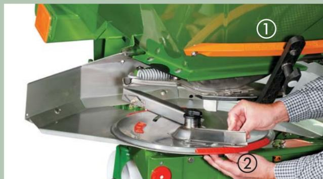
工具を使わず ① 散布量と ② 作業幅が簡単に設定できます。スケールは大型で、計量シャッター ① による散布量の設定、散布羽 ② による作業幅の設定が正確にできます。
