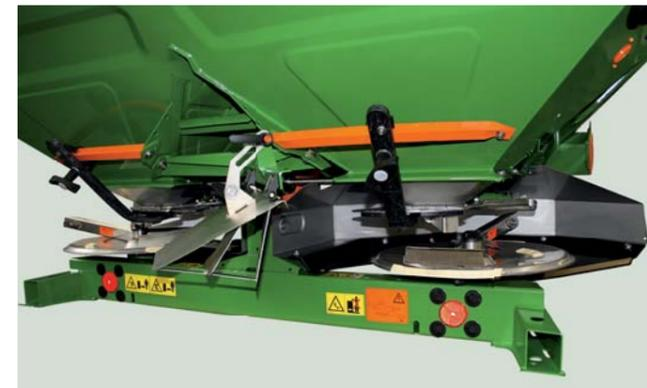
手動で折り畳める片側散布ディフレクタにより、走行方向左側での周縁散布を安価に実現することができます。
