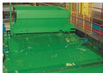
自動車製造で標準的に用いられている電気泳動塗装
