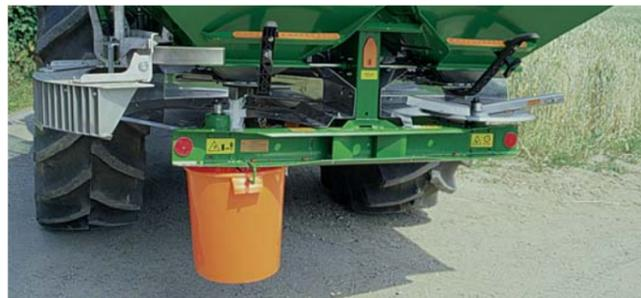
幅広く記載された散布表を利用して散布量と作業幅を予め定めることができます。物性(流動性など)測定のためのキャリブレーションテストにより散布量のチェックができます。
