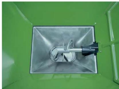
ステンレス鋼製ホッパ先端が深いため肥料の残留量が僅少です。緩やかに回転する(196 rpm)円形のアジテーターにより、肥料は流出口に至るまで穏和・均一に運ばれます。
