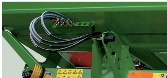
油圧ホースホルダにより油圧カプラの汚れを防止しています。
