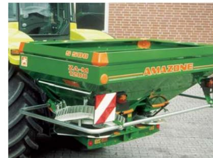
大型反射板付きの道路走行用ライトにより道路上の走行の安全性が向上します。堅牢な保護チューブは安全規制に適合しています。
