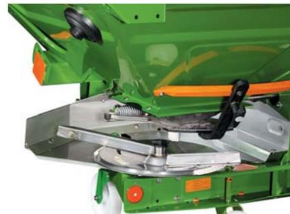
計量用、開閉用のダブルシャッターは両側に設けられた復動シリンダと散布量調整レバーにより独立して操作可能です。
