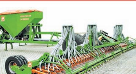
Сеялка точного высева ED работает чрезвычайно точно по вакуумному принципу. Благодаря вакууму зерно надежно затягивается в фасонные отверстия. Точное отделение семян производится механически при помощи чистика. Он работает независимо от скорости и формы семян. Высевающий аппарат подходит для классического и мультирующего посевов. Работает в хозяйстве «Север Кубани» Кущевского района.
