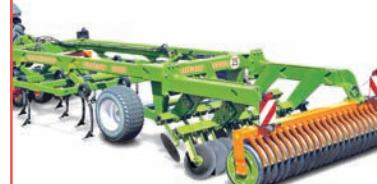
Сеялка Citan 12000 - новейшая разработка фирмы «Amazone», способная за 18 часов высевать 250 - 280 гектаров. При транспортировке складывается в компактные три метра. Управляется одним механизатором. В зависимости от задач Citan работает на глубине от 2 до 5 см. Работает по традиционному и мультирующему посевам.
