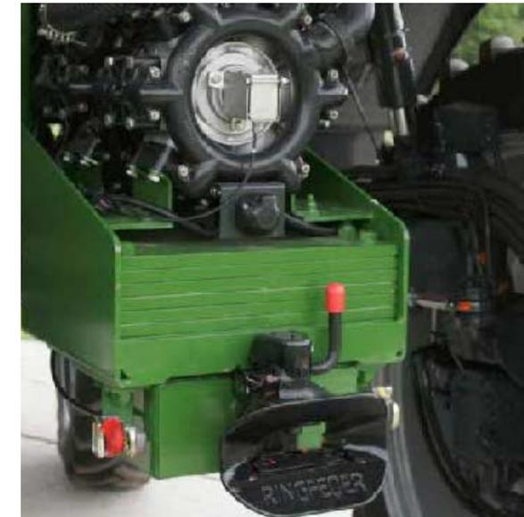
**Zugöse mit Druckluftanlage**
