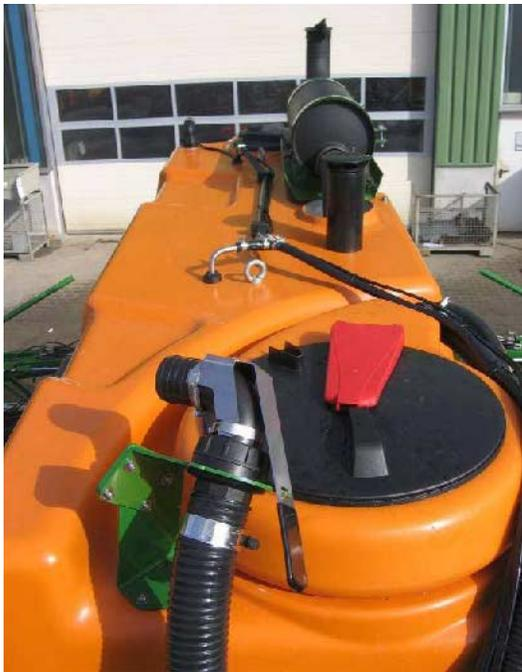
Die große Einfüllöffnung mit dem dicht schließenden Deckel erleichtern die Kontrolle.
