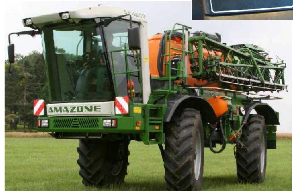
Im Hundegangmodus wird die Hinterachse über einen Kippschalter gesteuert. Die Vorderräder konventionell mit dem Lenkrad
