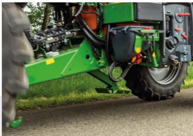
Suspensión inferior con pie de apoyo hidráulico
