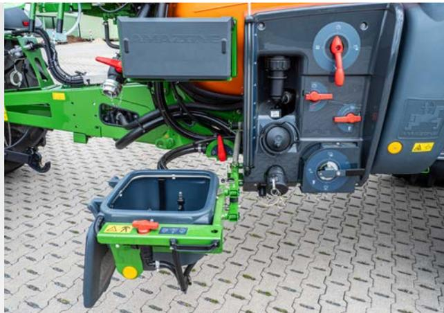
SmartCenter en el lado izquierdo de la máquina con el depósito de llenado desplegado
