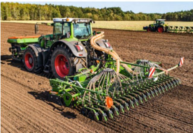
KG 6002-2 ripiegabile con larghezza di lavoro di 6 m e barra di semina portata Avant con coltri TwinTeC
