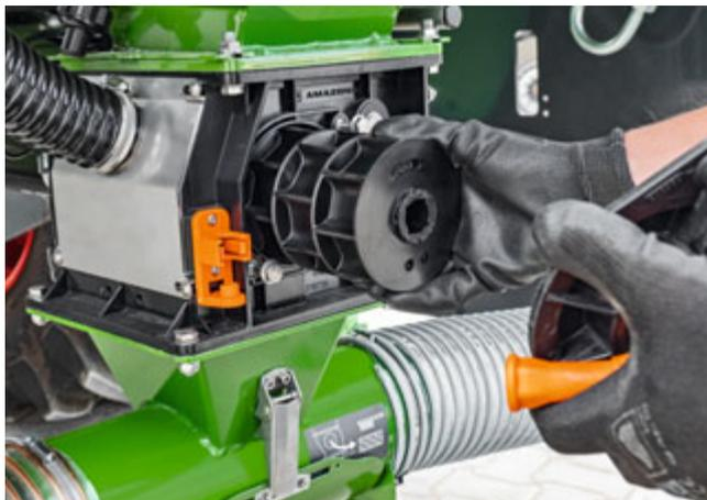
Facile sostituzione dei cilindri dosatori nel FTender
