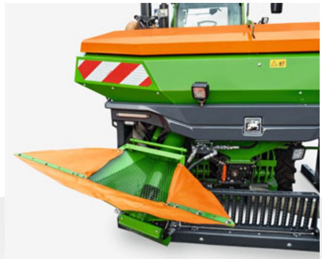
Come opzione è disponibile una coclea di riempimento con tramoggia di ripresa ripiegabile. In questo modo si può riempire con facilità direttamente dal rimorchio. Nella posizione di trasporto, la coclea di riempimento viene chiusa saldamente con un coperchio.
