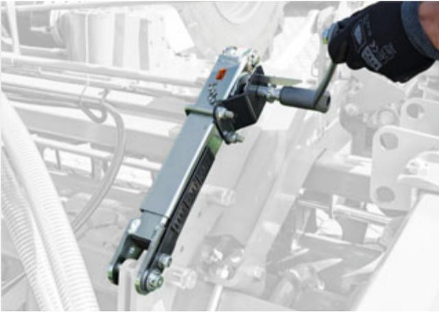
Regolazione centrale della profondità di semina mediante utensile universale
