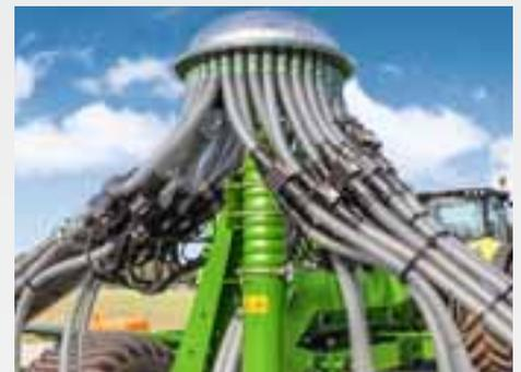
Um sistema de assistência útil é o monitoramento opcional da linha de sementes, que reconhece imediatamente os bloqueios na haste e na linha. Diretamente atrás do cabeçote distribuidor, os sistemas de sensores nas mangueiras de sementes monitoram o fluxo de sementes.
