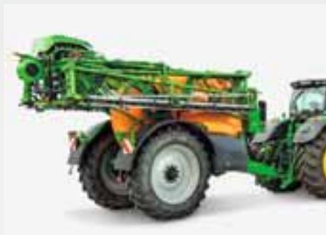
Com uma largura de transporte de apenas 2,6 m, a barra Super-L2 de 21 m a 36 m é dobrada de forma muito estreita ao lado do tanque. Com uma altura máxima de transporte de 3,8 m, o UX tem um design muito compacto, mesmo com pneus altos (18.4R46).
