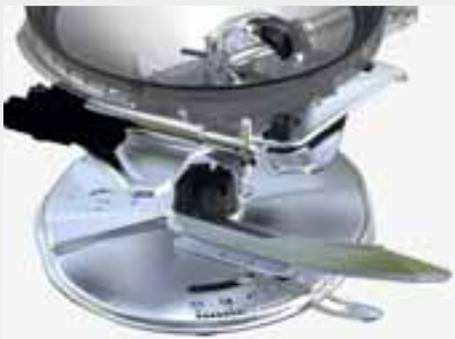
O mecanismo de distribuição de última geração do ZA-V atinge uma produtividade de até 390 kg/min graças à sua grande abertura do obturador. A ponta do tanque que brota na abertura da corredeira evita quantidades residuais e é fácil de limpar.
