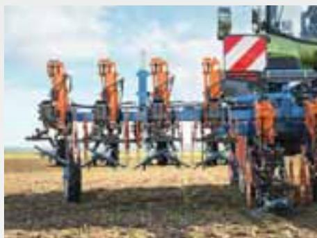
O elevador hidráulico simples de paralelogramo, controlado pelo Section Control, permite sachar até o último ponto. Com o paralelogramo do cultivador KPP-L SC, é possível um vão livre do solo de até 50 cm para os elementos da haste, ideal para uso em culturas de crescimento alto.
