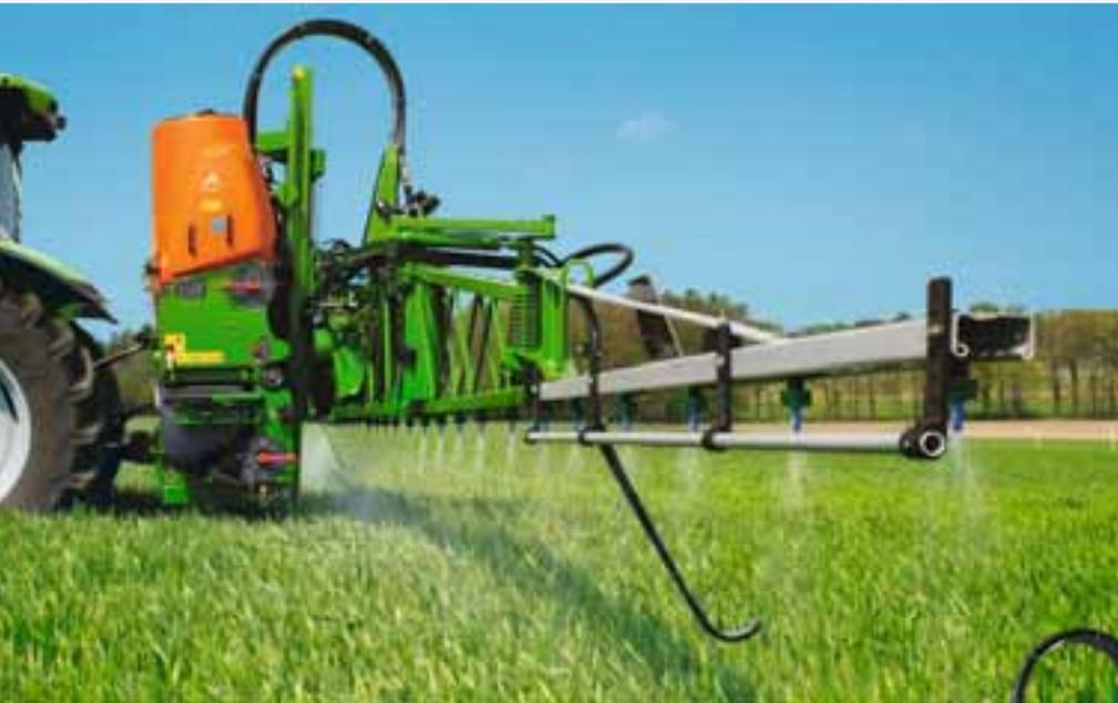
Pulverizador montado UF 1201 com barra Super-S2 de 18 m
