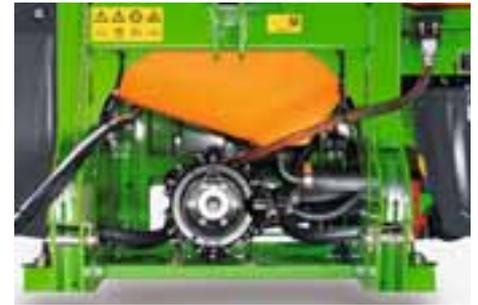
As bombas de pistão com diafragma são seguras para operar a seco e resistentes a fertilizantes líquidos. O modelo das bombas garante uma entrega consistentemente alta e uma operação suave da bomba, mesmo em altas pressões, mantendo ao mesmo tempo uma alta capacidade de sucção.
