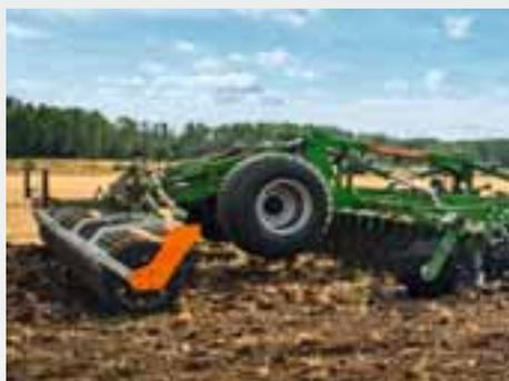
O chassi central integrado proporciona ao Certos-2TX um alto grau de manobrabilidade. O Certos-2TX está equipado de série com um sistema de amortecimento de tração para garantir um funcionamento suave e uma qualidade de trabalho consistente.
