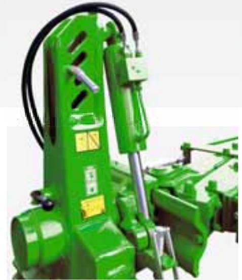
Todas as engrenagens rotativas dos arados Cayros são equipadas com um cilindro de dupla ação com troca automática. Isso garante que o arado gire suavemente e sem solavancos, e a rotação do arado também pode ser operada com uma válvula de controle de ação simples com retorno sem pressão. As sofisticadas guias da mangueira evitam danos.
