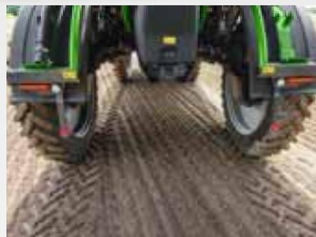
Deve-se enfatizar a função de proteção do solo da direção compensada, na qual as rodas dianteiras podem ser ajustadas para a largura mínima da pista e as rodas traseiras para a largura máxima da pista.
