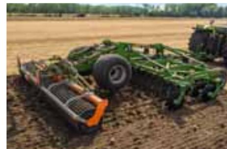
Para obter um controle uniforme da profundidade da máquina, o Certos-2TX é guiado na parte traseira pelo rolo de arraste e na parte dianteira por rodas de apoio.
