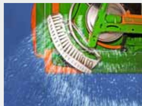
Não há necessidade de parar ou descer do trator ao espalhar em bordadura, limite ou vala com o sistema de distribuição em bordadura Limiter, com controle remoto hidráulico.
