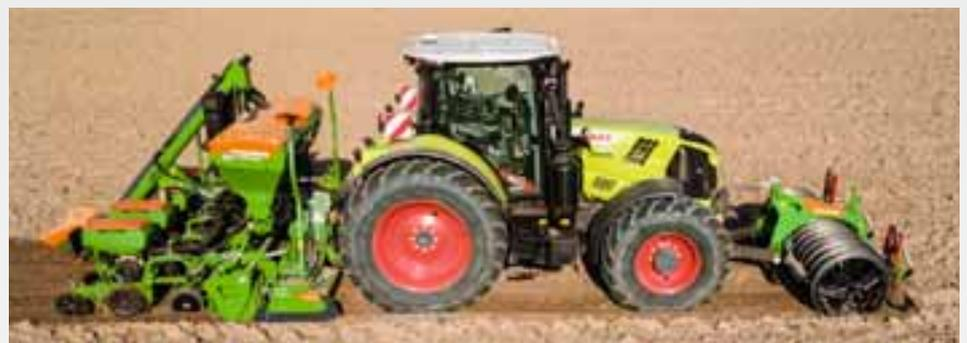
Graças ao sistema inteligente de acoplamento rápido QuickLink para todas as semeadoras de grãos finos sobre rotativas de 3 m e 4 m, a combinação de semeadoras pode ser separada facilmente em apenas alguns minutos. Três pontos de acoplamento de fácil acesso do sistema de acoplamento rápido QuickLink garantem um acoplamento e desacoplamento seguros, rápidos e sem ferramentas. Isso significa que o implemento de preparação do solo também é perfeito para uso individual.
