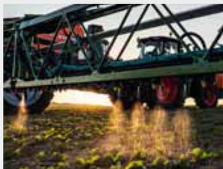
O sistema reconhece quais configurações específicas do campo e com qual mistura de herbicida recomendada o sistema SmartSpraying deve ser usado e quando.
