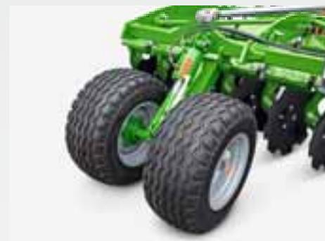
A profundidade de trabalho do Certos-2TX é ajustada de forma contínua e hidráulica por meio das rodas de apoio e do banco do trator. O indicador da profundidade de trabalho é claramente visível do banco do trator e, portanto, pode ser facilmente verificado a qualquer momento.
