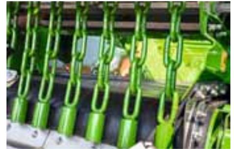
O rastelo de corrente opcional garante que os discos dispersores sejam alimentados de maneira uniforme e limpa na esteira inferior. Se o ZG-TX voltar a ser utilizado para distribuir fertilizante mineral, as correntes podem ser penduradas de forma fácil e conveniente em um suporte.
