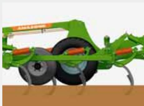
Rodas de apoio pressurizadas adicionais são integradas à máquina a partir de uma largura de trabalho de 6 m para garantir que a máquina permaneça estável e trabalhe em uma profundidade constante, mesmo com larguras de trabalho maiores. Para soltar os rastros dessas rodas, é também montada uma haste atrás de cada roda.
