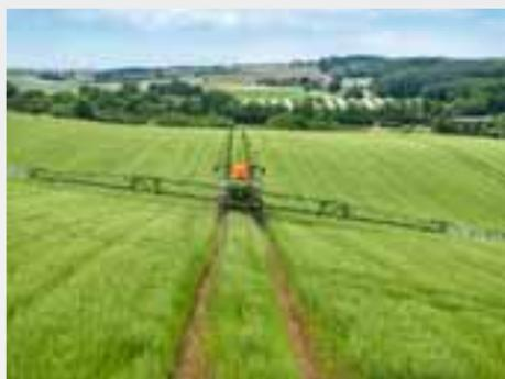
Outro destaque é a função integrada de nivelamento de inclinação. A inclinação do veículo é reconhecida pelo sistema de sensores e a máquina é mantida automaticamente nivelada até uma determinada inclinação.
