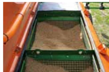
Tanque pressurizado com volume de 7800 L, dividido em 2 seções (2/3 de semente + 1/3 de fertilizante). O fertilizante é aplicado com a semente no sulco de semeadura. Dessa forma, ao semear cereais de inverno, é possível aplicar uma dose inicial adequada ou, ao cultivar culturas de verão em condições continentais, é possível obter uma fertilização ideal e completa diretamente no solo, sem perdas.
