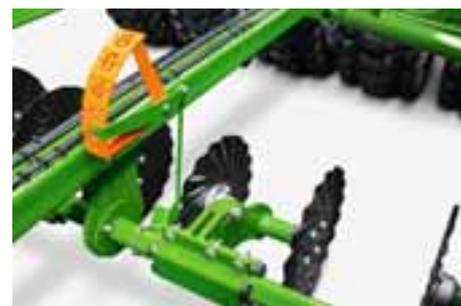
Com o campo mínimo de discos corrugados TillDisc, a Cirrus tem outro recurso especial na área de ferramentas preparatórias. Em uma distância entre sulcos de 16,6 cm, os discos de corte podem ser usados diretamente na frente dos discos de semeadura para cortar o solo, resíduos de colheita ou até mesmo populações de plantas.
