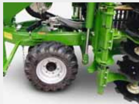
O conceito de compactador anteposto na Cirrus 4003-2/2C/2CC e 6003-2/2C/2CC pode ser complementado pelo T-Pack IN. Ele é instalado no centro da máquina, abaixo da barra de tração, e pressiona o rastro intermediário do trator.
