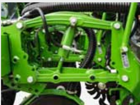
A pressão de haste pode ser ajustada de forma fácil e conveniente usando o ajuste hidráulico da pressão de haste. A pressão de haste pode ser ajustada para até 350 kg por meio do terminal de controle, mesmo durante a condução.
