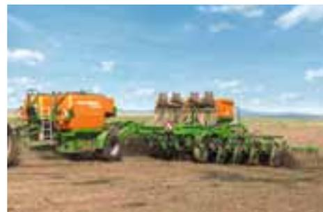
Em combinação com a semeadora Primera DMC, a semeadora Condor ou a semeadora de precisão EDX, o Fertiliser Delivery Cart FDC (carrinho de distribuição de fertilizante) pode ser usado especialmente em locais de campo seco. Uma bomba fornece o fertilizante líquido para as hastes de sementeira, que injetam o fertilizante no solo. Essa combinação é usada para realizar a sementeira e a fertilização inicial em uma única passagem.
