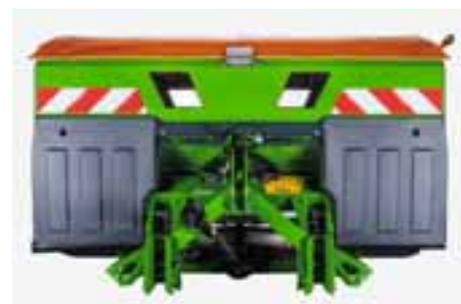
Uma estrutura estável e um bom centro de gravidade tornam o ZA-V um acessório robusto. A estrutura Super tem uma carga útil de 3200 kg e a estrutura Ultra, mais de 4500 kg.
