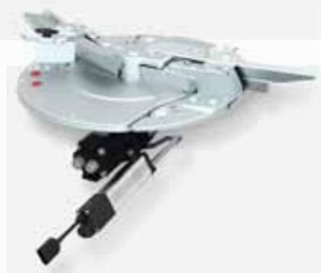
O mecanismo de distribuição TS com sistema de distribuição em bordadura AutoTS integrado: Diferentes palhetas dispersoras são ativadas no disco dispersor para distribuição normal e em bordadura. Excelentes leques da distribuição em bordadura sem trocar o disco – controle remoto a partir do banco do trator enquanto dirige.
