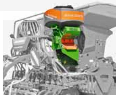
A Centaya também pode ser usada para aplicar culturas secundárias, granulados para lesmas ou cultivos de cobertura ao mesmo tempo que a sementeira. A semeadora de cultivos de cobertura GreenDrill 200-E com capacidade de depósito de 200 L, eixo dosador acionado eletricamente e turbina, que é montada na parte traseira da máquina, está disponível como equipamento opcional.
