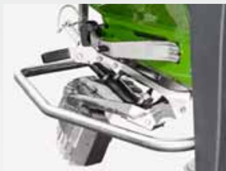
No ZA-V com acionamento hidráulico da corredeira, o sistema de distribuição em bordadura Limiter V operado hidráulicamente está disponível para distribuição em bordadura, limite e vala. A profundidade de descida recomendada do Limiter V é definida por meio de um parafuso antes da distribuição, dependendo da situação limite.
