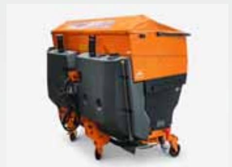
Com o equipamento opcional de sal de amortecimento para sal de amortecimento FS30 com 30% de teor de salmoura, uma bomba hidráulica de salmoura garante um fornecimento de salmoura precisamente ajustável a partir dos dois tanques de plástico de 250 L.
