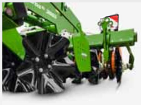
O X-Cutter-Disc com perfil ondulado é usado para preparação do solo muito raso. O novo disco especial tem um diâmetro de 480 mm para uma alta velocidade periférica e funciona de forma ideal em profundidades de trabalho de 2 a 8 cm.
