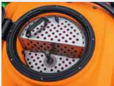
A dosagem segura e precisa de produtos de proteção fitossanitária e outros aditivos é garantida pelo grande dispositivo de indução sob a tampa da cúpula grande e fácil de abrir.
