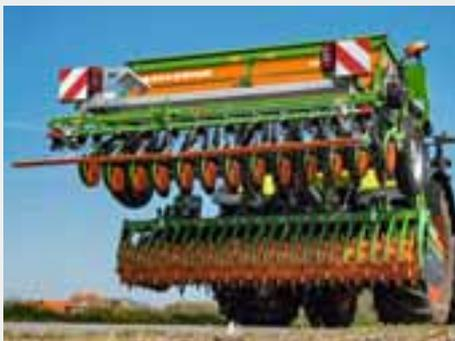
Com o sistema Huckepack, a semeadora é puxada para frente durante o transporte ou na cabeceira para reduzir a força de elevação requerida.
