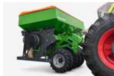
A AMAZONE também oferece o FTender com o compactador de pneus dianteiro T-Pack F. Especialmente na sementeira, o FTender mostra seus pontos fortes como depósito de sementes com um compactador de pneus dianteiro autodirecional e garante uma boa recompactação entre os rastros do trator.
