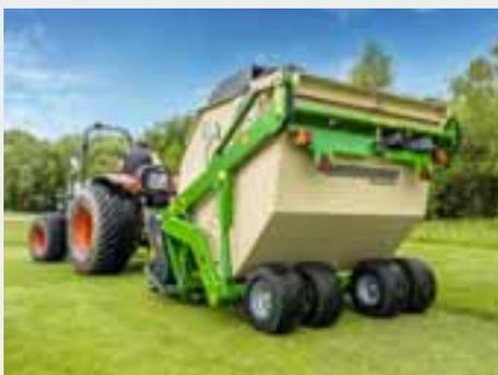
A altura de corte é ajustada individualmente para a respectiva aplicação. A robusta segadeira com malho atinge a qualidade de corte e o desempenho de coleta ideais, mesmo em condições úmidas e molhadas.
