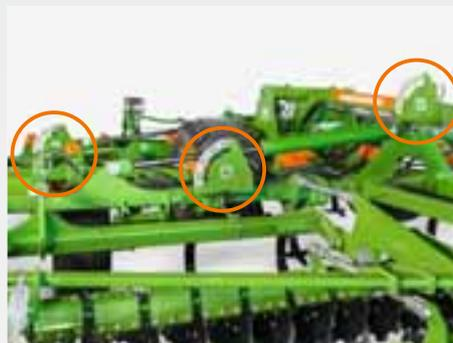
Tanto a grade de discos anteposta quanto o campo de hastes e a unidade de nivelamento podem ser equipados com ajuste hidráulico da profundidade de trabalho. As configurações são claramente visíveis do banco do trator por meio de três grandes escalas.
