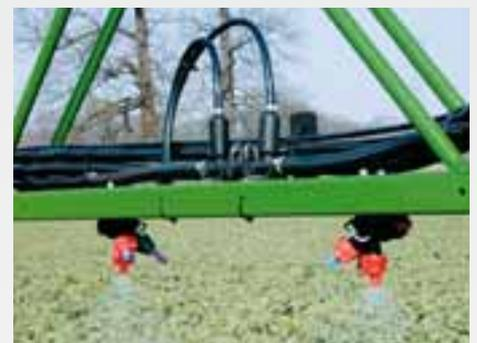
Com o sistema de circulação de pressão (DUS) para todos os pulverizadores AMAZONE, a concentração de líquido pulverizável é sempre constante até o bico. Ao limpar, enxágue com água limpa até o bico.
