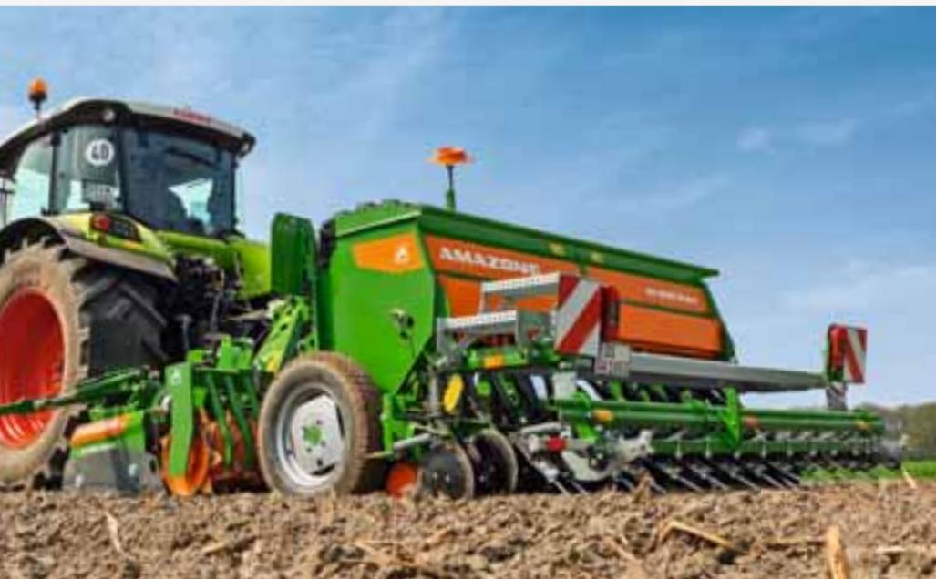
D9 3000 Super com raspadeira exata em combinação com grade rotativa e rolo packer dentado
