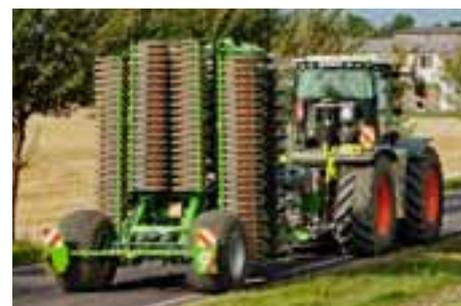
Transporte seguro em estrada com uma largura de transporte inferior a 3 m graças à estrutura da máquina articulável hidráulica como padrão.
