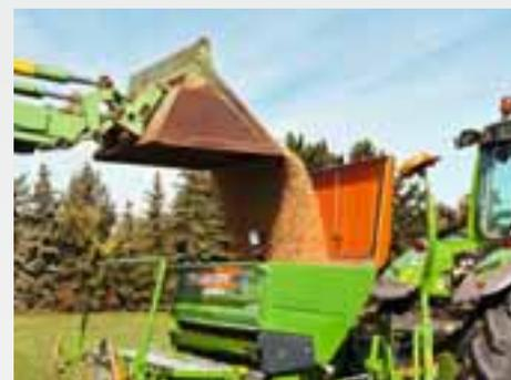
Uma plataforma de carregamento particularmente ampla, acessível por meio de degraus articuláveis, facilita o enchimento da semeadora. A abertura de enchimento muito generosa permite um processo de enchimento rápido e sem esforço, mesmo com um saco grande, uma caçamba de carregador frontal ou produtos ensacados.
