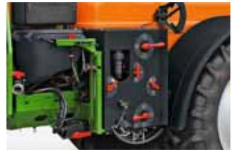
Com a central de comando claramente disposta na parte dianteira esquerda, todas as mudanças de marcha podem ser operadas de forma rápida, fácil e sem erros.
