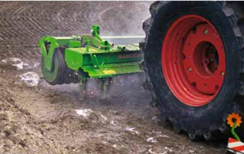
Pista de teste de pedra extrema: A fixação de dentes com mola permite que as hastes da grade rotativa e do cultivador se afastem das pedras.
