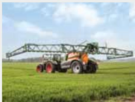
Com o sistema de dobramento Profi ou Flex, todas as funções hidráulicas, inclusive o dobramento unilateral, podem ser executadas de forma confiável e fácil a partir da cabine do trator por meio do terminal ISOBUS.
