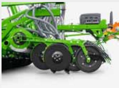
A profundidade de sementeira e a pressão da haste são definidas de maneira fácil para o usuário por meio do terminal ISOBUS. Não há necessidade de inserir cliques ou girar as manivelas.
