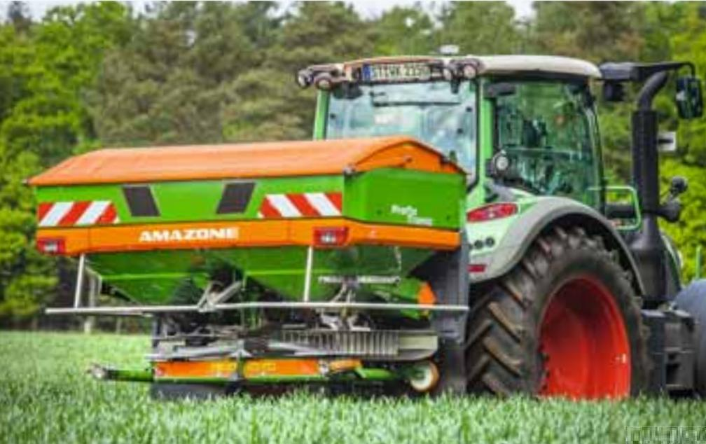
Distribuidor com célula de pesagem ZA-V 2000 Profis Tronic com Limiter V<sup>+</sup>
