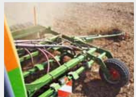
O depósito de sementes da Cayena tem 3600 L ou 4000 L e tem um design compacto. Isso permite uma visão clara das hastes TineTeC em uso. A abertura de superfície total do tanque permite um enchimento rápido e fácil.
