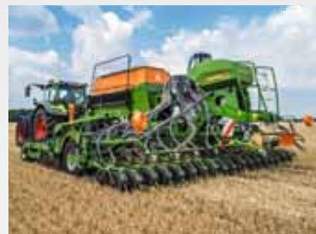
A GreenDrill 501, com capacidade de depósito de 500 L, é usada para semeadura de cultivos de cobertura, sementes finas, culturas secundárias e fertilizantes em combinação com o sistema de preparação do solo rebocado AMAZONE ou com a combinação de semeadoras Cirrus.
