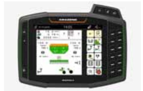
O terminal ISOBUS controla todas as funções importantes da Cirrus. Isso inclui funções de trabalho, bem como opções funcionais para configurar a máquina como, por exemplo, a calibração.
