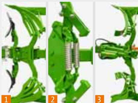
Há uma opção de três sistemas diferentes de proteção contra sobrecarga. Uma versão mecânica usando parafusos de cisalhamento (1), uma versão semiautomática usando molas espirais (2) ou uma versão hidráulica totalmente automática (3).
