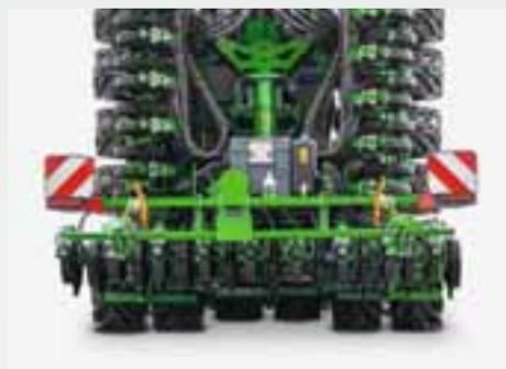
Mesmo em uma velocidade de transporte de 40 km/h, a máquina é caracterizada pela alta estabilidade de condução. Isso é possível porque a máquina funciona com apenas 4 rodas de todo o compactador de pneus.
