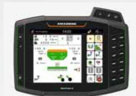
O FTender é controlado via ISOBUS. Isso permite que o tanque montado frontal seja operado de forma fácil, intuitiva e com todos os benefícios da comunicação ISOBUS.
