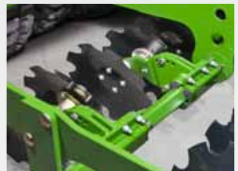
O transportador de discos com discos especialmente angulados proporciona um leito de sementes perfeitamente cultivado e nivelado. A profundidade de preparação pode ser ajustada hidráulica durante a operação.
