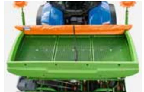
A abertura do tanque se estende por generosos 2,43 m x 0,91 m, de modo que a Centaya pode ser facilmente abastecida com um saco grande ou uma caçamba de carregador frontal. Ao encher sacos, as grades de peneira no depósito de sementes podem ser usadas como depósito de sacos.
