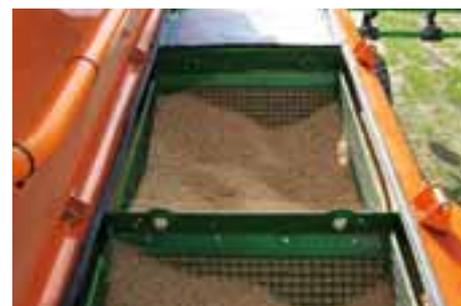
A Citan 12001-C e 15001-C oferece a opção de colocar fertilizante no sulco de sementeira junto com a semente. Portanto, o tanque é dividido em três seções e pode ser carregado com até três produtos diferentes. Se não for necessário dividir o tanque, ele será preenchido completamente com um tipo de semente. A dosagem é realizada por meio de engrenagens Vario, cada uma das quais pode dosar quantidades de sementes de 1,5 a 400 kg/ha.
