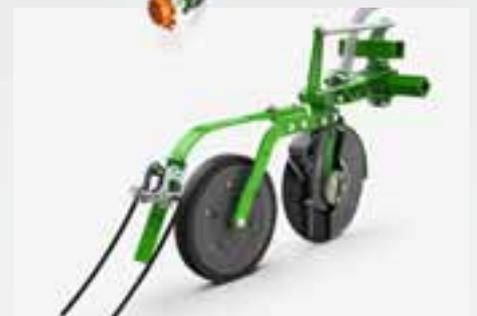
O Avant 02 pode ser equipado com discos TwinTeC e espaçamentos entre linhas opcionalmente de 12,5 cm ou 15 cm. A profundidade de semeadura pode ser definida centralmente na máquina e é mantida com precisão graças aos rolos guia de profundidade.
