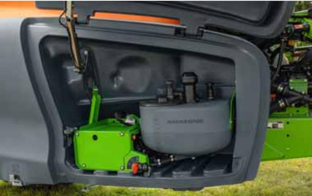
Equipamento DirectInject com tanque de 50 L e unidade de bomba no compartimento de armazenamento do UX 01 Super
