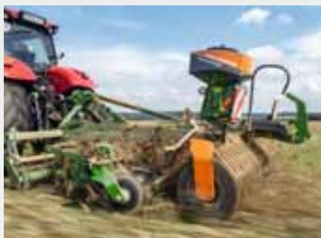
Na área de dosagem, abaixo do depósito de sementes, há uma barra de acionamento, que é equipada com rodas de semeadura normais ou finas, dependendo do tipo de semente e das quantidades a distribuir. A barra de acionamento e a turbina são acionadas por um motor elétrico ou hidráulico.
