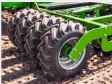
Com o compactador lateral T-Pack S para a Cirrus 4003-2/2C/2CC e 6003-2/2C/2CC, o solo pode ser pressionado para baixo na frente do corpo de discos em condições leves a médias ou após a aragem, proporcionando uma recompactação adicional.
