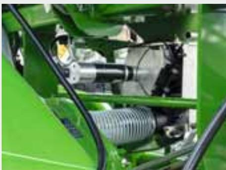
A semente é dosada por meio da unidade dosadora acionada eletricamente abaixo do depósito de sementes. Vários rolos dosadores, que podem ser trocados de forma rápida e fácil, estão disponíveis para diferentes sementes.
