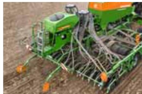
A sementeira de grãos finos sobre rotativas universal pneumática GreenDrill para a combinação de sementeiras Cirrus permite que o usuário aplique um meio adicional, seja semente para cultura secundária ou granulado para lesmas, na superfície do solo durante a semeadura.
