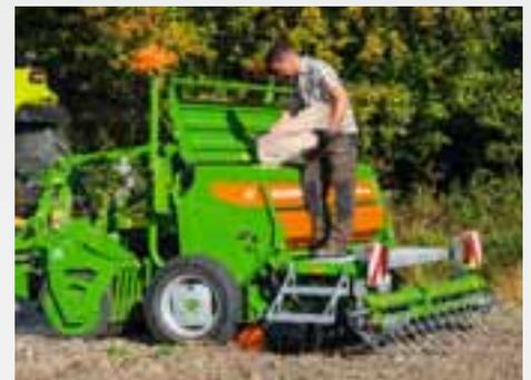
Uma plataforma de carregamento particularmente ampla, acessível por meio de degraus articuláveis, facilita o enchimento da semeadora. A abertura de enchimento muito generosa permite um enchimento rápido e sem esforço.
