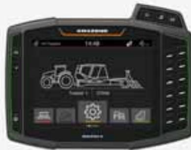
Com o acionamento elétrico de dosagem opcional em conjunto com o controle e a documentação ISOBUS de última geração, todos os motores de dosagem podem ser calibrados independentemente uns dos outros e controlados durante a condução.
