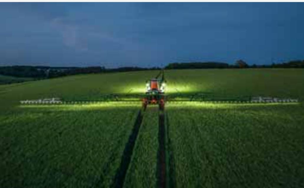
Em conjunto com a iluminação de trabalho de LED e a iluminação de bico individual opcional na barra, a noite se torna dia
