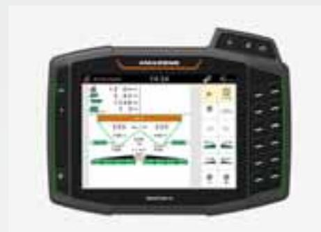
Com o terminal ISOBUS prático e bem definido do terminal de controle AmaTron 4, é necessário apenas mais um terminal para operar as várias funções do fertilizante. Todos os dados relevantes são exibidos claramente.
