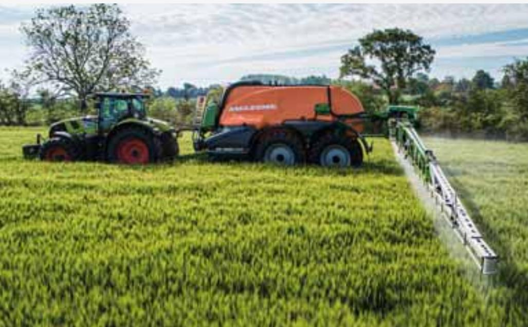
Pulverizador rebocado UX 11201 com barra Super-L2 de 40 m
