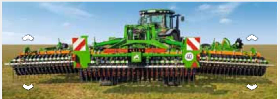
A adaptação perfeita do solo também é obtida com o ContourFrame. Os cilindros hidráulicos dos segmentos externos são pré-tensionados por acumuladores hidráulicos e movidos para a posição flutuante, de modo que cada um dos três segmentos possa se ajustar para cima e para baixo em relação ao solo. Isso significa que a máquina se adapta muito bem aos contornos do terreno, mesmo em terrenos acidentados.
