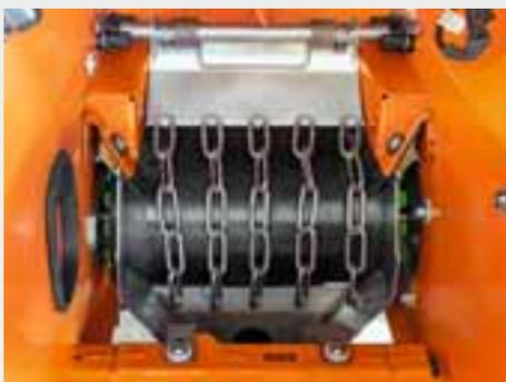
Um recurso exclusivo do equipamento é o transporte acionado hidráulicamente do produto de distribuição sobre a esteira inferior. Graças à ampla superfície de contato, o produto de distribuição é continuamente transportado na direção de uma calha, por onde chega aos discos dispersores.
