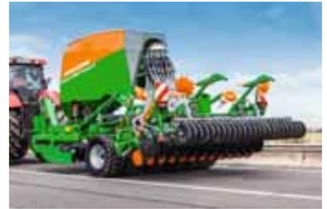
Com os pneus matrix desenvolvidos para a Cirrus, a máquina, que está completamente cheia de sementes, pode ser conduzida com segurança na estrada a 40 km/h. Isso está 100% em conformidade com as normas de tráfego rodoviário. A articulação na barra inferior permite que a Cirrus seja extremamente manobrável, por exemplo, na cabeceira.
