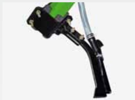
A haste TineTeC forma um sulco de semeadura limpo e livre de matéria orgânica. O design extremamente estreito significa que pouca terra é movida. Vantagens: a água é economizada e a potência de tração da máquina é minimizada. A haste TineTeC também está disponível em uma versão HD para uma vida útil ainda mais longa.
