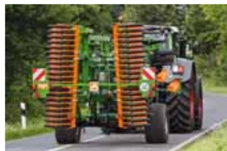
O chassi central proporciona à máquina alta manobrabilidade na estrada e no campo. Dependendo da legislação nacional de autorização e do equipamento da máquina, é possível uma velocidade de transporte de até 40 km/h.
