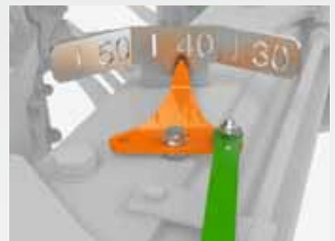
Em todos os arados V Tyrok, as larguras de trabalho são ajustadas de forma contínua e hidráulica a partir do trator. Um visor claramente visível, composto por uma escala e um ponteiro, informa o operador sobre as larguras de trabalho ajustadas.
