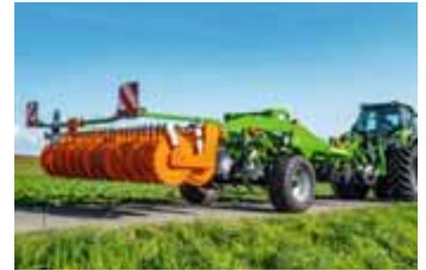
O chassi interno TX do Ceus-2TX e do Ceus-TX permite alta manobrabilidade na cabeça e transporte confortável em estrada. Dependendo das restrições do país, o Ceus-2TX e o Ceus-TX também podem ser aprovados para transporte rápido em estrada a 40 km/h.
