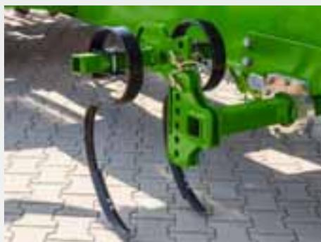
Estão disponíveis descompactadores de rastros opcionais para uso em solos descompactados ou não recompactados. As trilhas das rodas são quebradas e niveladas. O controle hidráulico permite a inserção e a remoção automática na cabeceira ou para dobrar durante o transporte.
