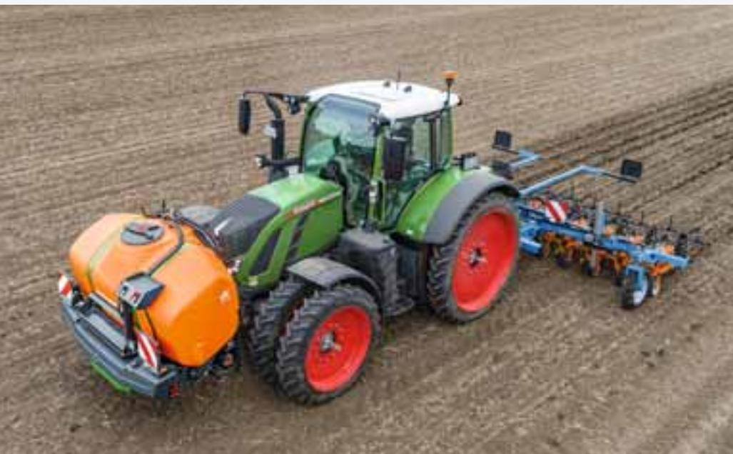
Tanque frontal FT-P 1502 em uso com uma máquina de sachar SCHMOTZER para pulverização em faixa
