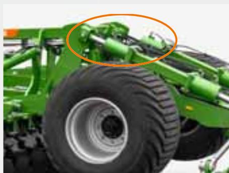
A inclinação do Certos pode ser ajustada, se ele for equipado com uma correia superior hidráulica. Se a máquina tiver uma tração diagonal, isso pode ser facilmente equalizado a partir do banco do motorista na cabine do trator.
