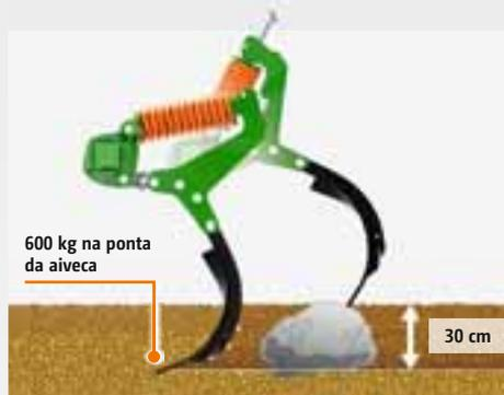
As hastas C-Mix-Super, juntamente com a proteção contra sobrecarga, proporcionam um padrão de trabalho perfeito, mesmo em solos profundos. A força de acionamento da proteção contra sobrecarga da mola de compressão das hastas C-Mix-Super é superior a 600 kg e tem um curso de elevação de 30 cm.
