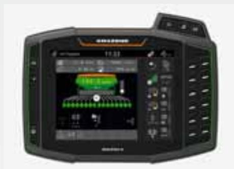
O terminal ISOBUS AmaTron 4 da AMAZONE ou qualquer terminal ISOBUS de outro fabricante pode ser usado para controlar e documentar a combinação de semeadoras.
