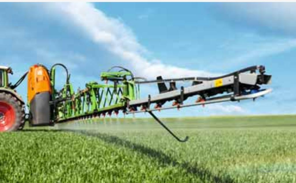
Pulverizador montado UF 2002 com barra Super-S2 de 30 m
