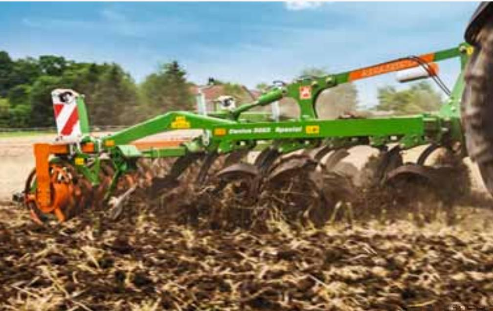
Cenius 3003 Special, 3 m com rolo de anéis metálicos
