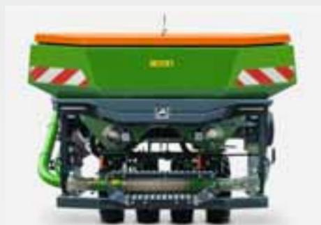
FTender 2200-C com tanque dividido em uma proporção de 50:50 para combinar semente e fertilizante ou uma segunda semente.
