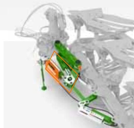
O AutoAdapt ajusta automaticamente o sulco da frente quando a largura total de trabalho é alterada. Graças ao paralelogramo e à conexão hidráulica entre as larguras de trabalho e os cilindros do sulco da frente, uma conexão precisa é possível em todas as condições.
