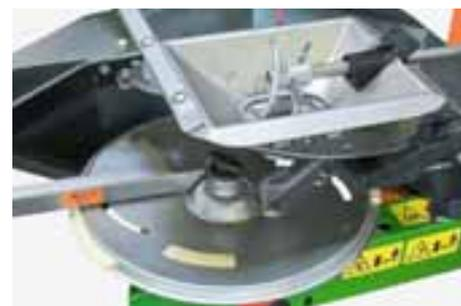
A pintura catódica por imersão de alta qualidade (padrão automotivo) para o tanque e a estrutura e o mecanismo de distribuição feito inteiramente de aço inoxidável garantem uma longa vida útil e um alto valor de revenda.
