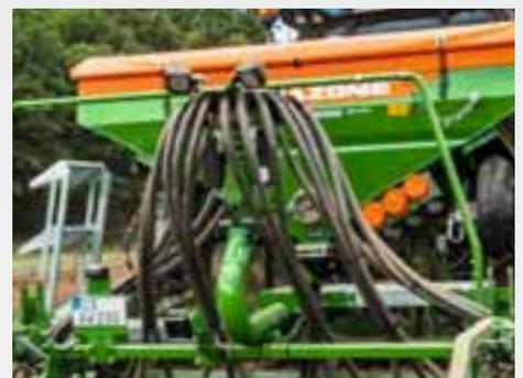
A torre de distribuição de segmentos da Centaya Special está localizado atrás do depósito de sementes e diretamente acima das linhas de semeadura. Essa disposição garante curtas linhas de transporte para a semente.
