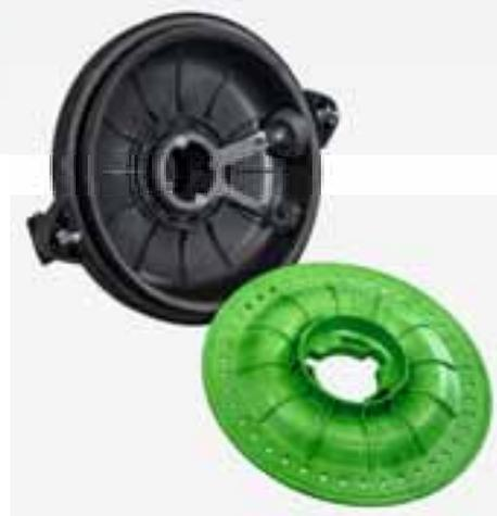
A separação precisa está no centro da Precea. A dosagem é feita por pressurização. A semente e toda a dosagem são pressurizadas pela turbina. Três raspadores garantem que os grãos em excesso sejam raspados para evitar duplicação. Isso resulta em uma separação muito precisa, mesmo em altas velocidades de condução de até 15 km/h.
