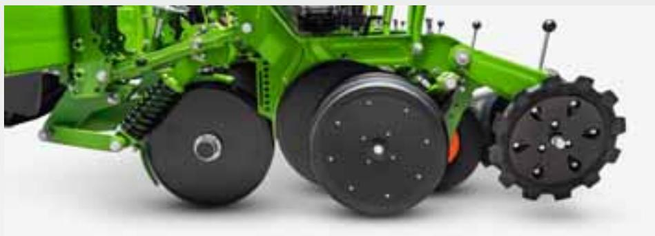
A relha para semeadura sobre resteva PreTeC completa é guiada com segurança por dois grandes rolos de suporte. O solo é aberto por meio de uma unidade de disco duplo, incluindo sulcador. Após a semente ter sido fixada no solo pelo rolo captador, os rolos de pressão em V seguem para fechar o sulco novamente. A unidade de hastes completa é facilmente acessível. O uso de rolamentos e buchas bem vedados e livres de manutenção minimiza os requisitos de manutenção.
