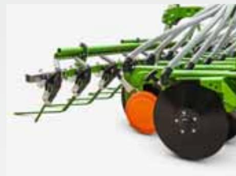
A haste RoTeC pode ser usada para semear com a máxima precisão, independentemente das condições do solo e do clima. A profundidade de sementeira é definida rapidamente na haste. A pressão da haste pode ser convenientemente alterada hidráulica-mente por meio do terminal ISOBUS.
