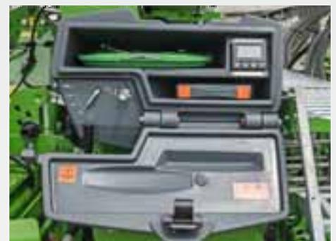
O SmartCenter no lado esquerdo da máquina permite que a Centaya Super seja convenientemente calibrada e ajustada enquanto se está ao lado da máquina. As balanças digitais e um balde dobrável são alojados diretamente na máquina em uma caixa de transporte.
