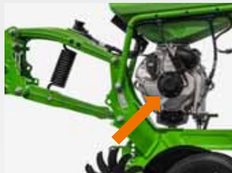
A semeadora de precisão **Precea Super** está equipada com o acionamento elétrico ElectricDrive, no qual cada separação de sobrepessão de funcionamento é acionada separadamente por um motor elétrico. Com o acionamento elétrico, é possível atingir velocidades de condução de até 15 km/h.
