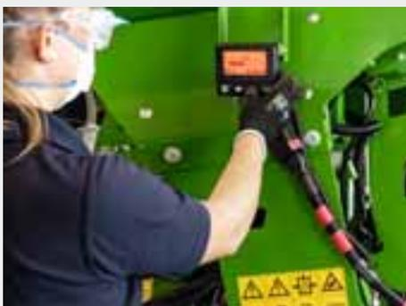
O TwinTerminal é montado diretamente na semeadora, próximo à unidade dosadora, usando uma base magnética. Essa posição tem uma vantagem decisiva: o operador agora pode operar e inserir dados para calibração diretamente na máquina.
