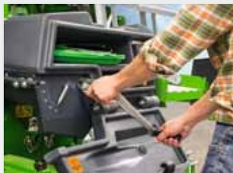
A pressão na haste TwinTeC e a profundidade de deposição dos grãos no SmartCentre também são definidas independentemente uma da outra. Graças ao uso da ferramenta de operação universal, essas configurações centrais também podem ser feitas de forma rápida e fácil.
