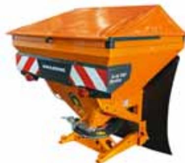
O distribuidor para serviços de inverno E+S Hydro 751 está equipado com um tanque de 750 L com ponta do tanque em aço inoxidável, acionamento hidráulico dos discos distribuidores dispersores e regulação de quantidade dependente da velocidade
