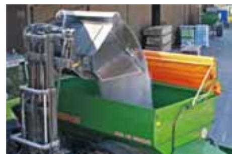
Os pneus de grandes dimensões reduzem a pressão sobre o solo. O tanque é enchido facilmente a partir do silo ou com a pá carregadora.
