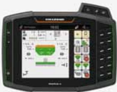
O terminal ISOBUS AmaTron 4 da AMAZONE ou qualquer terminal ISOBUS de outro fabricante pode ser usado para controlar a Primera com acionamento elétrico.
