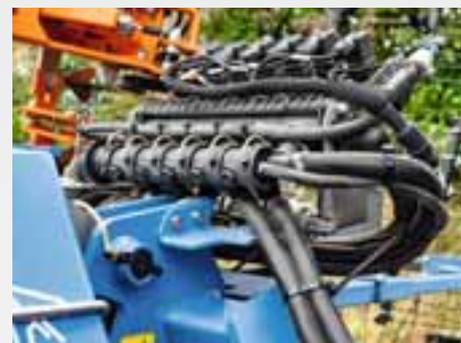
Um encaixe de seção com 2 a 6 seções pode ser instalado permanentemente em cada um dos acessórios. Máquinas diferentes podem ser equipadas com um encaixe de seção fixa por meio de pontos de separação na frente do encaixe de seção.
