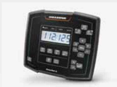
O computador de controle EasySet 2 oferece a opção de regulação automática de quantidade em diferentes velocidades de condução. As aberturas de saída são ajustadas automaticamente, definindo as posições da corredeira para que a quantidade a distribuir permaneça sempre a mesma.
