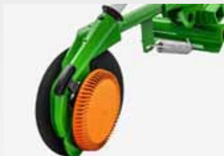
O Avant 02 pode ser equipado com discos RoTeC e espaçamentos entre linhas de 12,5 cm. A profundidade de semeadura pode ser definida diretamente nos discos em 3 posições diferentes.
