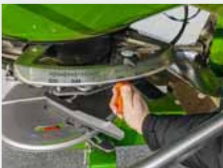
A AMAZONE oferece o ZA-V com acionamento hidráulico ou elétrico da corredeira. O equipamento hidráulico permite a operação direta das corredeiras por meio de duas unidades de controle hidráulico de dupla ação no trator.
