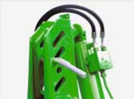
Todas as torres montadas têm orifícios oblongos para a fixação do terceiro ponto. Se isso for posicionado no orifício oblongo, o trator com arado pode se adaptar de forma ideal a terrenos irregulares e, assim, manter a profundidade de trabalho desejada.
