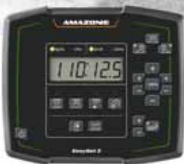
Computador de controle EasySet para operação elétrica da corredeira ou do limitador de largura de distribuição
