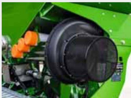
O acionamento hidráulico da turbina garante um ajuste conveniente da velocidade da turbina. A velocidade da turbina é ajustada de forma conveniente e independente da velocidade do motor, de modo que a velocidade possa sempre funcionar de forma constante e no nível ideal.
