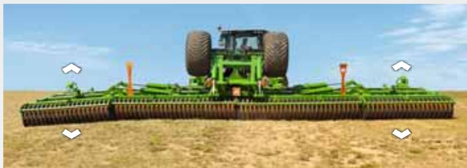
A Catros<sup>+</sup> 12003-2TS está equipada com discos serrilhados com diâmetro de 510 mm, permitindo profundidades de trabalho de 5 a 14 cm. O ContourFrame da Catros<sup>+</sup> 12003-2TS é dividido em quatro segmentos de estrutura, cada um deles montado em rolamentos flutuantes. Assim, o pré-tensionamento hidráulico permite a adaptação individual do solo para cada um dos 4 segmentos.
