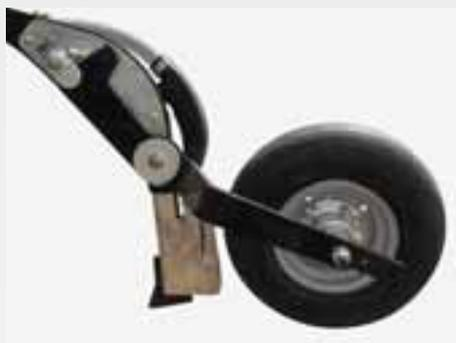
As pontas das hastes são equipadas com um revestimento de metal duro para uma longa vida útil. O conveniente ajuste de profundidade permite que a profundidade de deposição seja alterada em um piscar de olhos.
