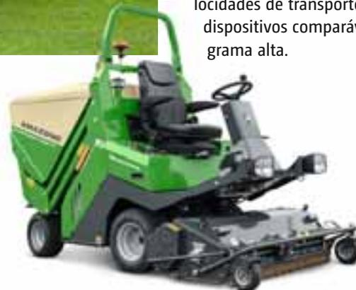
Profihopper 4WDi SmartLine com tração dianteira e diâmetro de viragem 0
