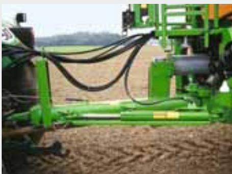
Uma barra de reboque de seguimento das rodadas, barra universal, barra de tração de engate ou barra de tração com direção hidráulica evita esmagamentos.
