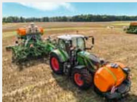
O FT-P também pode ser usado para aplicação de fertilizante líquido com semeadura simultânea.
