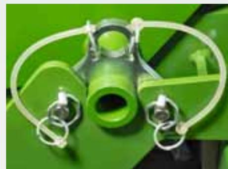
Três pontos de acoplamento de fácil acesso do sistema de acoplamento rápido QuickLink garantem um acoplamento e desacoplamento seguros, rápidos e sem ferramentas.
