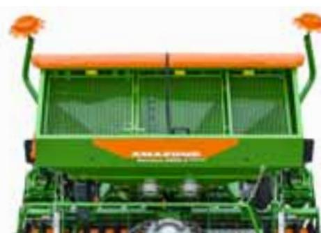
Centaya 4000-C Special com um tanque de duas câmaras em uma proporção de 70:30. Isso significa que dois produtos a aplicar diferentes podem ser dosados separadamente.
