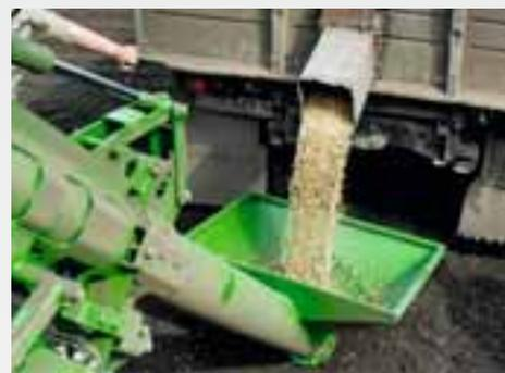
Para encher o tanque da Primera DMC com semente e fertilizante, a AMAZONE oferece um sem-fim de enchimento acionado hidráulicamente. Isso permite que os tempos de enchimento sejam reduzidos para até 15 minutos e que a produção da máquina seja aumentada de acordo.
