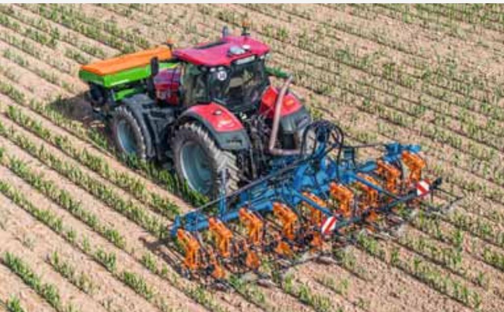
Venterra 2K em combinação com o tanque montado frontal FTender para fertilização de fileiras
