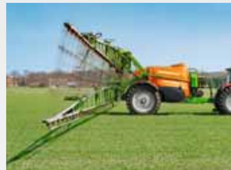
A suspensão de paralelograma do UX permite alcançar alturas de pulverização de 0,5 m a 2,5 m. A posição da barra é muito boa em todas as direções de movimento graças à coordenação otimizada dos dispositivos de amortecimento.
