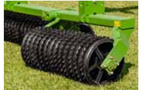
O rolo destorroador está disponível em duas larguras de trabalho com anéis Cambridge. Os segmentos de rolos individuais com seus anéis intermediários livremente móveis são montados independentemente uns dos outros para garantir excelente autolimpeza e adaptação do solo em todas as larguras de trabalho.
