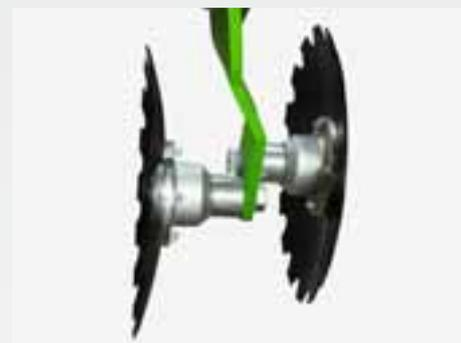
A unidade de grade de discos de 2 fileiras solta, esmigalha e nivela o leito de sementes antes da deposição da semente. Com um ângulo de 14° na carreira de discos dianteira e 12° na carreira de discos traseira, os discos CombiDisc dispostos de forma inclinada. Esse ângulo garante o nivelamento ideal do leito de sementes.
