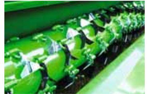
O rotor de corte exato SmartCut® com excelente qualidade de coleta está disponível para as séries Grasshopper e Profihopper. A característica marcante do rotor é um alinhamento especial da lâmina em forma de V, que resulta em menor consumo de energia e emissões de ruído.
