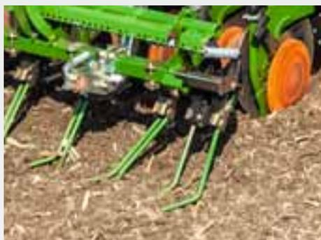
Os discos RoTeC pro têm um ponto de apoio da haste extra estável para levar em conta o aumento da velocidade de semeadura. A raspadeira exata S garante uma boa cobertura das sementes, mesmo em condições operacionais mais difíceis e com grandes quantidades de palha.
