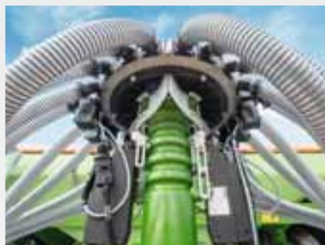
A torre de distribuição de segmentos está localizado atrás do depósito de sementes e diretamente acima das linhas. A Centaya Super também pode ser desligada em um lado por meio do cabeçote distribuidor de segmentos, por exemplo, para corredores de passagem assimétricos na borda do campo.
