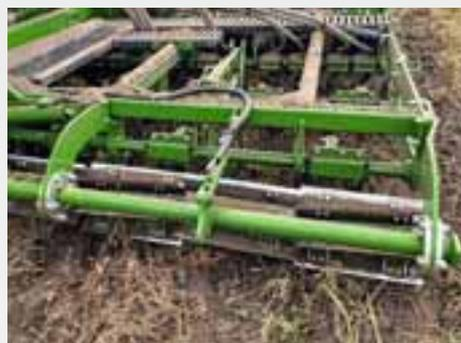
A AMAZONE oferece um rolo faca como ferramenta anteposta para a combinação de sementeiras de arrasto Cirrus 6003-2. O rolo faca garante um esmigalhamento adicional de solos com torrões e a trituração intensiva dos resíduos da colheita.
