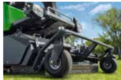
A altura de corte do Profihopper 1500 SmartLine pode ser ajustada de forma variável de 0 a 90 mm usando a ferramenta de operação posicionada na plataforma do cortador. Toda a plataforma do cortador de grama é giratória, de modo que nenhuma parte inferior prejudica a imagem de trabalho.
