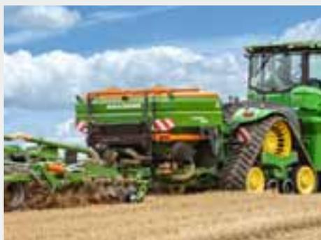
O XTender oferece um acessório de baixo centro de gravidade por meio da ligação de 3 pontos (cat. 3/4N) ao trator. A máquina de arrasto também é acoplada ao XTender por meio de um engate de ligação inferior padronizado nas categorias 3 ou 4N.
