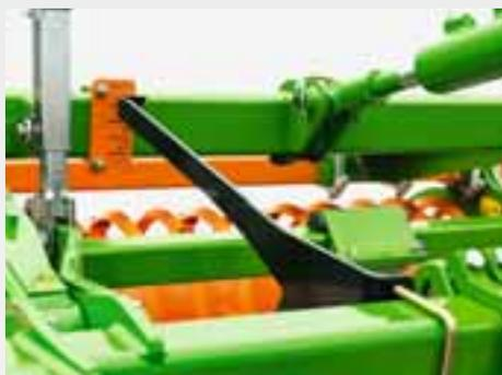
A regulação da profundidade é feita mecanicamente, de série, por meio de um terceiro ponto ou, de forma muito conveniente, hidráulicamente a partir do banco do trator. Isso permite que você reaja a diferentes condições do solo enquanto dirige.
