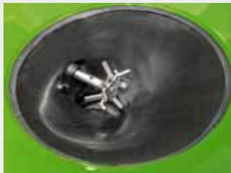
O agitador mecânico em estrela do ZA-V fica diretamente acima da abertura de saída baixa e, assim, garante um fluxo permanente e contínuo de fertilizante em todas as quantidades a distribuir. Com apenas 45 rpm, ele é particularmente suave com o fertilizante.
