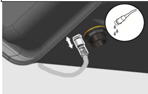
23. Far defluire l'acqua rimasta nello scarico del filtro per i tubi attraverso il rubinetto di scarico.
