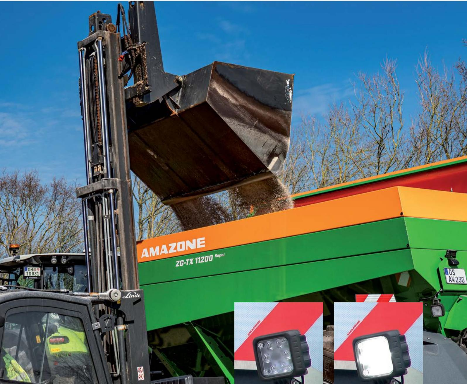
Durante il riempimento, il livello di riempimento è indicato dal lampeggiamento delle luci di lavoro. Se le luci di lavoro restano accese in modo fisso, è stato raggiunto il livello di riempimento desiderato. Non è più necessaria una seconda persona né è necessario scendere spesso dal trattore per controllare.
