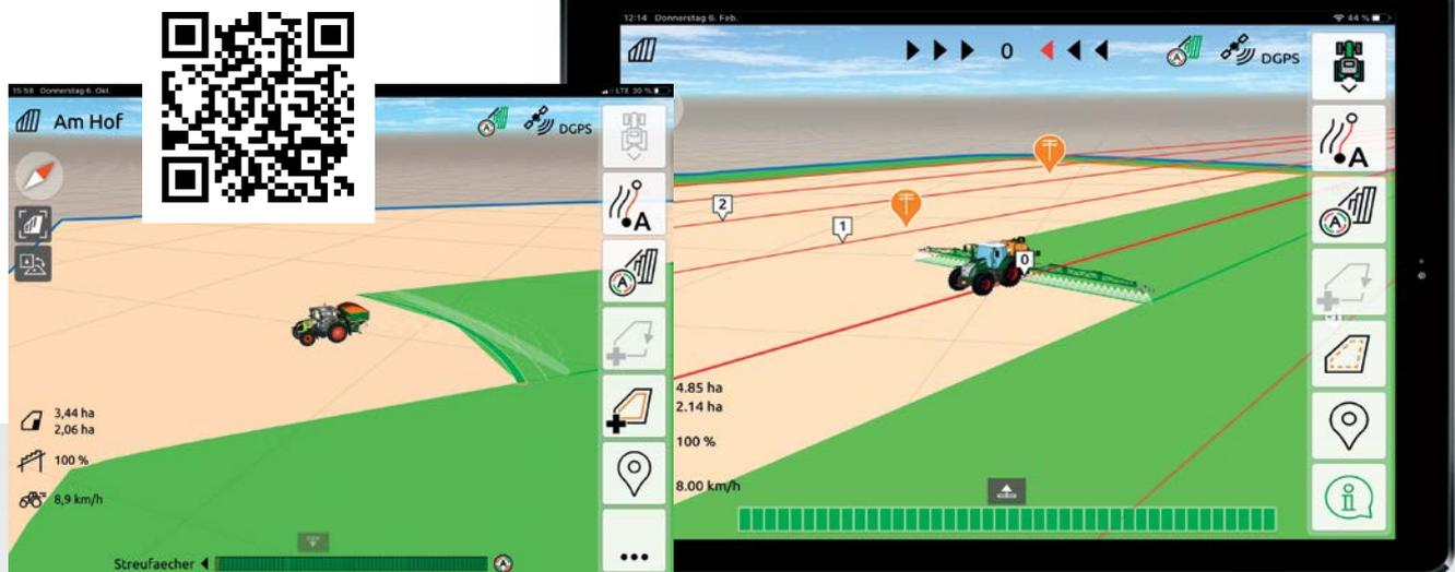
Viste mappa alternative con AmaTron Twin: visualizzazione chiara della macchina e delle sue larghezze parziali, nonché pulsanti sul lato destro del dispositivo mobile.
