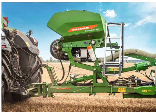
GreenDrill 501: para todas las máquinas remolcadas con una capacidad del depósito de 500 l y una turbina hidráulica
