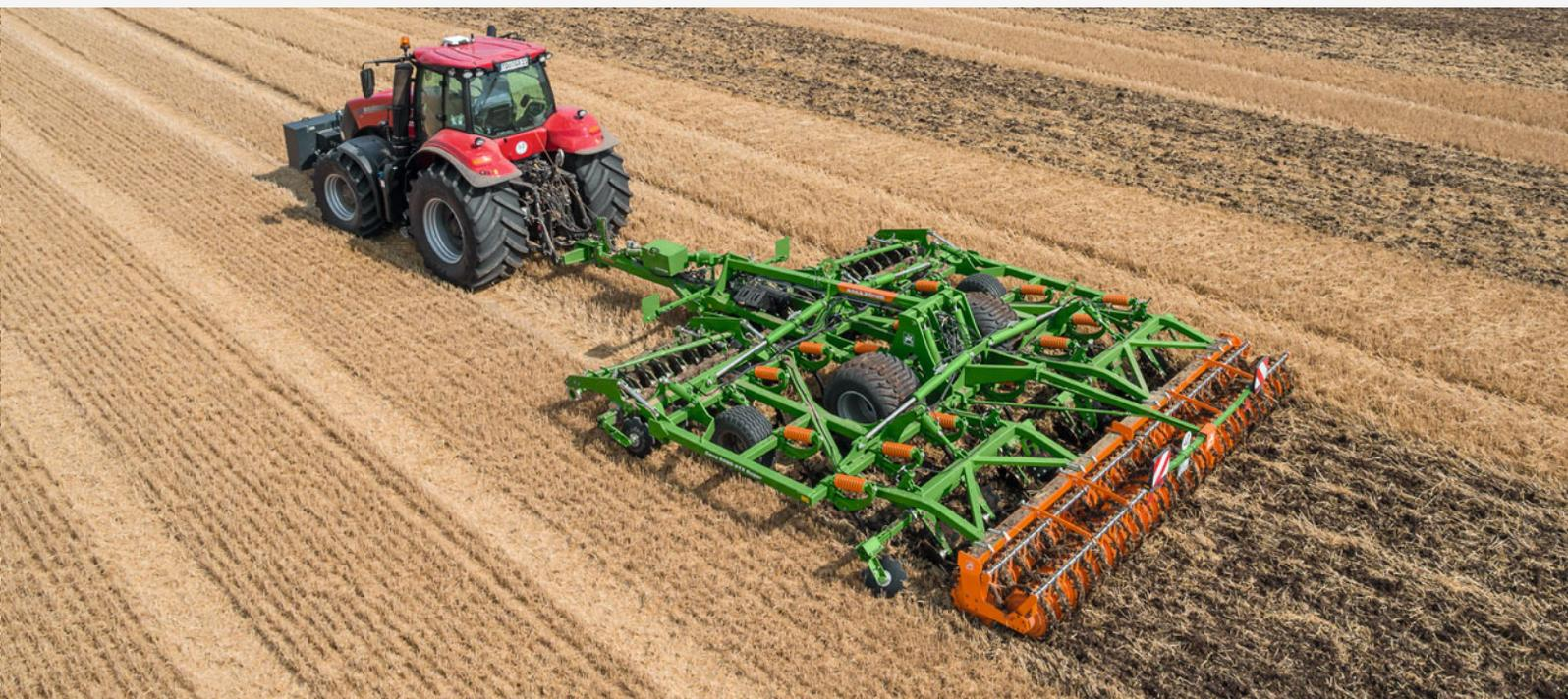
El Ceus-2TX, con anchos de trabajo de 4 m a 7 m, está pensado para explotaciones con grandes terrenos de cultivo pero periodos de uso cortos. Con la combinación de cuerpo de discos y segmento de púas, el Ceus ofrece el máximo rendimiento en todas las condiciones. En función del ancho de trabajo, el Ceus-2TX requiere tractores a partir de 200 CV. El bastidor plegado también permite conducir el Ceus de forma cómoda y rápida por carretera.
