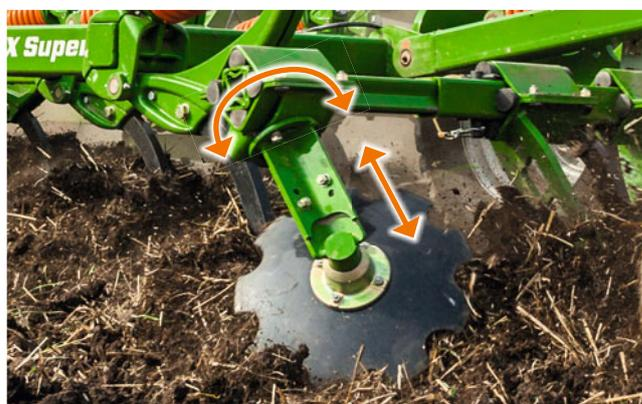
El elemento marginal: ajustable en altura e inclinación de forma independiente
