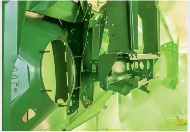
A dupla proteção fornecida pela pintura a pó espessa adicional melhora a proteção contra esforços mecânicos.
