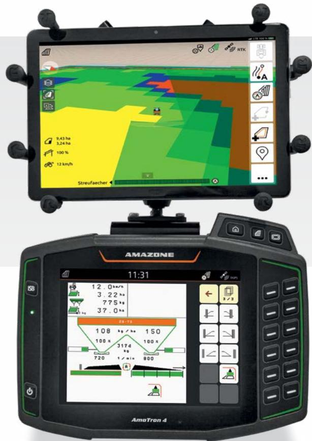
Tudo sempre à vista com o aplicativo AmaTron Twin e o conjunto de suporte para um tablet, para instalação fixa no AmaTron 4
