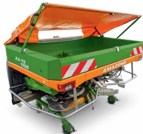
Cubierta de lona abatible, en posición de mantenimiento, para una fácil limpieza desde el interior
