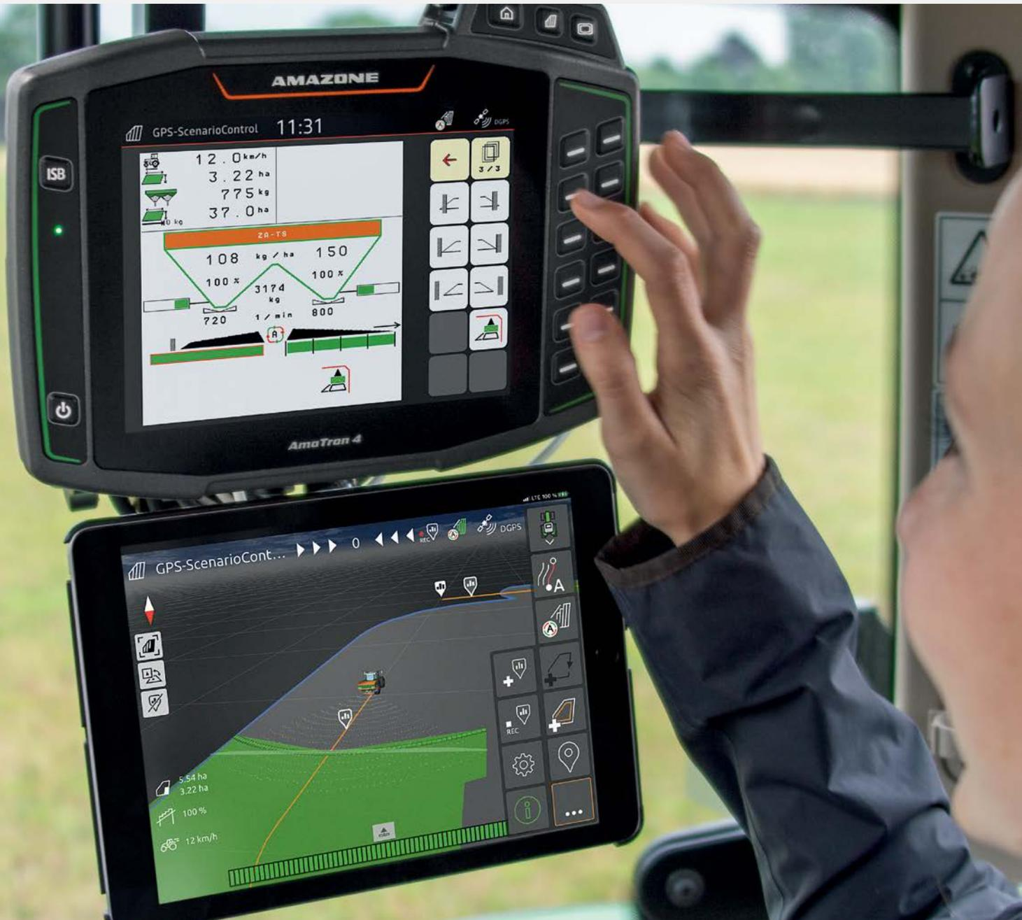
GPS-ScenarioControl se puede utilizar en combinación con el terminal de mando ISOBUS AmaTron 4 y la aplicación AmaTron Twin.
