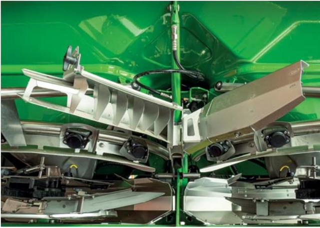
El panel BorderTS está montado en posición central detrás de la esparcidora y se activa hidráulicamente.
