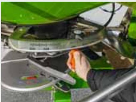
AMAZONE propone lo ZA-V con azionamento idraulico o elettrico della saracinesca. La versione idraulica consente un azionamento diretto delle saracinesche tramite due centraline idrauliche a doppia azione del trattore.
