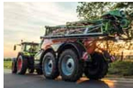
Il telaio con sospensione idro-pneumatica, combinato con la barra di traino ammortizzata, assicura la massima comodità al conducente. I gruppi assale BPW con regolazione del livello di riempimento standard si adattano costantemente alle condizioni del carico.
