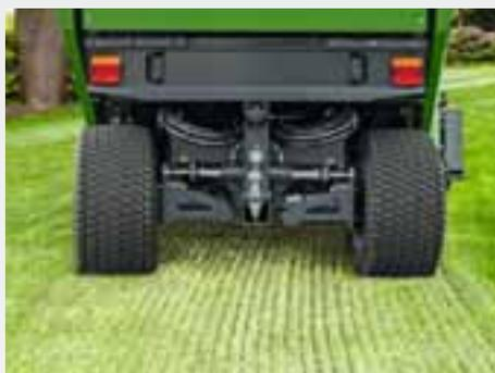
Con Profihopper, è anche possibile effettuare un'ottima scarificazione. Le lame di scarificazione, che possono essere montate in modo rapido e senza utensili, tagliano il tappeto erboso e diradano la superficie del prato. Il feltro erboso viene rimosso, raccolto e nel contempo la superficie viene rullata.
