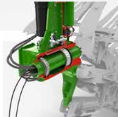
Il perno di rotazione di 130 mm, che è cavo, permette di usare due cuscinetti delle stesse dimensioni, e questo accresce notevolmente la durata.
