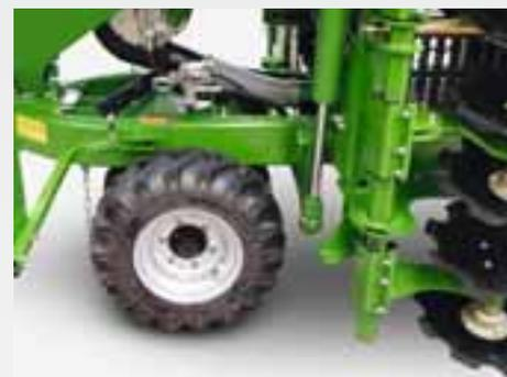
Il sistema di packer anteriori per le Cirrus 4003-2/2C/2CC e 6003-2/2C/2CC può essere completato con il T-Pack IN. Esso è montato al centro della macchina, sotto la barra di traino, e compatta la zona tra le tracce del trattore.
