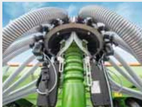
Il fungo distributore a segmenti è disposto dietro la tramoggia della semente, subito sopra i coltri. Tramite il fungo distributore a segmenti è possibile disattivare la Centaya Super anche per metà, ad esempio in caso di piste asimmetriche a bordo campo.
