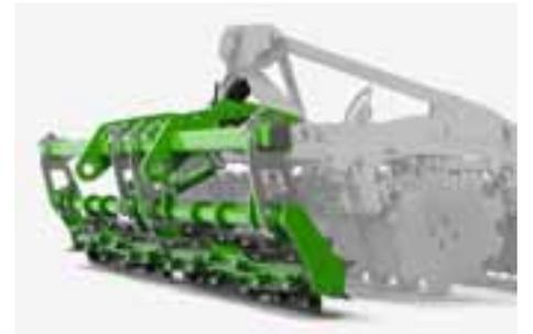
Il rullo a coltelli permette una lavorazione del terreno estremamente superficiale con contemporaneo sminuzzamento delle stoppie, come durante la lavorazione iniziale delle stoppie dopo la colza.
