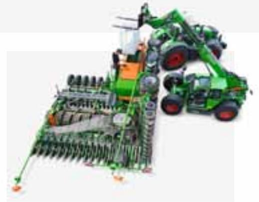
È possibile agevolare notevolmente il caricamento ripiegando mezzo lato durante il caricamento, il che consente di caricare la macchina mediante caricatori telescopici più piccoli.
