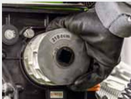
Il sistema di dosaggio è adatto a tutte le sementi e le quantità di seme, fino a 400 kg/ha a 15 km/ora. La conversione da sementi fini a seme normale si svolge in pochi secondi, sostituendo i cilindri dosatori.
