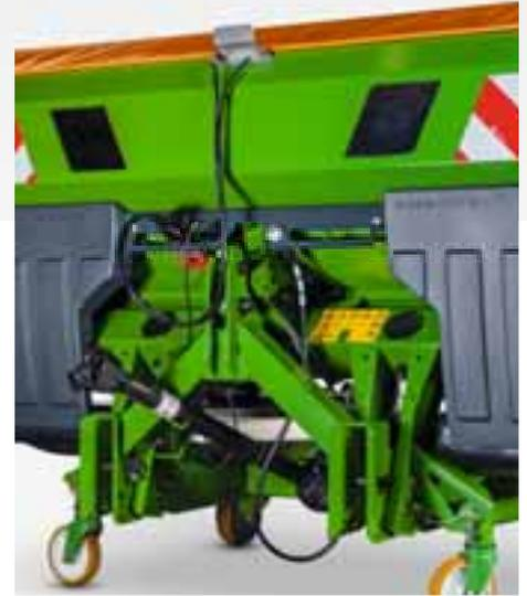
Il sistema di pesatura offre una comodità controllata e una maggiore affidabilità. Con l'ausilio del sistema di pesatura a 200 Hz, esegue la rilevazione online delle caratteristiche del prodotto distribuito con la massima precisione. Compara automaticamente la quantità di prodotto effettivamente distribuita con quella impostata nel terminale.
