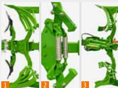
Per la sicurezza contro il sovraccarico si può scegliere fra tre diversi sistemi di protezione contro le pietre. Esistono una variante meccanica tramite bullone di sicurezza (1), una semi-automatica con molle a spirale (2) o una idraulica completamente automatica (3).
