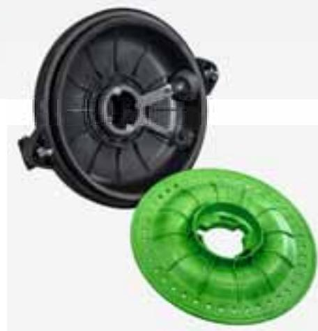
La singolarizzazione esatta è il cuore della Precea. Il dosaggio avviene mediante sovrappressione. Una ventola applica sovrappressione alla semente e all'intero dosatore. Tre raschiatori assicurano la rimozione dei grani in eccesso, in modo da evitare punti doppi. Così è possibile una singolarizzazione molto precisa, anche a velocità elevate (fino a 15 km/h).
