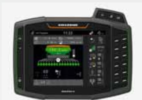
Il controllo e la documentazione della seminatrice combinata possono essere eseguiti dal terminale ISOBUS AmaTron 4 di AMAZONE o da qualsiasi terminale ISOBUS di un altro produttore.
