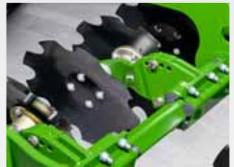
Il porta-dischi combina due dischi in una singola unità che, ammortizzata con elementi elastici in gomma, si adatta al meglio all'andamento del terreno.
