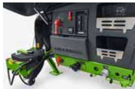
Lo SmartCenter con incorporatore e la centrale di comando completa con i raccordi per il riempimento ad aspirazione e pressione, due scomparti protetti dalla polvere e il pacchetto Comfort opzionale con TwinTerminal 3.0 sono situati direttamente sotto la copertura del lato sinistro.
