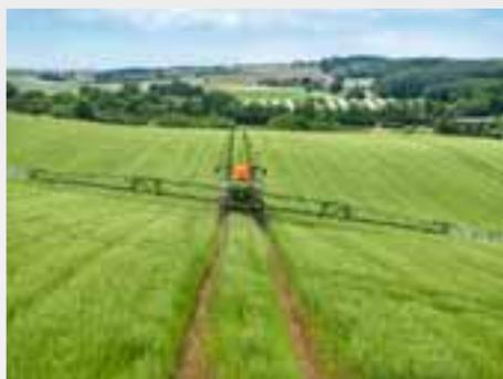
Un altro aspetto saliente è la compensazione integrata delle pendenze. Dei sensori rilevano l'inclinazione del veicolo e la macchina viene mantenuta automaticamente in orizzontale fino ad una certa pendenza.
