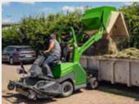
Il disegno del cestello di raccolta permette uno svuotamento a 2,1 m (Profihopper 1250 SmartLine) o 2,5 m (Profihopper 1500 SmartLine) di altezza. Il punto di carico del cestello è stato posizionato molto indietro, dunque anche i cassoni con pareti alte possono essere riempiti al meglio.
