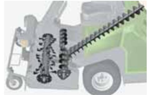
Subito dopo la raccolta, il sistema di raccolta e convogliamento integrato PowerCompactor introduce il prodotto sfalciato in un sistema di convogliamento a co-clea, lo compatta e lo raccoglie nel cestello. Di conseguenza, rispetto ad altri tosaerba il Profihopper presenta una velocità di raccolta maggiore e dunque maggiori velocità di avanzamento, anche nell'erba alta.
