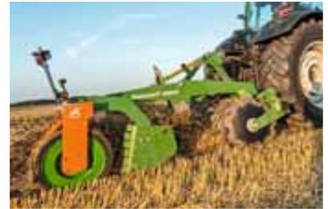
In conseguenza della maggiore distanza tra i dischi, il Catros<sup>XL</sup> si contraddistingue per l'ampio passaggio di materiale. Oltre alla lavorazione delle stoppie, grazie alla struttura aperta del telaio con abbondanza di spazio libero è possibile incorporare senza problemi colture intercalari, stoppie di mais e foglie di patata.
