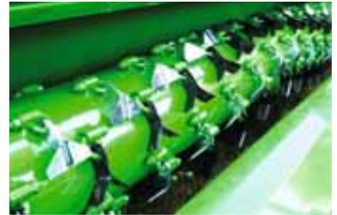
Per la gamma Groundkeeper e Profihopper è disponibile il rotore per taglio di precisione SmartCut® con qualità di raccolta eccezionale. Straordinaria caratteristica del rotore SmartCut è la speciale disposizione a V dei denti, che riduce il consumo di carburante e la rumorosità.
