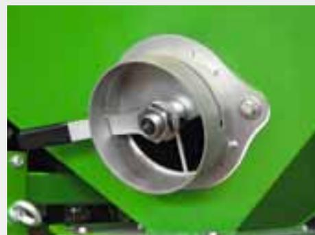
Lo svuotamento dei serbatoi della semente e del concime avviene in modo rapido e semplice grazie al dispositivo di svuotamento rapido opzionale che è applicato alla tramoggia in posizione ben accessibile. Come prolunga si possono fissare tubi HT o di scarico.
