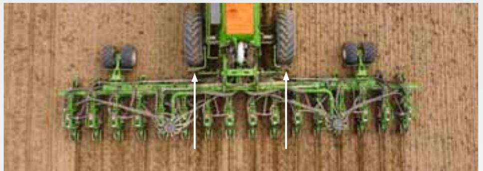
Per il carrello della Precea è disponibile un assale telescopico. Durante il lavoro nel campo, esso permette di regolare la posizione degli pneumatici di grandi dimensioni in modo che le ruote avanzino tra le file di semina, evitando che il terreno venga compattato subito sotto le file. Con le ruote sono completamente rientrate, la Precea-TCC può essere comodamente trasportata su strada con una larghezza complessiva di 3 m.
