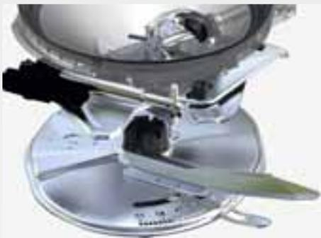
Grazie alla grande apertura della saracinesca dosatrice, la modernissima unità di spargimento dello ZA-V può raggiungere dosi di applicazione fino a 390 kg/min. La conformazione del fondo della tramoggia, che è rastremato verso la saracinesca, impedisce che si fermino residui di fertilizzante e consente una facile pulizia.
