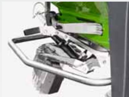
Per effettuare la concimazione di confine, a bordo campo o lungo i fossi con lo ZA-V con azionamento idraulico della saracinesca, è disponibile il sistema di concimazione di confine ad azionamento idraulico Limiter V. Prima dello spargimento viene fissata con un perno l'altezza di lavoro del Limiter V consigliata in base alla situazione del confine.
