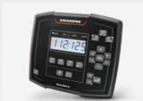
Il computer di comando EasySet 2 permette di regolare automaticamente la quantità di spargimento a velocità di avanzamento variabili. A questo scopo è possibile regolare le dimensioni delle aperture regolando automaticamente la posizione delle paratie in modo tale che la dose di applicazione resti sempre costante.
