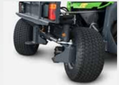
Nel Profihopper 4WDi SmartLine ogni ruota viene azionata con il numero di giri necessario in base alla pressione esercitata sul pedale dell'acceleratore e all'angolo di sterzata. L'utilizzatore potrà trarre vantaggio dalla trazione integrale intelligente soprattutto in condizioni d'impiego difficili.
