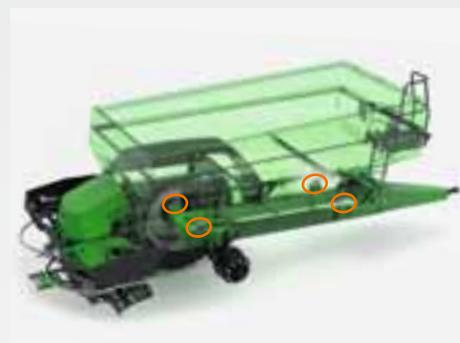
Nel sistema di pesatura Profis, che è integrato nell'intelaiatura, la tramoggia e la sua intelaiatura sono collegate ad un telaio separato per mezzo di quattro celle di pesatura.
