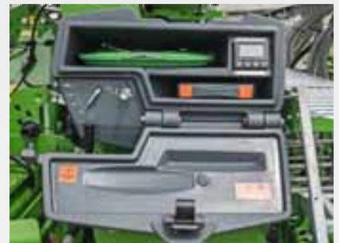
Lo SmartCenter situato sul lato sinistro della macchina consente di calibrare e regolare comodamente la Centaya Super stando in piedi accanto alla stessa. La bilancia digitale e un secchio pieghevole sono situati direttamente sulla macchina in un box di trasporto.
