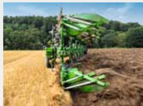
La forma dell'incrocio aperto evita che nella parte inferiore resti intrappolata terra. Ciò significa che l'aratro si solleva ancora più facilmente. Allo stesso tempo, il robusto supporto regolabile dei versoi a strisce fornisce una maggiore stabilità.
