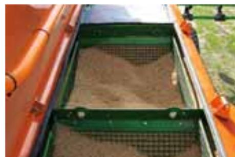
Le Citan 12001-C e 15001-C offrono la possibilità di depositare nel solco, unitamente alla semente, anche il concime. La tramoggia è divisa in tre per questo motivo e può essere riempite con tre prodotti diversi. Se la divisione del serbatoio non è necessaria, è possibile riempirlo completamente con un solo tipo di semente. Il dosaggio viene effettuato tramite riduttori Vario, in grado di dosare da 1,5 a 400 kg/ha.
