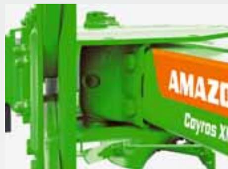
Nel Cayros V, la regolazione continua della larghezza del solco viene effettuata per via idraulica dalla cabina del trattore. Naturalmente, il sistema è talmente evoluto da regolare automaticamente l'allineamento del primo corpo.
