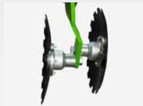
L'erpice a dischi a 2 file dissoda, affina e livella il letto di semina prima della deposizione della semente. I dischi del CombiDisc presentano un'angolatura pronunciata, 14° nella fila di dischi anteriore e 12° in quella posteriore. L'angolatura assicura un livellamento ottimale del letto di semina.
