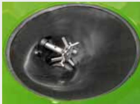
L'agitatore meccanico a stella dello ZA-V è situato direttamente sopra l'apertura nel fondo della tramoggia, garantendo in tal modo un flusso di fertilizzante costante con qualsiasi dose di applicazione. Alla bassissima velocità di 45 giri/min, il dispositivo è molto delicato con il fertilizzante.
