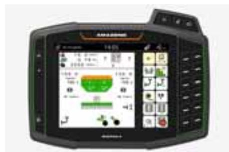
Con la Cirrus, il comando di tutte le funzioni più importanti viene svolto dal terminale ISOBUS. Ciò comprende tutte le funzioni operative nonché la configurazione iniziale della macchina, come ad esempio la calibrazione.
