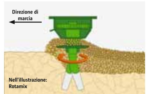
Il sistema Rotamix si caratterizza per i 4 porta-denti con denti "a scaricare" per ogni metro di larghezza di lavoro. Ciò consente di realizzare una struttura a grana fine e un livellamento eccellenti.
