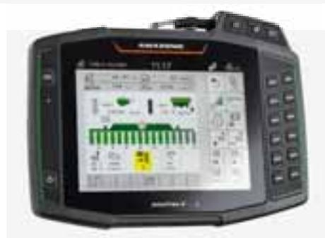
Il dosatore elettrico ElectricDrive permette di regolare comodamente la dose di semina desiderata tramite il terminale ISOBUS e funge da base per un controllo della dose preciso, su aree parziali e ubicazioni specifiche per mezzo di GPS e mappe di zona.
