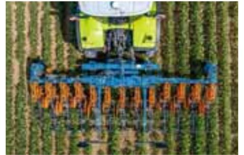
Data la ridottissima profondità del telaio regolabile, il baricentro del sarchiatore è situato molto vicino al trattore.
