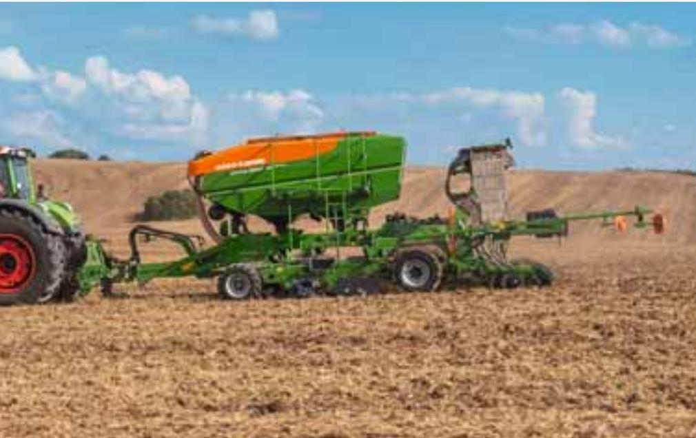
Cirrus 9004-2C Grand con ruote Matrix per il ricompattamento a strisce.
