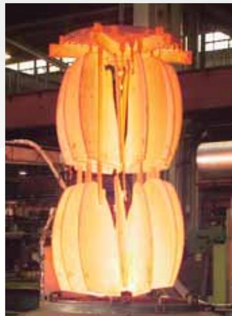
Una delle caratteristiche qualitative peculiari degli aratri Cayros è il trattamento termico con il metodo ©plus per i versoi. Questo trattamento produce durate superiori, maggiore resistenza agli impatti e una minore potenza di trazione richiesta, oltre a una riduzione del consumo di carburante.
