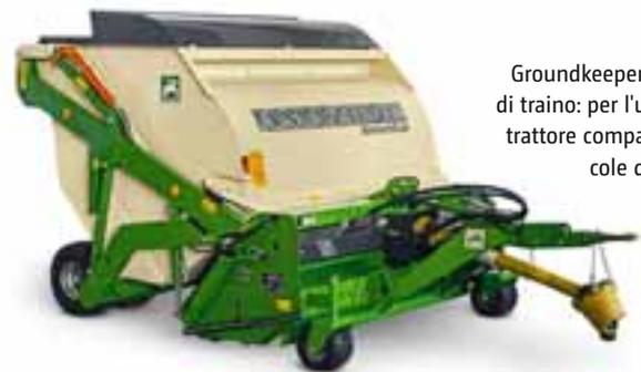
Groundkeeper con barra di traino: per l'uso con un trattore compatto di piccole dimensioni
