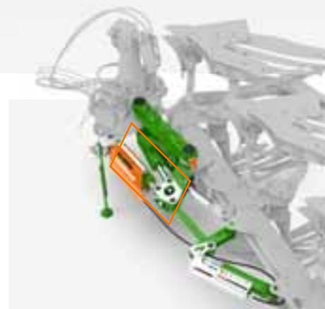
AutoAdapt regola automaticamente il solco anteriore anche quando cambia la larghezza complessiva del solco. L'adattamento preciso è possibile in qualsiasi condizione, grazie al parallelogramma e al collegamento idraulico tra la larghezza del solco e il cilindro per il solco anteriore.
