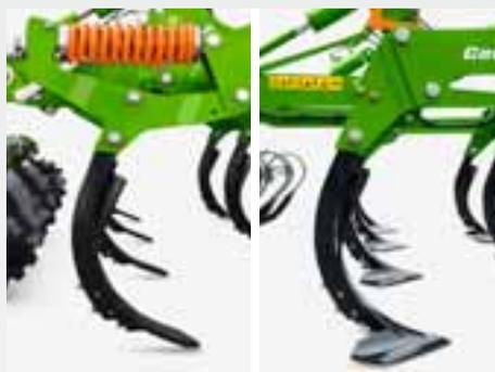
Il sistema di protezione contro il sovraccarico C-Mix Super con sicurezza contro il sovraccarico mediante dispositivo elastico assicura risultati di lavorazione perfetti, anche durante il dissodamento in profondità. Il dente C-Mix-Special con bullone di sicurezza contro sovraccarico è un'ottima alternativa per terreni meno difficili, leggeri e senza pietre.
