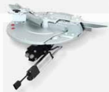
Il sistema di concimazione di confine TS con sistema di concimazione AutoTS integrato: tra la concimazione normale e quella di confine, nel disco di spargimento vengono attivate alette di spargimento diverse. Eccellenti schemi di concimazione di confine senza cambiare disco, controllati in remoto dal sedile del trattore durante il funzionamento.
