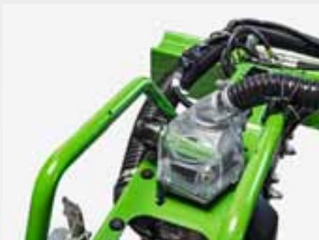
Il nuovo sistema di alimentazione della semente Central Seed Supply trasporta la semente dalla tramoggia centrale alle unità di singolarizzazione mediante un getto d'aria. Lì la semente per ciascuna fila viene riposta temporaneamente in una piccola unità di raccolta.
