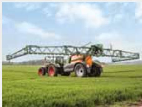
Con il sistema di ripiegamento Profi o Flex è possibile eseguire in modo facile e affidabile tutte le funzioni idrauliche, anche il ripiegamento su un solo lato, dalla cabina del trattore, mediante il terminale ISOBUS.
