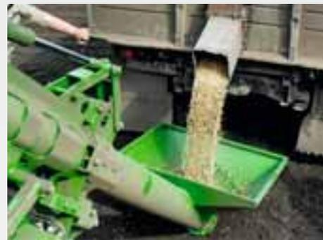
Per il riempimento della Primera DMC con semente e concime, AMAZONE propone una coclea di riempimento ad azionamento idraulico. Questo sistema determina una riduzione fino a 15 minuti dei tempi di riempimento e un conseguente aumento delle prestazioni di lavoro della macchina.
