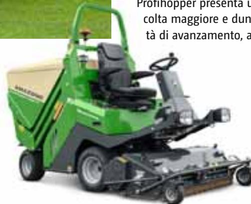
Profihopper 4WDi SmartLine con trazione anteriore e sterzata a raggio 0
