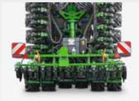
La macchina si caratterizza per la grande stabilità su strada, anche ad una velocità di trasporto di 40 km/ora. Ciò è possibile perché la macchina procede solo su 4 ruote del packer.
