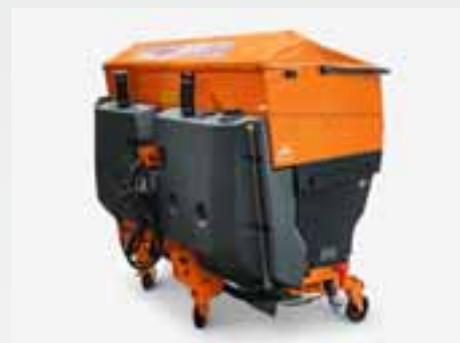
Il sistema di bagnatura preliminare per sale inumidito FS30 con il 30% di liquido incongeloabile comprende una pompa idraulica che permette di erogare il liquido incongeloabile da due serbatoi di plastica di 250 l ciascuno, regolandolo con precisione.
