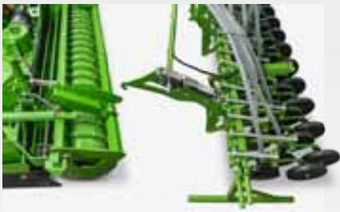
Nonostante la larghezza di lavoro di 6 m, è possibile smontare la barra di semina completa in appena 30 minuti. Grazie a QuickLink, l'Avant con larghezza di lavoro di 3 m o 4 m può essere trasformato per l'impiego singolo in circa 5 minuti.
