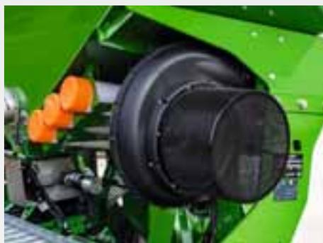
L'azionamento idraulico della ventola consente di regolare comodamente la velocità della ventola. Il numero di giri della ventola si regola comodamente e indipendentemente dal numero di giri del motore, per cui può mantenersi costantemente in un intervallo ottimale.
