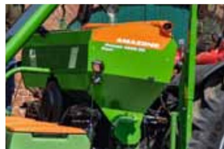
A seconda del modello e dell'equipaggiamento, la tramoggia del concime può avere una capacità di 950 l o 1250 l. La seminatrice di precisione Precea-CC può essere combinata con una concimazione profonda con procedimento Double Shoot.
