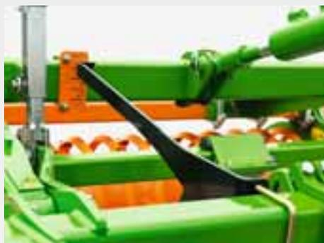
La profondità si regola meccanicamente con un tenditore di serie, oppure con un comodo sistema idraulico dal sedile del trattore. Ciò permette di reagire al variare delle condizioni del terreno durante il movimento.
