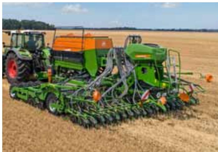
Cirrus 6003-2CC con Minimum TillDisc – per una lavorazione minima del terreno con risparmio di acqua
