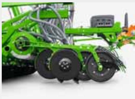
Facile regolazione della profondità di semina e della pressione dei coltri mediante il terminale ISOBUS. Non è più necessario inserire perni e girare manovelle.
