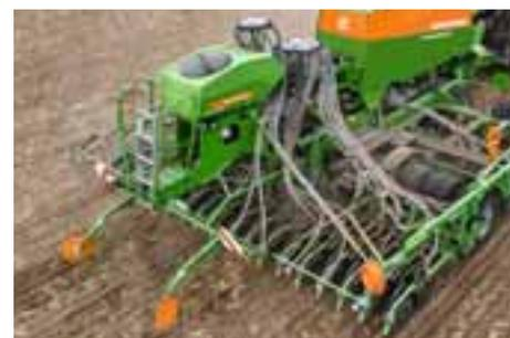
Se montata sulla seminatrice combinata trainata Cirrus, l'unità di semina pneumatica per colture intercalari GreenDrill permette all'utilizzatore di applicare alla superficie del terreno un ulteriore prodotto durante il procedimento di semina. Potrebbe trattarsi di una semente per trasemina o di lumachicidi in granuli.
