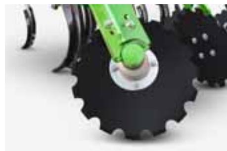
Un livellamento di prim'ordine del terreno è fondamentale per un ricompattamento uniforme. Per questo motivo, dietro le file di denti è montato un elemento di livellamento.
