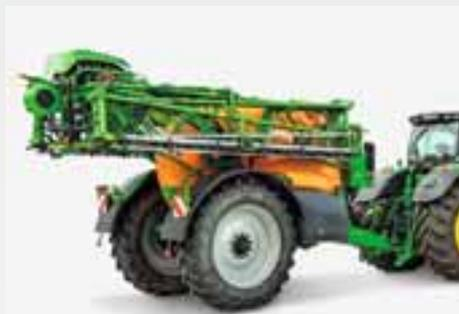
Le barre Super-L da 21 m a 36 m, con una larghezza di trasporto di soli 2,6 m, vengono ripiegate direttamente ai lati del serbatoio. Con un'altezza di trasporto massima di appena 3,8 m, l'UX è molto compatto, anche con pneumatici alti (18.4R46).
