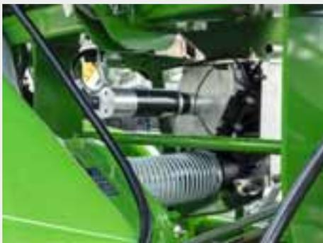
Il dosaggio della semente avviene tramite il dosatore ad azionamento elettrico situato sotto la tramoggia della semente. Per le diverse sementi sono disponibili vari rocchetti dosatori che si prestano ad una sostituzione semplice e rapida.
