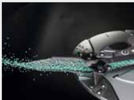
Nello spandiconcime portato ZA-TS e nello spandiconcime trainato ZG-TS, è già integrato di serie il Soft Ballistic System, cioè il sistema in grado di trattare il concime il più delicatamente possibile. L'agitatore, i componenti di dosaggio e i dischi di spargimento sono perfettamente coordinati tra di loro.
