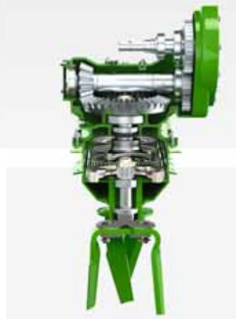
Il cuore del nuovo KE 02 è la trasmissione DirectDrive, attraverso la quale il flusso di forza viene trasmesso direttamente agli ingranaggi cilindrici che azionano i denti dell'erpice rotante. La forza non viene reindirizzata, come avviene anche negli erpici aratori KX e KG. Pertanto viene garantita un'eccellente trasmissione della forza a fronte di un'usura ridotta.
