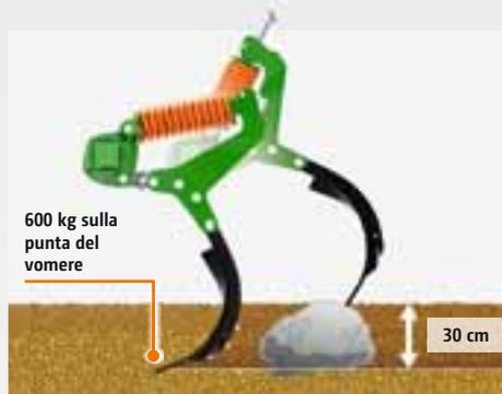
Insieme alla sicurezza contro il sovraccarico, il dente C-Mix-Super consente risultati di lavorazione perfetti, anche nel dissodamento in profondità. La forza di sgancio della sicurezza contro il sovraccarico con dispositivo elastico del dente C-Mix-Super è di oltre 600 kg e ha una corsa di sollevamento potenziale di 30 cm.
