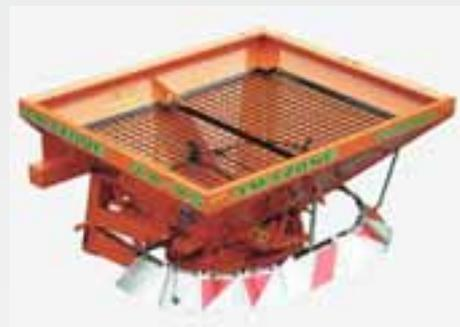
Lo spargitore trainato ZA-XS H è progettato appositamente per le costruzioni stradali. Grazie al suo azionamento idraulico, lo spargitore a due dischi è perfetto per i rulli stradali che eseguono una contemporanea smussatura della carreggiata con il pietrisco.
