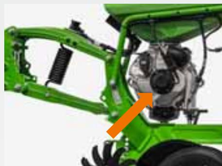
La seminatrice di precisione **Precea Super** dispone dell'azionamento elettrico ElectricDrive, con il quale ogni singolarizzazione per sovrappressione viene gestita separatamente con un motore elettrico. L'azionamento elettrico consente velocità massime di 15 km/h.
