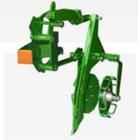
I vomeri con punta a scalpello e guida a parallelogramma sono in grado di seguire costantemente le irregolarità del terreno. Il sistema di protezione contro le pietre consente di evitare gli ostacoli in verticale ed in orizzontale.
