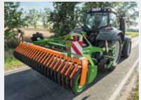
Le unità Catros<sup>XL</sup> sono provviste di dischi laterali regolabili singolarmente. Nella variante da 3 e da 4 m, questi dischi si possono facilmente richiudere per il trasporto su strada, al fine di ottenere la larghezza necessaria.
