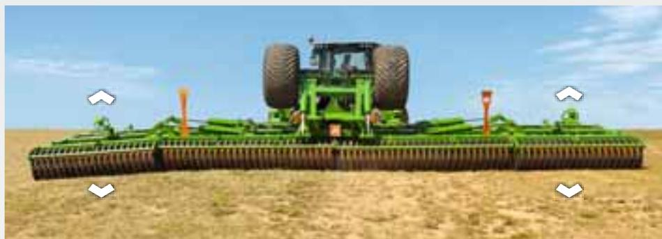
Il Catros+ 12003-2TS è dotato di dischi dentati con un diametro di 510 mm e pertanto consente profondità di lavoro da 5 a 14 cm. Il ContourFrame del Catros+ 12003-2TS è suddiviso in quattro segmenti, ciascuno con un supporto flottante. Il precarico idraulico permette un adeguamento individuale al terreno per ciascuno dei 4 segmenti.
