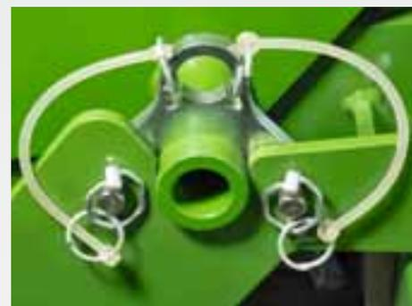
I tre punti di accoppiamento facilmente accessibili del sistema QuickLink assicurano un accoppiamento e distacco sicuro, veloce e senza utensili.
