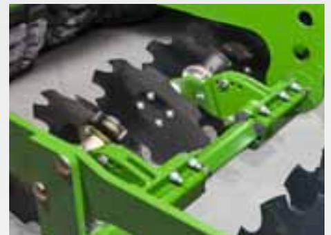
Il porta-dischi con dischi ad angolatura speciale garantisce una qualità eccellente e un letto di semina livellato. La profondità di lavoro può essere regolata idraulicamente durante il funzionamento.
