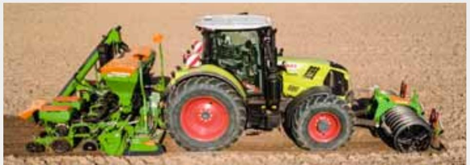
Grazie al sistema di accoppiamento rapido intelligente QuickLink per tutte le seminatrici da 3 m e 4 m portate su erpice, la seminatrice combinata può essere separata facilmente in pochi minuti. I tre punti di accoppiamento facilmente accessibili del sistema QuickLink assicurano un accoppiamento e distacco sicuro, veloce e senza utensili. Di conseguenza la coltivatrice è perfetta anche se usata da sola.
