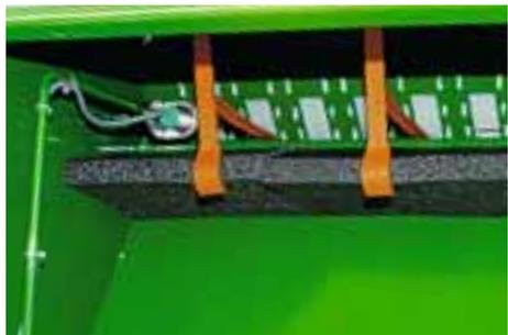
All'interno della tramoggia della semente può essere fissato in modo facile e rapido un kit per l'inserimento di colza che consente di ridurre le quantità di semente residua.
