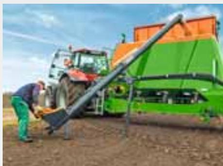
La coclea di riempimento TAM per la seminatrice per superfici estese Citan e la seminatrice a denti Condor può essere gestita senza problemi nella macchina per mezzo di una centralina. Le misure di trasporto si mantengono al disotto di 4 m di altezza e 3 m di larghezza.
