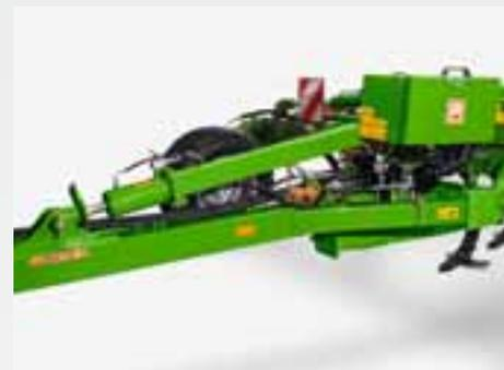
A richiesta è disponibile un sistema di trazione selezionabile. Se attivato, trasferisce una parte del peso della macchina all'assale posteriore del trattore. Alla massima profondità di lavoro sono possibili 1500 kg.
