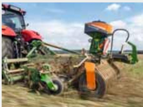
Nel sistema di dosaggio situato sotto la tramoggia della semente è montato un albero di semina con ruote per semente normale o fine, a seconda del tipo di semente e della dose di applicazione desiderata. L'albero di semina e la ventola sono azionati rispettivamente in modo elettrico e idraulico.
