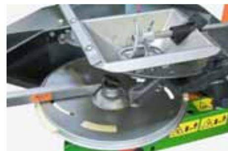
Alle tramogge e al telaio viene applicata una verniciatura a immersione catodica di alta qualità (standard dell'industria automobilistica), mentre l'unità di spargimento, realizzata interamente in acciaio inossidabile, garantisce una lunga durata e un elevato valore di rivendita.
