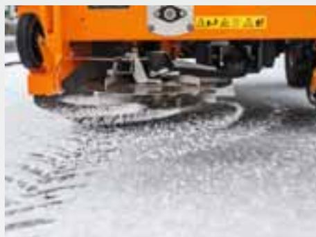
L'equipaggiamento Smart Precision System offre anche un notevole vantaggio costituito dalla regolazione elettrica del punto di deposizione tramite ISOBUS. Qui il grado richiesto di spargimento verso sinistra o destra si imposta in modo facile e comodo dal sedile del trattore.
