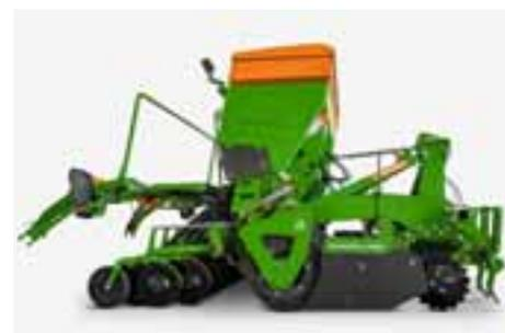
Con il sistema di accoppiamento rapido QuickLink, CombiDisc può essere separato con pochi gesti, tanto che può essere sfruttato molto bene anche nell'impiego singolo per la preparazione del letto di semina.
