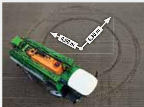
Nonostante le dimensioni, il raggio di sterzata del Pantera 4504 è di soli 4,5 m, sterzando tutte e quattro le ruote. Questo è consentito dal passo breve e dall'ampio angolo di sterzata.
