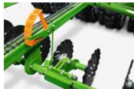
Con il gruppo dischi ondulati Minimum TillDisc, la Cirrus viene dotata di un'ulteriore opzione speciale in fatto di utensili di preparazione. Con una distanza fra le file di 16,6 cm, i dischi di taglio consentono di tagliare resti di raccolto o anche residui colturali vivi direttamente davanti ai coltri di semina, in modo da consentire un buon contatto tra la semente e il terreno.
