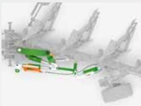
Grazie a SmartTurn, il telaio viene ripiegato poco dopo il sollevamento dell'aratro senza causare sollecitazioni, prima che inizi il processo di inversione. La larghezza del solco non cambia con la rotazione intorno al telaio. Ciò previene l'usura, in particolare nei cuscinetti del corpo dell'aratro.
