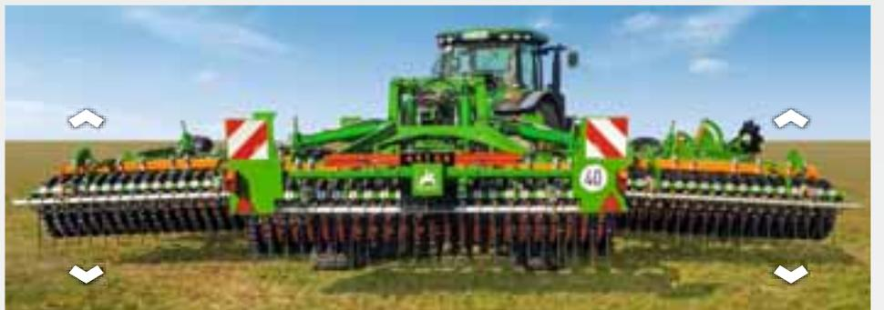
ContourFrame permette inoltre di seguire perfettamente il terreno. Qui i cilindri idraulici dei vomeri esterni vengono pre-pessurizzati per mezzo di accumulatori idraulici e poi messi in posizione flottante, in modo che ciascuno dei tre segmenti possa seguire i contorni del terreno, sia verso l'alto che verso il basso. Di conseguenza la macchina può adattarsi molto facilmente al terreno, anche se è ondulato.
