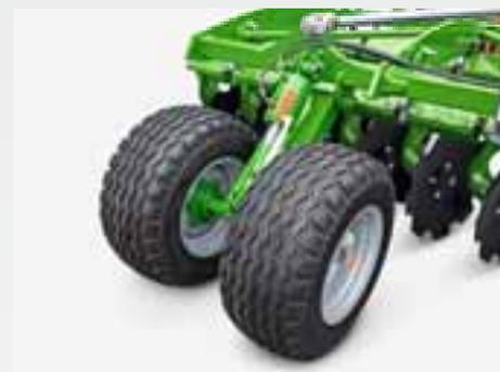
Nel Certos-2TX la regolazione della profondità di lavoro viene effettuata idraulicamente, mediante le ruote di sostegno, senza dover lasciare la cabina del trattore. L'indicazione della profondità di lavoro si può facilmente vedere dalla cabina del trattore e può pertanto essere controllata comodamente in ogni momento.
