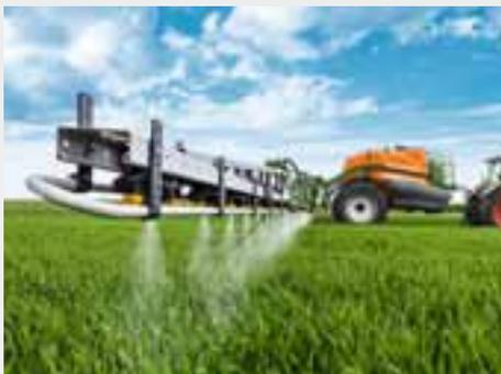
Grazie alla loro particolare conformazione a profilato, le barre AMAZONE sono stabilissime e contemporaneamente molto leggere. Le larghezze di lavoro delle barre spaziano da 21 m a 48 m e permettono di adattare al meglio il polverizzatore alle dimensioni del campo.
