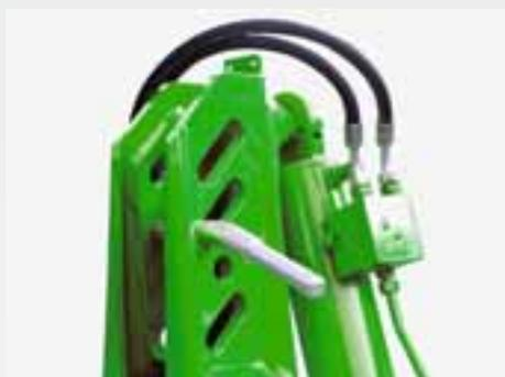
Tutte le testate sono provviste di fori oblunghi per il fissaggio del tenditore. Se il tenditore è posizionato nel foro oblungo, la combinazione aratro-trattore è in grado di adattarsi in modo ottimale al terreno irregolare e dunque di mantenere la profondità di lavoro desiderata.
