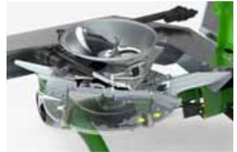
Il sistema di alimentazione con agitatori a stella ad azionamento elettrico sul fondo della tramoggia assicura un'erogazione uniforme del concime ai dischi di spargimento. I segmenti a stella dell'agitatore, che ruotano lentamente, erogano il concime alla pertinente apertura della saracinesca.
