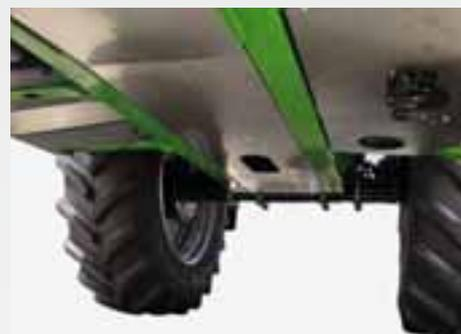
Con il suo sottoscocca rivestito, l'UX Super mette a disposizione una soluzione ideale anche nelle colture alte, per proteggere al meglio la macchina e la pianta. Il rivestimento del sottoscocca copre completamente il lato inferiore con lamiere di acciaio inox, in modo da proteggere al meglio il telaio e le piante.
