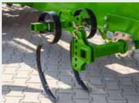
Per l'impiego su terreni morbidi o non ricompattati vengono proposti romptraccia opzionali. I solchi lasciati dalle ruote vengono dissodati e spianati. L'abbassamento e il sollevamento avvengono automaticamente mediante comando idraulico, ad esempio in capezzagna o durante il ripiegamento per il trasporto.
