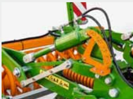
Il gruppo denti può essere dotato di una regolazione idraulica della profondità. Tutte le regolazioni effettuate sono facilmente visibili dal sedile del trattore sulla grande scala graduata.
