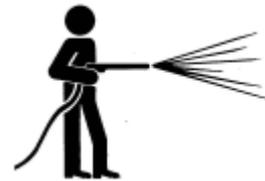
Stellen Sie den Schlauchdruck so gering wie möglich ein, und spritzen Sie unter einem Winkel von 45° bis 90°. Halten Sie mit der Düse des Dampfstrahlers den vom Hersteller empfohlenen Abstand zu der Maschine ein.
