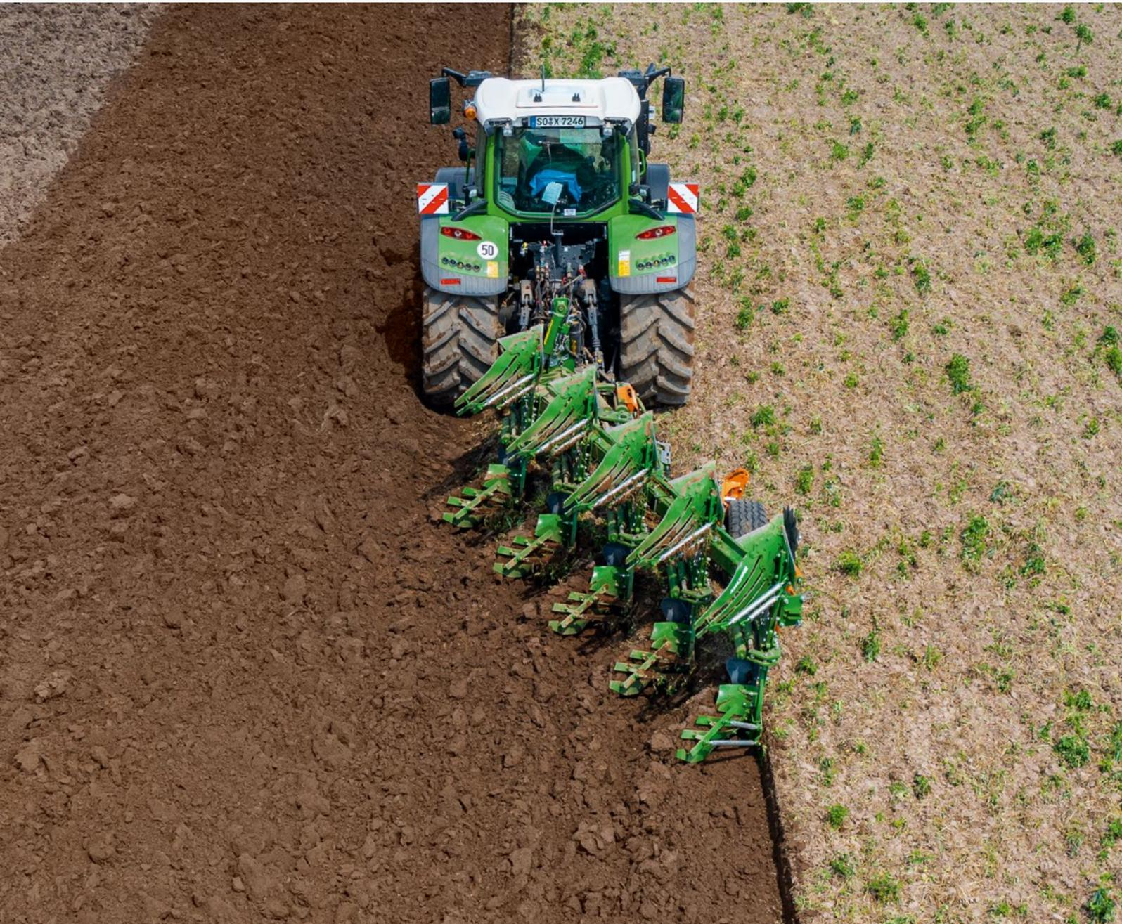
Reprise de rang parfaite grâce à l'ajustement automatique de la largeur de prise de raie du premier corps
