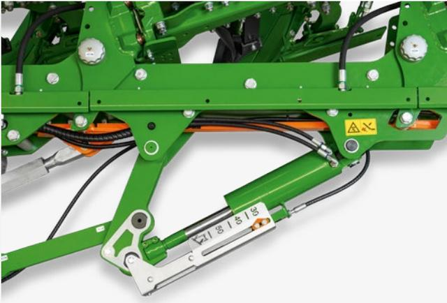
Réglage hydraulique de la largeur de travail
