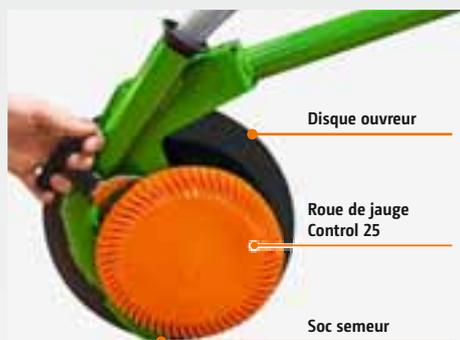
Les RoTeC-Control pour le semis après labour et le semis mulch sont dotés d'un disque souple en plastique Control 25 qui pilote la profondeur de semis avec précision et sans outil.
