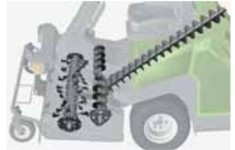
Grâce au système intégré de collecte et d'alimentation PowerCompactor, la tonte est immédiatement amenée après le ramassage dans un système de vis sans fin d'alimentation, compactée et accumulée dans la benne. Ceci permet au Profihopper d'être plus efficace quant au volume et à la rapidité de convoyage – même en conditions d'herbes très hautes – comparativement à d'autres machines de la même catégorie.
