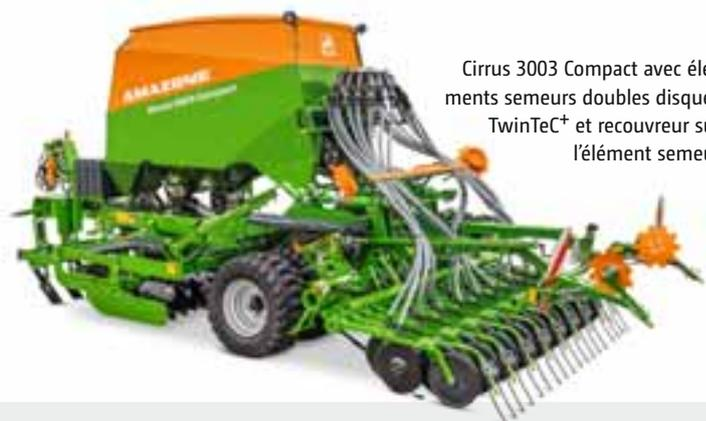
Cirrus 3003 Compact avec éléments semeurs doubles disques TwinTeC<sup>+</sup> et recouvreur sur l'élément semeur
