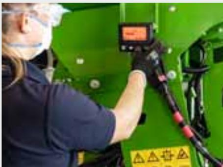
Le TwinTerminal est monté directement sur le semoir, à proximité des unités de dosage, grâce à un support magnétique. Cette position offre un avantage décisif : Le conducteur peut réaliser le pilotage et la saisie des données d'étalonnage directement sur la machine.
