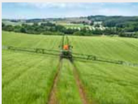
La compensation de dévers intégrée représente un autre atout important. Des capteurs détectent l'inclinaison du châssis et la machine est automatiquement maintenue à l'horizontale jusqu'à une certaine inclinaison.
