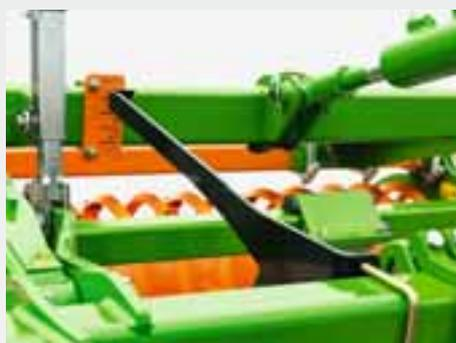
Le réglage en profondeur est réalisé mécaniquement en standard, par le biais d'un tirant supérieur, ou hydrauliquement très confortablement depuis la cabine du tracteur. Il est ainsi possible de moduler la profondeur en cours de travail suivant les différentes conditions du sol.
