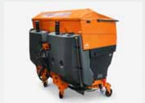
Avec l'équipement optionnel pour bouillie de sel FS30 (30% de saumure), une pompe hydraulique assure une alimentation précise et réglable de la saumure à partir des deux cuves de 250 l chacune.
