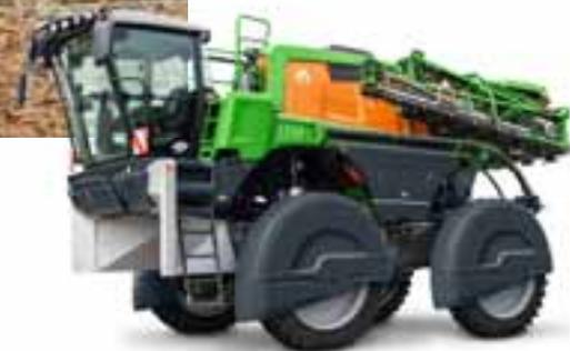
Le kit tournesol pour les pulvérisateurs automoteurs Pantera 4504-H et Pantera 4504-HW permet, tout en préservant les plantes, de mettre en œuvre des mesures de protection phytosanitaires et des mesures de fertilisation, même sur les cultures hautes. Les plantes sont protégées au mieux, de même que les organes du châssis du pulvérisateur automoteur Pantera 4504-H et Pantera 4504-HW.
