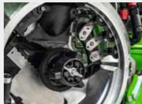
Pour réduire le stress du conducteur et éviter les manques et les doubles, AMAZONE propose le réglage automatique du sélecteur SmartControl sur le Precea Super.
