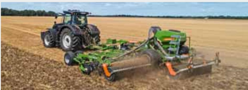
Avec le modèle Catros<sup>XL</sup> 03-2TX, c'est aussi le segment des déchaumeurs à disques indépendants traînés avec essieu pivotant en variante XL qui est disponible avec une profondeur de travail jusqu'à 16 cm. Grâce aux grands disques de 610 mm et aux écarts importants entre les rangées de disques, mais aussi entre la dernière rangée de disques et le rouleau, la variante XL du Catros 03-2TX se démarque surtout par une capacité de passage importante des matières organiques.
