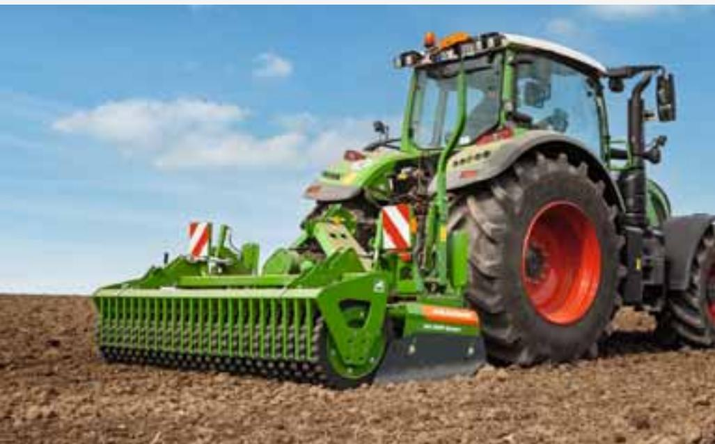
Cultivateur rotatif KG 3001 avec rouleau rayonneur et pneus Matrix
