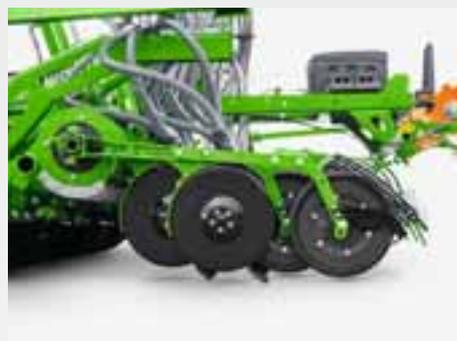
Réglage convivial de la profondeur de semis et de la pression de terrage par le biais du terminal ISOBUS. La mise en place de clips ou une rotation des manivelles font partie du passé.
