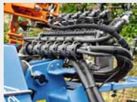
Une régulation avec son bloc de commande pour 2 à 6 tronçons peut être montée sur l'outil attelé à l'arrière. Plusieurs machines peuvent être équipées d'un bloc de commande avec interface de connexion.
