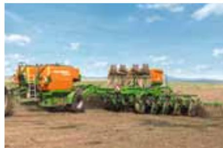
Le semoir Primera DMC, le semoir Condor ou le semoir monograine EDX peut être associé à une unité de fertilisation FDC, spécialement sur les zones de culture arides. L'engrais liquide est acheminé aux éléments semeurs qui incorporent l'engrais dans le sol par une pompe. Cette combinaison est utilisée afin de réaliser le semis et la fertilisation en un seul passage.
