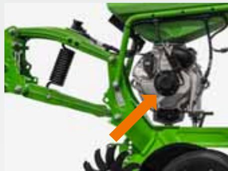
Le semoir monograine **Precea Super** bénéficie de l'entraînement électrique ElectricDrive qui entraîne séparément, par le biais d'un moteur électrique, la sélection en surpression. L'entraînement électrique permet des vitesses de travail jusqu'à 15 km/h.
