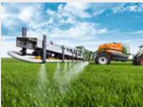
Les rampes AMAZONE sont à la fois super légères et super robustes, grâce à leur mode de construction en profilé spécial pulvérisation. Les largeurs de travail de la rampe de 21 m à 48 m permettent une adaptation optimale à la structure de l'exploitation.
