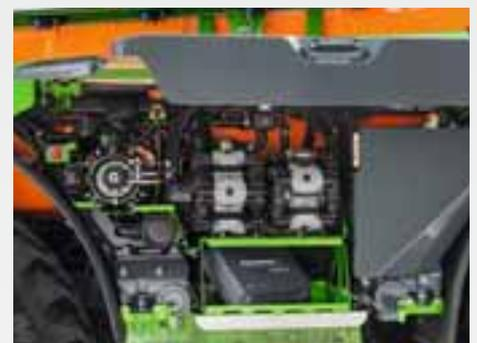
Avec un débit global de 610 l/min, les pompes à piston-membrane sont conçues pour des débits de chantier très élevés. Pour le remplissage, la possibilité d'utiliser l'hydro-injecteur en sus permet une puissance d'aspiration d'environ 750 l/min.
