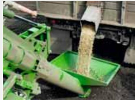
Pour remplir la trémie du Primera DMC de semences et d'engrais, AMAZONE propose une vis de remplissage entraînée hydrauliquement. Les temps de chargement sont ainsi réduits à 15 minutes et le rendement de la machine est encore augmenté en conséquence.
