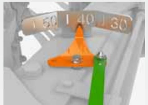
Sur toutes les charrues Tyrok-V, le réglage de la largeur de travail est continu et hydraulique depuis le siège du tracteur. Un affichage bien visible, composé d'une échelle graduée et d'un repère, informe le conducteur de la largeur de travail réglée.
