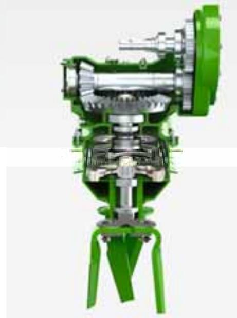
La boîte de vitesses DirectDrive est la pièce maîtresse de la nouvelle KE 02, elle permet la transmission du flux de puissance supérieur directement sur les engrenages des toupies de la herse rotative. Comme sur les cultivateurs rotatifs KX et KG, il n'y a pas de déviation. Ainsi une très bonne transmission des forces, pratiquement sans usure est garantie.
