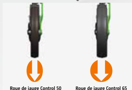
L'élément TwinTeC garantit une excellente implantation de la semence. La roue de jauge Control 50 mm offre un passage élevé et elle est idéale sur les sols lourds et porteurs. La roulette de guidage en profondeur Control 65 mm offre une capacité de charge supérieure, en particulier sur les terrains légers.
