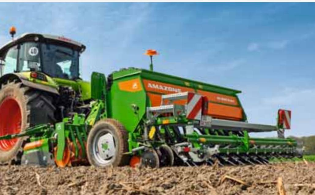
D9 3000 Super avec recouvreur FlexiDoigts, associé à la herse rotative et au rouleau Packer
