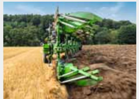
Le versoir ouvert évite, en raison de sa forme, que la terre reste collée en dessous du corps. La charrue est encore plus facile à traîner. Simultanément le support massif et réglable du versoir à claires-voies renforce la stabilité.
