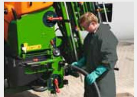
Le tableau de commande de l'UF 01 est positionné de manière centrale, à gauche sur la machine. Seules trois vannes suffisent à piloter toutes les fonctions.
