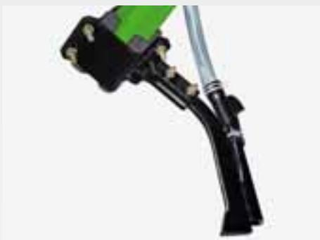
Le soc TineTeC forme un sillon de semis net et propre, exempt de masses organiques. Le mode de construction extrêmement étroit déplace moins de terre. Avantages : Économie d'eau, puissance de traction de la machine minimisée. L'élément semeur TineTeC existe également en version HD pour des durées de vie supérieures.
