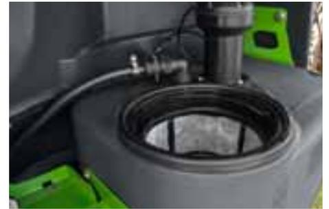
Si le conducteur du pulvérisateur constate par exemple qu'il faut agir sur certaines adventices dans une partie de la parcelle, il peut activer DirectInject depuis la cabine en appuyant sur un bouton. Le produit supplémentaire issu de la cuve DirectInject est injecté et appliqué en plus de la bouillie issue de la cuve principale.
