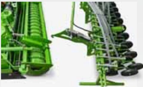
Avec une largeur de travail de 6 m, l'unité de semis complète peut être démontée en seulement 30 minutes. Grâce à QuickLink, l'Avant avec une largeur de travail de 3 m ou 4 m peut être mise en œuvre pour une utilisation solo en 5 minutes environ.
