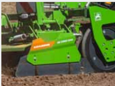
Les tôles latérales de conception nouvelle sont montées sur ressort. Grâce à leur fixation, les tôles latérales peuvent être réglées sur un trou oblong et simplement remplacées en cas d'usure. Pour le réglage, l'outil de réglage universel fourni suffit.
