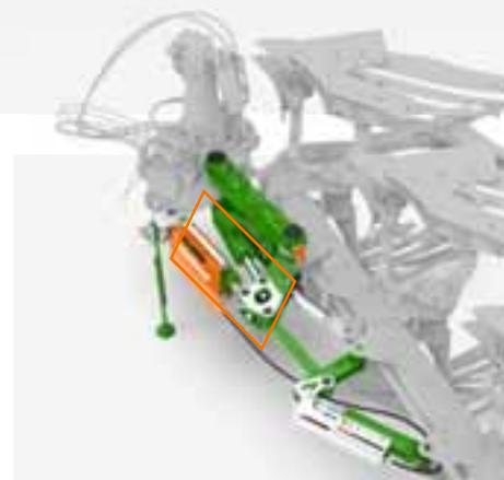
Grâce à AutoAdapt, l'ajustement de prise de raie du premier corps est réglé simultanément en cas de modification de la largeur globale de travail. Grâce au parallélogramme et à la liaison hydraulique entre le vérin de largeur de travail et celui de déport, le raccord de raie est précis quelles que soient les conditions.
