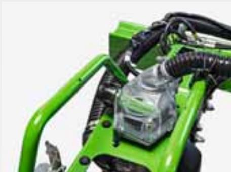
Avec le nouveau système d'alimentation Central Seed Supply, la semence est acheminée par un flux d'air, de la trémie centrale vers les éléments semeurs. La semence y est stockée temporairement par rang dans une petite trémie intermédiaire.
