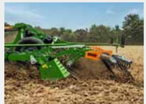
En plus de la large gamme de rouleaux, un double recoureur est aussi proposé pour le Cobra. Il assure une meilleure répartition des résidus de récolte et un nivellement optimal de la surface.
