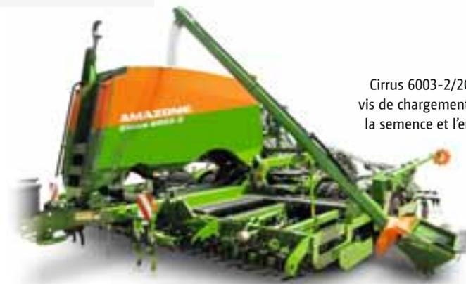
Cirrus 6003-2/2C avec vis de chargement pour la semence et l'engrais
