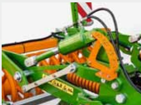
Le compartiment de dents peut être équipé d'un réglage de profondeur hydraulique. Les réglages sont bien visibles depuis la cabine du tracteur grâce à une grande règle graduée.
