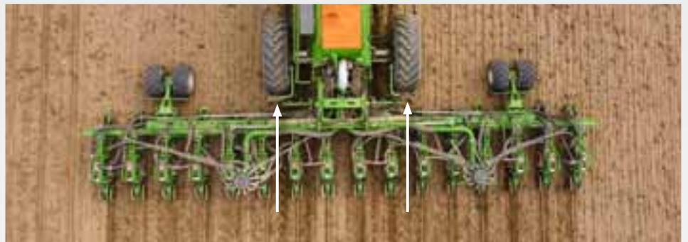
Un essieu télescopique est disponible pour modifier la voie du Precea selon l'inter-rang. Au travail, la voie des pneumatiques de grandes dimensions peut être modifiée ; ainsi les roues passent entre les rangs de semis en évitant les compactages juste sous les rangs de semis. Avec cet essieu télescopique, le Precea-TCC rentre dans le gabarit routier des 3m de largeur sur route.
