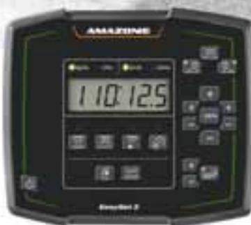
Ordinateur EasySet pour le pilotage électrique du tiroir ou de la limitation de la largeur d'épandage
