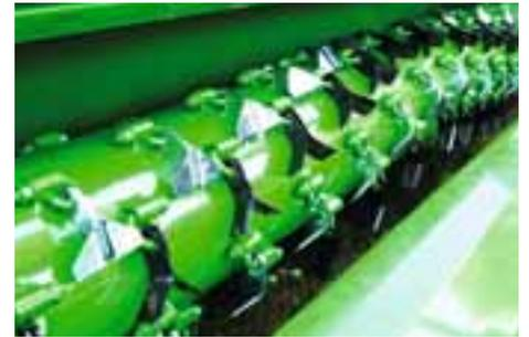
La gamme Tondobalai et Profihopper intègre le rotor de coupe précis SmartCut®, doté d'une qualité de ramassage exceptionnelle. Le rotor se démarque par la disposition spéciale de ses couteaux en forme de V qui permet une réduction de la consommation d'énergie et du niveau sonore.
