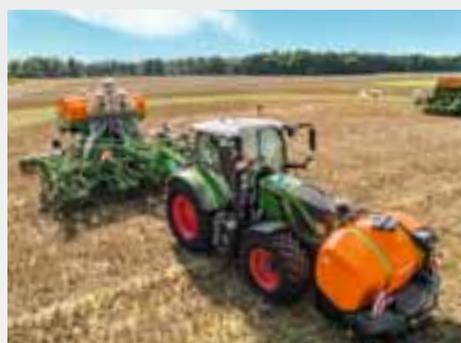
La FT-P peut aussi être utilisée pour une application d'engrais liquide avec semis simultané.
