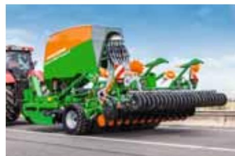
Avec les pneus Matrix conçus pour le Cirrus, la machine pleine de semence peut rouler en toute sécurité à 40 km/h sur les routes (selon la législation en vigueur). C'est 100 % conforme au code de la route. L'attelage par bras inférieurs permet une maniabilité exceptionnelle du Cirrus par exemple en fourrière.
