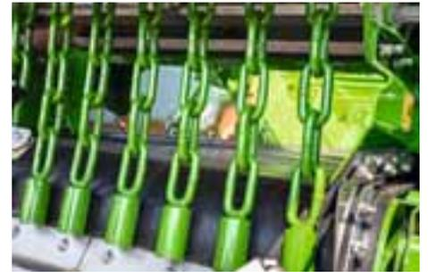
La chaîne racleuse en option assure une alimentation homogène et très régulière des disques d'épandage par le fond mouvant. Si le ZG-TX est de nouveau utilisé pour épandre l'engrais minéral, les chaînes sont simplement accrochées dans la fixation.
