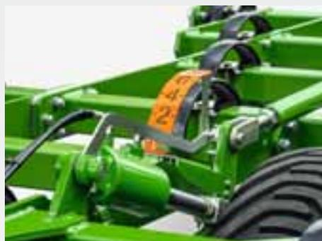
Une barre de couplage entre les éléments de guidage en profondeur assure un réglage homogène devant et derrière la machine. La profondeur de travail se règle en continu en cabine du tracteur.
