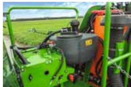
Les Pantera 4504 et 7004 peuvent être désormais équipés du système DirectInject, afin d'incorporer différents produits de façon rapide et flexible, en fonction des besoins.
