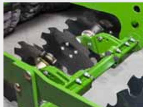
Le support de disques avec disques spécialement inclinés fournit un lit de semis préparé et nivelé à la perfection. La profondeur de préparation est adaptée hydrauliquement durant le travail.
