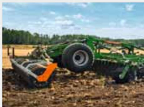
Le train de roues central intégré confère au Certos-2TX une maniabilité élevée. Afin d'obtenir une régularité de fonctionnement élevée et une qualité de travail homogène, le Certos-2TX est équipé en standard d'un amortissement au niveau du timon.
