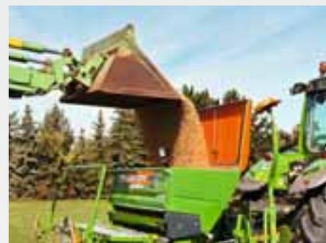
Une large passerelle de chargement, accessible par un marchepied rabattable particulièrement large, facilite le remplissage du semoir. La très large ouverture permet un remplissage rapide et sans effort, même avec des bigbags, un chargeur frontal ou de la semence en sac.
