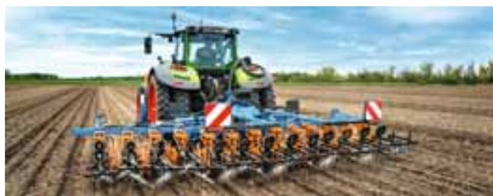
**Binage** : Par exemple bineuse Venterra-2K
