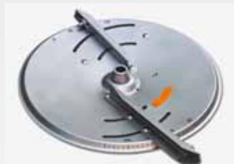
Le ZG-B Drive avec AmaTron 3 est équipé de disques OmniaSet® pour une fertilisation minérale précise.
