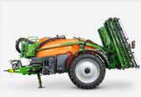
Il est également possible d'équiper l'UX Special de la rampe Super-S2 de 15 m à 28 m. Toutes les rampes peuvent être guidées de manière entièrement automatique parallèlement à la surface visée, par le biais de la fonction DistanceControl.
