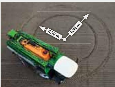
Malgré les dimensions du véhicule, le rayon de braquage minimal du Pantera 4504 est de seulement 4,5 m, en mode quatre roues directrices. Un empattement court et un grand rayon de braquage rendent ces performances possibles.
