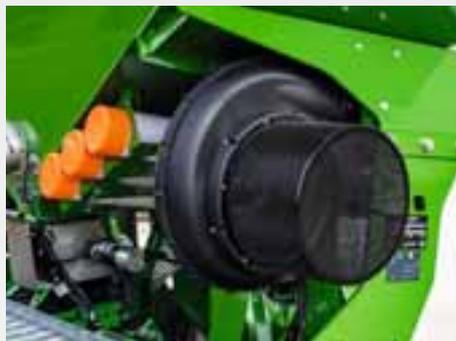
L'entraînement hydraulique de turbine assure un ajustement confortable du régime de turbine. Le régime de turbine est réglé confortablement et indépendamment du régime moteur, le régime est ainsi toujours constant et sur la plage optimale.
