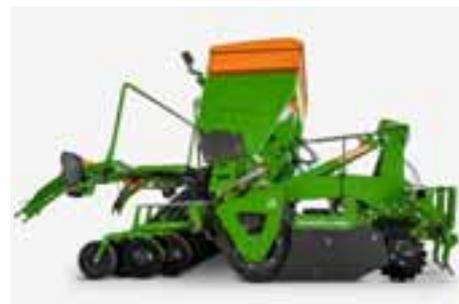
Le système de couplage rapide QuickLink permet de décrocher le CombiDisc en quelques manipulations, de façon à utiliser le déchaumeur à disques indépendants porté en solo pour la préparation du lit de semis.
