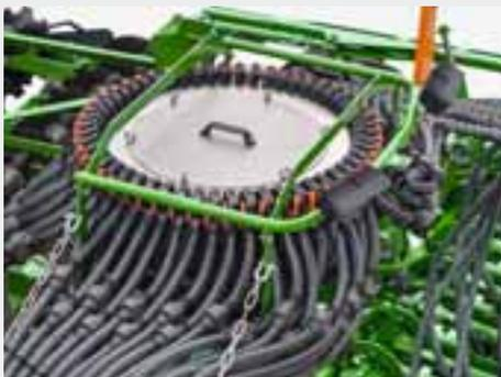
La nouvelle tête de distribution assure une bonne répartition transversale. Équipée d'une coupure individuelle de rang, cette tête garantit fiabilité avec économie de semence et d'engrais à la clé.
