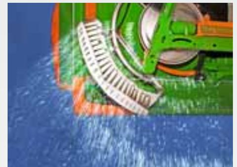
Pour l'épandage en bordure, en limite ou au niveau des fossés avec le dispositif d'épandage en limite Limiter télécommandé hydrauliquement, il n'est pas nécessaire de s'arrêter, ni de descendre du tracteur.
