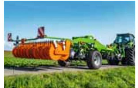
Le train de roues TX logé à l'intérieur du Ceus-2TX et du Ceus-TX garantit une maniabilité élevée en fourrière et un déplacement routier confortable. En fonction des restrictions nationales, une homologation 40 km/h est possible pour le Ceus-2TX et le Ceus-TX pour des déplacements routiers rapides.
