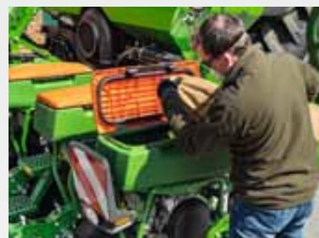
Les trémies de semence ont une capacité de 55 ou 70 l. Les trémies sous pression s'ouvrent d'une seule main et sont protégées de la poussière par un joint en caoutchouc. Par ailleurs une glissière est intégrée dans le couvercle de trémie pour évacuer la semence restante.
