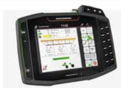
La commande machine du GreenDrill 501 peut se faire de différentes manières. Si le GreenDrill 501 est monté sur un Cirrus, il est totalement intégré dans l'électronique du Cirrus. Si le GreenDrill est monté sur une préparation du sol, il est doté de son propre ordinateur ISOBUS et peut être piloté, soit par le terminal ISOBUS du tracteur, soit par le terminal ISOBUS AmaTron 4.
