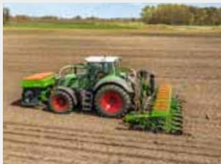
L'utilisation de la trémie FTender est donc très polyvalente. Elle s'utilise pour la technique de semis monograine, la préparation du sol, le semis de céréales ou combinée avec des machines d'autres constructeurs.
