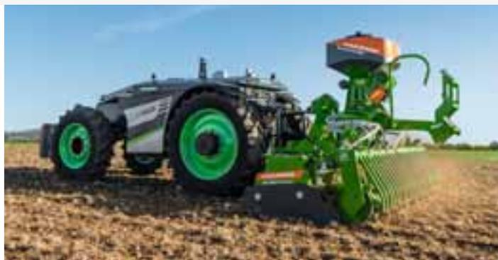
AgXeed AgBot 4 roues et la herse rotative KE 3001 Super AMAZONE avec le semoir compact GreenDrill
