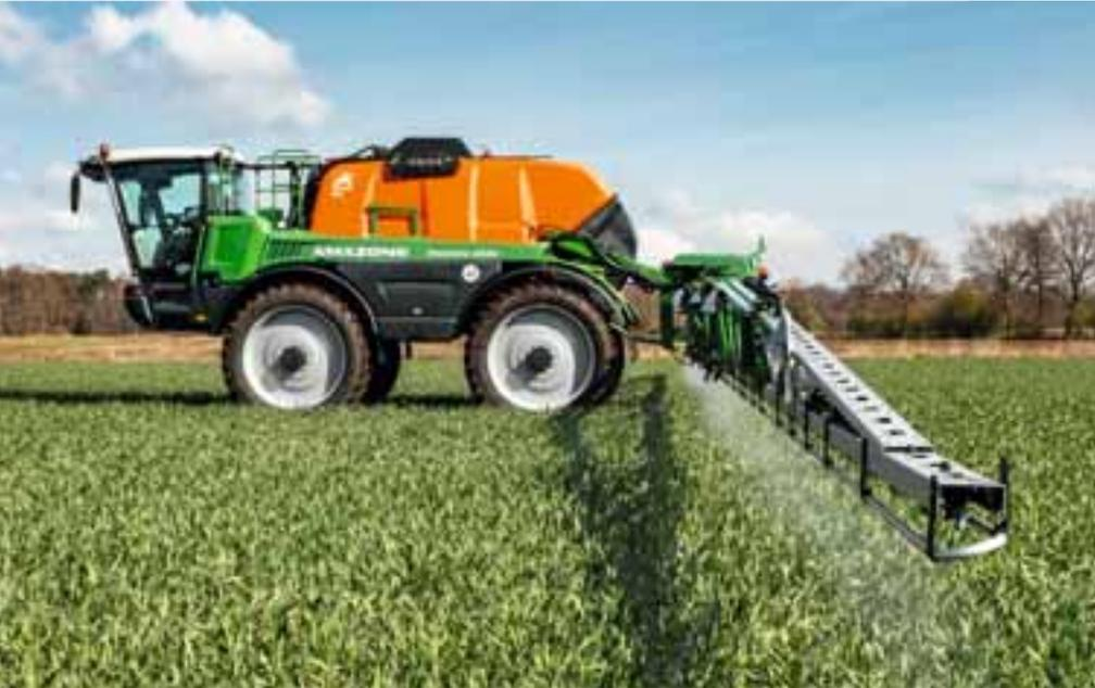
Pulvérisateur automoteur Pantera 4504 avec garde au sol de 1,20 m
