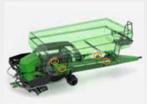
Avec le système de pesée Profis intégré dans le châssis, la trémie avec son cadre est reliée à un châssis séparé par quatre cellules de pesée.
