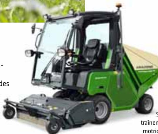
Profihopper 1500 4WDi SmartLine avec cabine et entraînement intelligent quatre roues motrices et rayon de braquage nul
