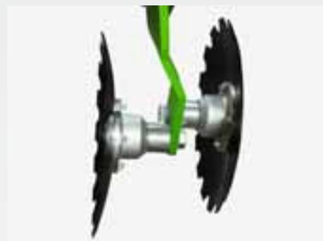
L'unité de disques sur 2 rangées ameublit, émotte et nivelle le lit de semis avant l'implantation de la semence. Avec un angle de 14° sur la rangée de disques avant et de 12° sur la rangée de disques arrière, les disques CombiDisc sont réglés presque à la verticale. Cet angle garantit un nivellement optimal du lit de semis.
