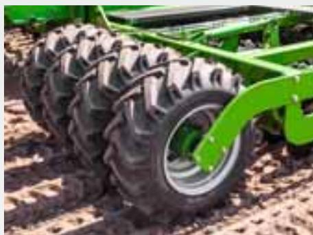
Avec le rouleau latéral T-Pack S pour les Cirrus 4003-2/2C/2CC et 6003-2/2C/2CC, le sol est rappuyé dans des conditions faciles à moyennes ou après le labour devant les disques et assure ainsi un rappuyage supplémentaire.
