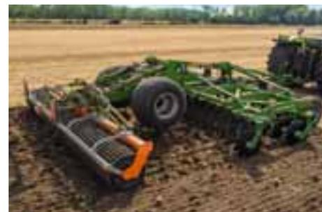
Afin de réaliser un guidage en profondeur homogène de la machine, le Certos-2TX est guidé à l'arrière par le biais du rouleau suiveur et à l'avant par les roues d'appui.
