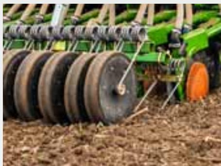
Le recouvreur TassAprès® rapproche les lignes de semis en surface, pour générer des conditions de germination optimales. Cette opération est particulièrement recommandée sur les sols légers, secs pour les semis de cultures d'été ou de colza.
