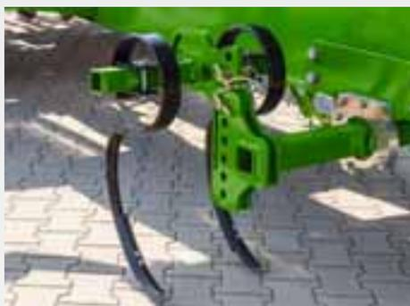
Pour le travail sur les sols ameublés ou non rappuyés, des efface-traces sont proposés en option. Les traces de roues sont ouvertes et nivelées. Le changement de position automatique en fourrière est réalisé par le pilotage hydraulique, de même que le repliement pour les déplacements routiers.
