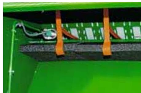
En option, un dispositif colza est inséré en quelques manipulations dans la trémie de semence pour réduire les résidus de colza.
