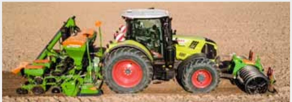
Grâce au système de couplage rapide intelligent QuickLink pour tous les semoirs compacts 3 m et 4 m, le combiné de semis est très facile à décrocher en quelques minutes. Pièce d'accouplement rapide QuickLink garantissent un accrochage et un décrochage fiable, rapide et sans outil. L'outil de préparation du sol peut aussi parfaitement être utilisé pour le travail en solo.
