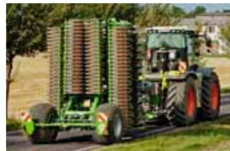
Sécurité des déplacements routiers avec une largeur au transport de moins de 3 m grâce au repliage hydraulique du châssis en standard.
