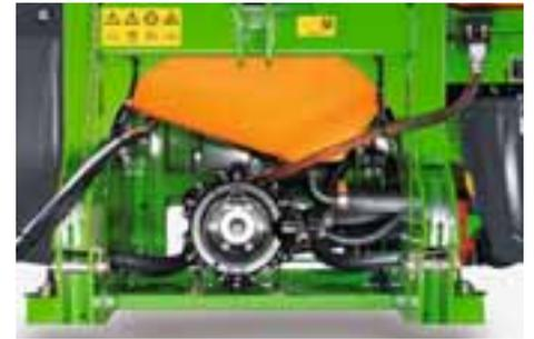
Les pompes à piston membrane sont protégées contre le fonctionnement à sec et compatibles avec l'emploi d'engrais liquides. Le modèle de pompes veille, en cas de performance d'aspiration élevée, à un remplissage rapide et à un fonctionnement silencieux de la pompe, y compris en cas de pression élevée.
