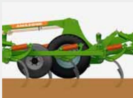
Pour que la machine travaille avec régularité et à une profondeur constante, même avec de grandes largeurs de travail, des roues d'appui sous pression sont intégrées dans la machine à partir d'une largeur de travail de 6 m. Une dent est ici aussi intégrée derrière chaque roue pour que leurs traces soient de nouveau ameublées.
