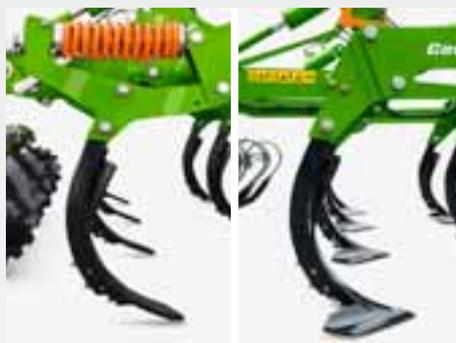
La sécurité de surcharge C-Mix-Super, commandée par ressort, assure un résultat de travail parfait, même avec une préparation à mi profond. Les dents spéciales C-Mix avec sécurité par boulon de cisaillement offrent une alternative pour les sols légers et moyens exempts de pierres.
