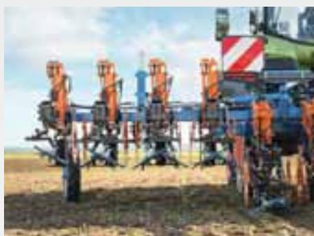
Le relevage individuel hydraulique du parallélogramme piloté par Section Control permet de biner jusqu'à la dernière pointe. Avec le parallélogramme de binage KPP-L SC, la garde au sol des éléments de binage va jusqu'à 50 cm, l'idéal pour une utilisation dans des cultures à forte croissance.
