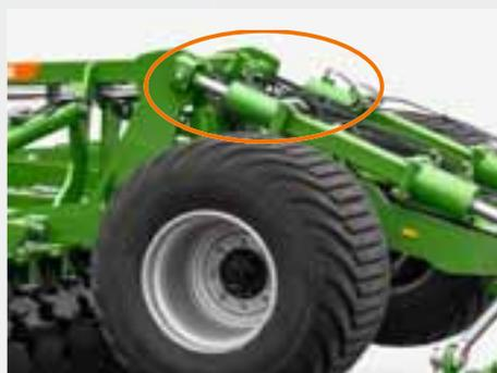
L'équipement du Certos avec une barre supérieure hydraulique permet de moduler son inclinaison. En cas d'effort oblique de la machine, la compensation est réalisée confortablement depuis le siège du tracteur.
