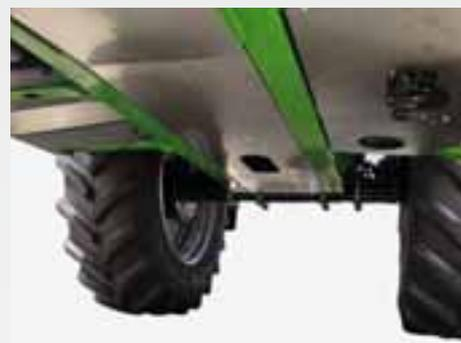
La protection de dessous de caisse de l'UX Super offre, même sur les cultures hautes, une solution optimale pour protéger au mieux la machine et les plantes. La protection de dessous de caisse complètement habillée par des tôles en acier spécial assure une protection efficace des essieux et des plantes.
