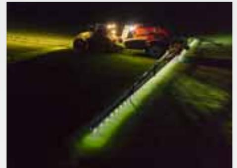
L'éclairage à LED individuel des buses en option amène l'éclairage de façon encore plus ciblée sur le cône de pulvérisation. Cet éclairage permet même de juger le fonctionnement de la dernière buse sur la rampe.
