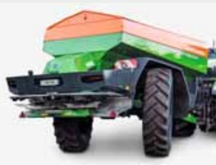
Avec l'essieu directeur en option, les épandeurs traînés ZG-TS offrent un angle de braquage maximal jusqu'à 28°. Cela signifie : Avec une largeur de voie de 1 800 mm et une largeur de pneu de 520 mm, un parfait suivi dans la voie est déjà possible.
