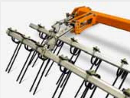
En plus de la large gamme de rouleaux, une double herse est aussi proposée pour le Ceus-2TX, le Ceus-TX et le Ceus-2TX. Elle assure une meilleure répartition des reliquats de récolte et un nivellement optimal de la surface.
