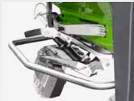
Le ZA-V avec commande hydraulique de trappe est également disponible avec le système d'épandage en bordure à commande hydraulique Limiter V pour l'épandage en limite et en fossé. La hauteur recommandée du Limiter V est réglée en insérant l'axe en fonction de la situation avant l'épandage.
