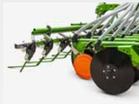
L'élément semeur RoTeC permet de semer avec une précision maximale, quelles que soient les caractéristiques du sol et les conditions météorologiques. La profondeur de semis est réglée rapidement au niveau de l'élément semeur. La pression de terrage est modifiée confortablement hydrauliquement via le terminal ISOBUS.
