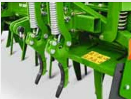
Les efface-traces en option sont judicieux pour travailler sur les sols sensibles au compactage et avec une profondeur de travail réduite. Ils ameublissent les traces compactes derrière les pneus du tracteur.
