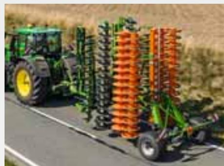
Grâce à son essieu articulé derrière le rouleau, le Catros+ 2TS passe confortablement et rapidement d'un chantier à l'autre.
