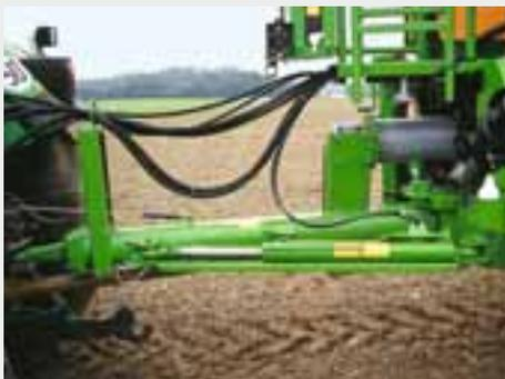
Un timon articulé, universel, pour piton d'attelage ou pour chape d'attelage avec rat-trapage hydraulique permet de ne pas abîmer le sol, car il ne laisse pas de traces.
