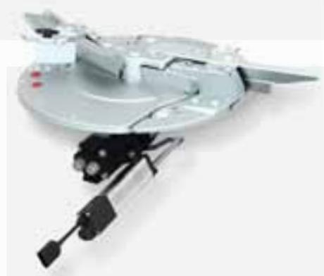
L'organe d'épandage TS avec système d'épandage en bordure intégré AutoTS : Pour l'épandage normal et en bordure, différentes aubes d'épandage sont activées sur le disque d'épandage. Excellentes courbes d'épandage en bordure sans changer de disque – télécommandées depuis la cabine du tracteur en cours de travail et sans arrêter l'épandeur.
