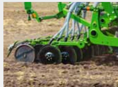
Le système doubles disques TwinTeC+ est doté d'un réglage hydraulique en continu de la pression de terrage qui comprend une large plage de réglage de 15 à 100 kg. De ce fait la pression est adaptée rapidement et simplement en fonction des variations des conditions de sol.
