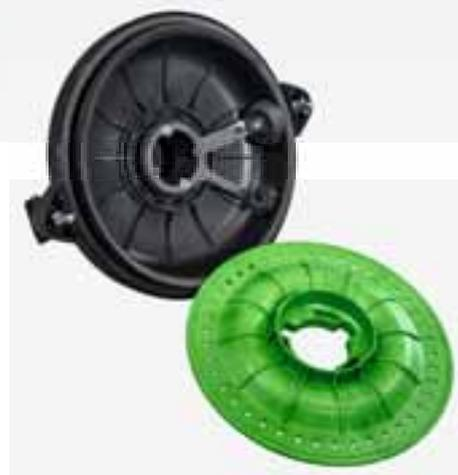
La sélection précise représente l'atout principal du Precea. Le dosage est réalisé en surpression. La semence et l'intégralité du dosage sont en surpression. Trois sélecteurs assurent la sélection des graines en surplus afin d'éviter les doublons. La sélection est très précise, même à des vitesses d'avancement élevées jusqu'à 15 km/h.
