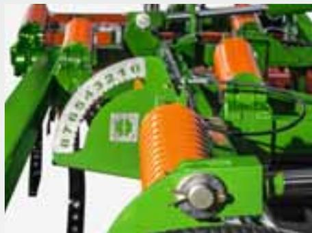
Le réglage hydraulique en option du système de nivellement permet un réglage central depuis la cabine du tracteur. Une échelle graduée bien visible depuis le siège du conducteur permet de visualiser la position actuelle de travail des disques de nivellement.
