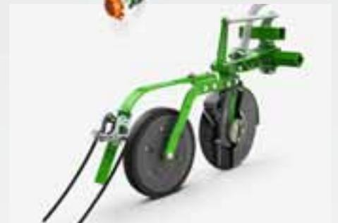
L'Avant 02 est équipé d'éléments semeurs TwinTeC avec des écartements de 12,50 cm ou 15 cm. La profondeur de semis est réglée de façon centrale, elle est respectée avec précision grâce à la roulette de contrôle de profondeur.
