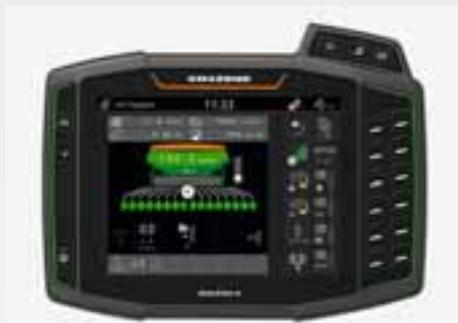
Pour la commande et la documentation du combiné de semis, on utilise le terminal ISOBUS AmaTron 4 AMAZONE ou n'importe quel terminal ISOBUS d'un autre constructeur.
