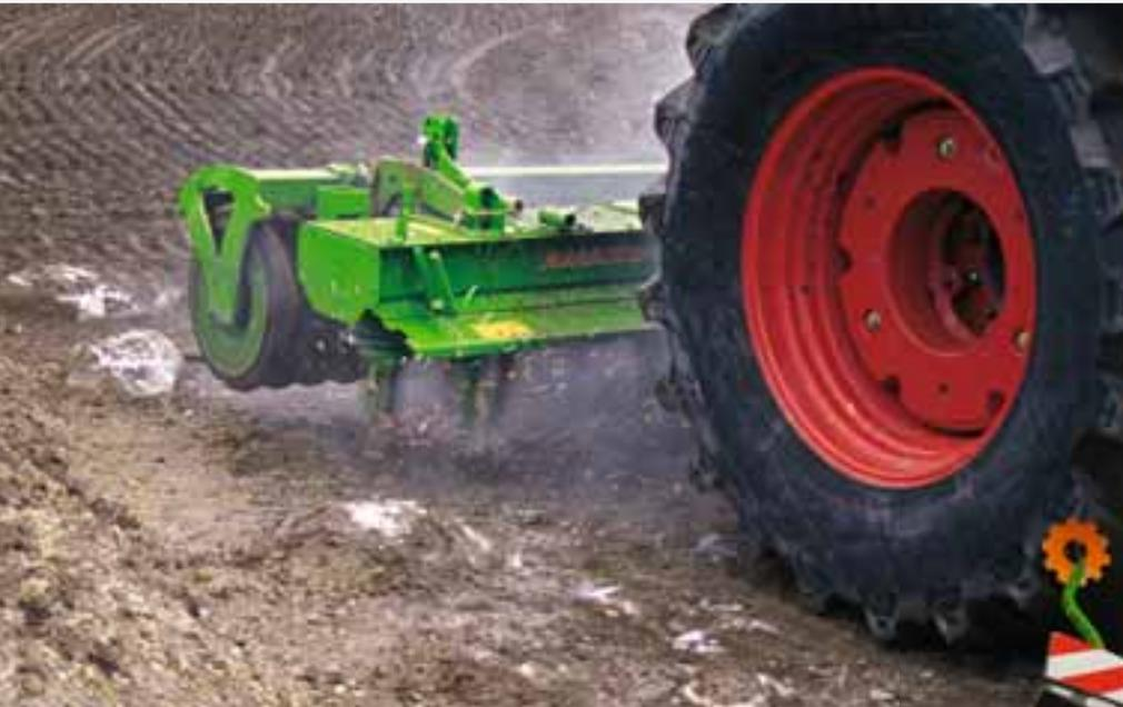
Parcours d'essai en situation extrême sur piste de torture: La fixation « élastique » des dents sur la herse rotative et le cultivateur rotatif permet un effacement de la dent devant les pierres.
