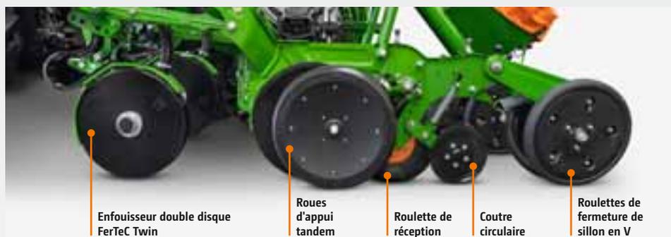
Le disque semeur PreTeC complet est guidé par deux grandes roues d'appui. Le sol est ouvert par une unité doubles disques ouvreur. Une fois la semence fixée dans le sol par la roulette de réception, viennent ensuite les roulettes de fermeture en V. L'élément semeur complet est bien accessible. Les paliers sans maintenance et bien étanchéifiés limitent considérablement les temps de maintenance.
