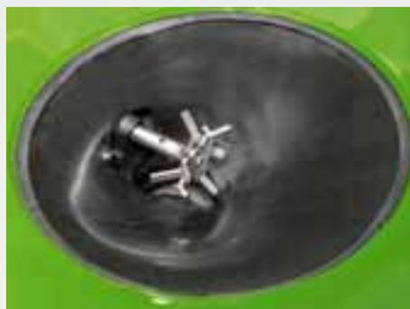
L'agitateur mécanique du ZA-V est positionné directement au-dessus de la trappe et assure ainsi un flux permanent et continu de l'engrais, quels que soient les débits. A seulement 45 tr/min il prend en charge l'engrais tout en douceur.
