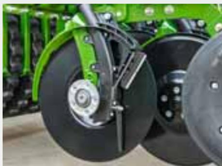
Le semoir compact Cataya Super est équipé au choix de monodisques RoTeC ou de doubles disques TwinTeC.
