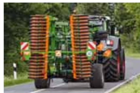
L'essieu de transport indépendant offre à la machine une maniabilité élevée sur route et au champ. Selon la législation nationale en matière d'homologation et l'équipement machine, une vitesse de transport jusqu'à 40 km/h est possible.
