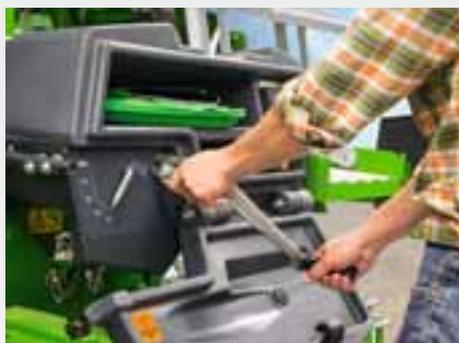
La pression de terrage sur le TwinTeC et la profondeur d'implantation de semence sont réglées indépendamment sur le SmartCenter. Grâce à l'utilisation d'un outil universel, ces réglages centraux sont également rapides et simples.
