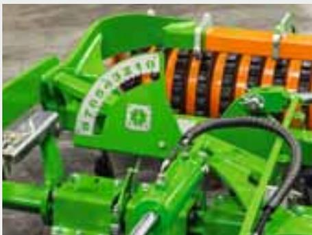
La profondeur de travail à commande hydraulique de série permet un réglage confortable en cabine. De ce fait, la profondeur de travail est adaptée de façon très souple. Le travail peut être superficiel en plein champs et profond en fourrières ou sur les traces.
