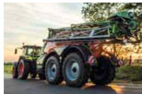
Le châssis hydropneumatique fournit un confort de conduite parfait, associé au timon d'attelage amorti. Les unités d'essieu BPW avec la régulation de niveau fournie en standard s'adaptent en permanence à l'état de charge.
