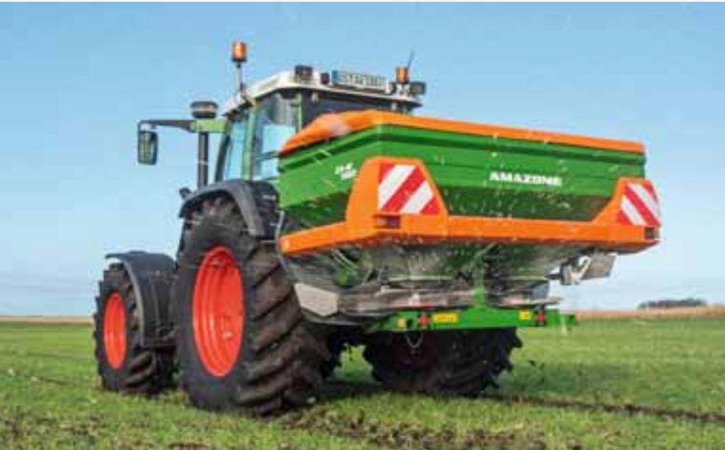
ZA-M épandeur d'engrais deux disques
