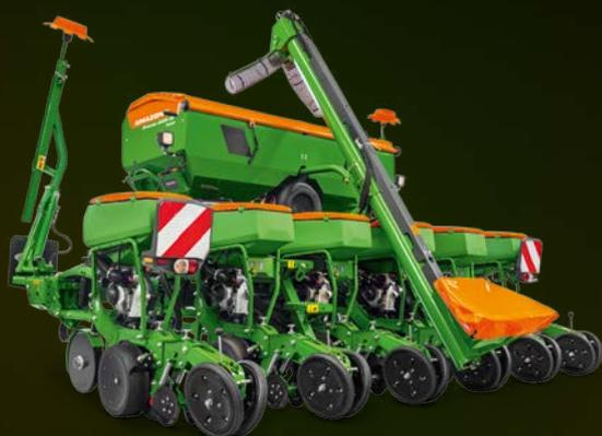
Precea 4500-2CC Super con depósito posterior de abono y tornillo sin fin de llenado
