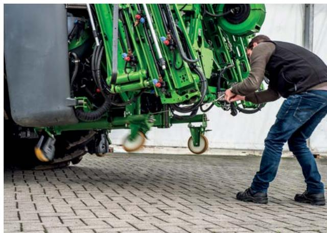
✔ Простое выдвигание и задвигание стояночного приспособления
