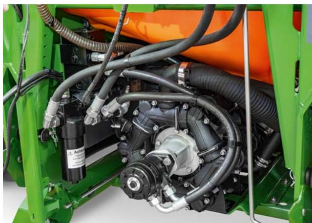
Гидравлический привод насоса 300 л/мин на UF 02
