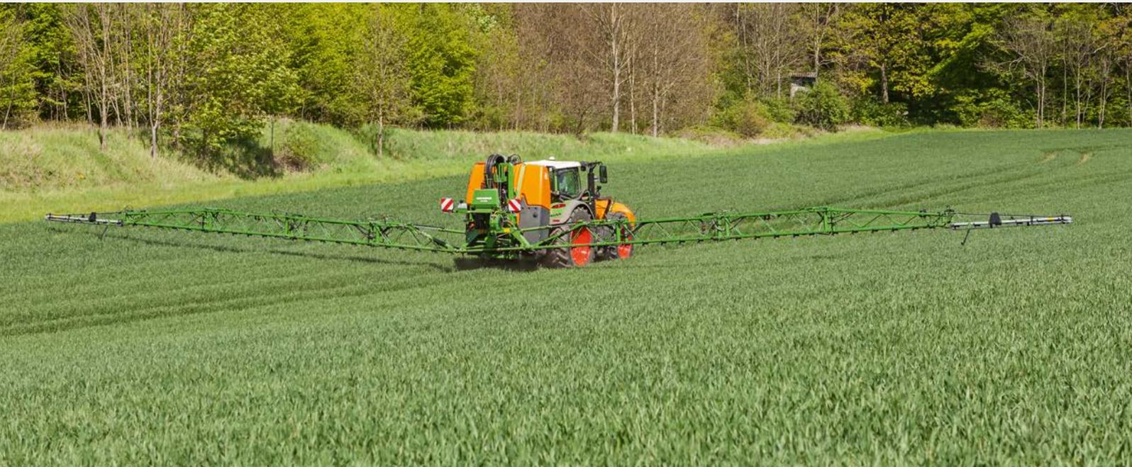
Навесной опрыскиватель UF 2002 с ContourControl для автоматического ведения штанги
