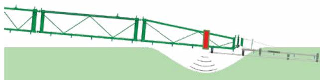
DistanceControl при оснащении двумя датчиками:
