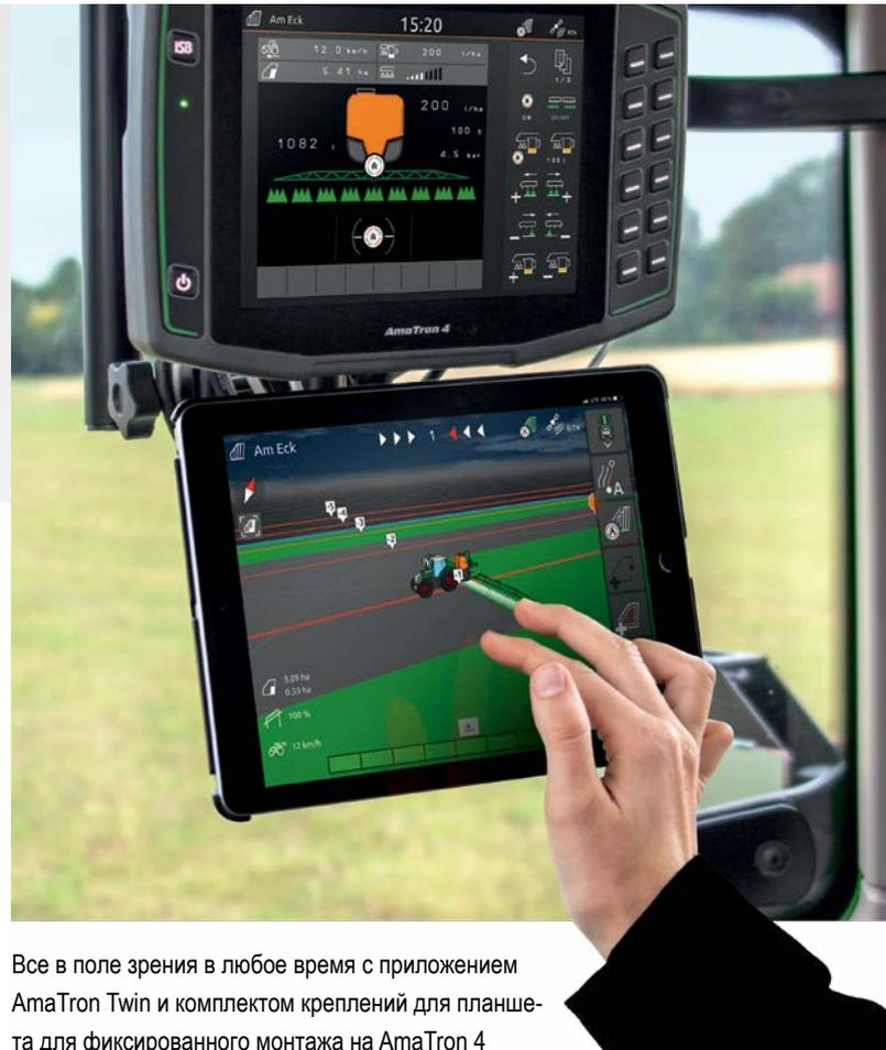
Все в поле зрения в любое время с приложением AmaTron Twin и комплектом креплений для планшета для фиксированного монтажа на AmaTron 4
