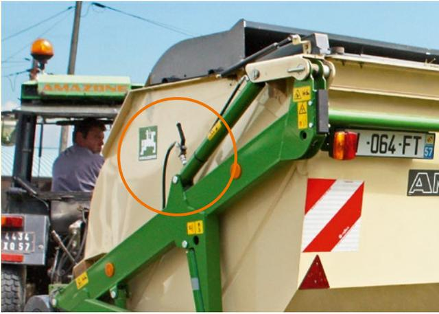
Hydraulische Zylindersperre für Grasshopper-Typen mit Hochkipptleerung
