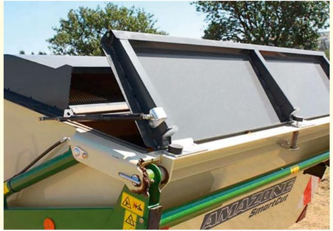
Dämpfer für die Entleerungsklappe
