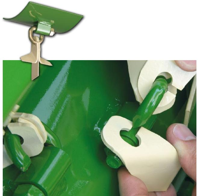
Werkzeugloser Umbau auf Vertikutieren – schnell gemacht
