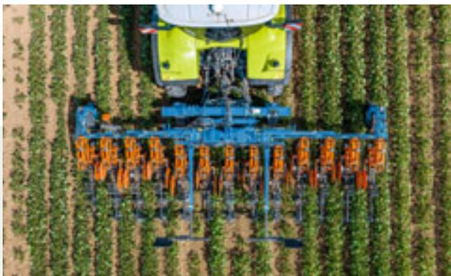
Dank des sehr großen Verschiebewegs von 600 mm wird die Hackmaschine bei Kurvenfahrten und am Hang zuverlässig zwischen den Reihen gesteuert.
