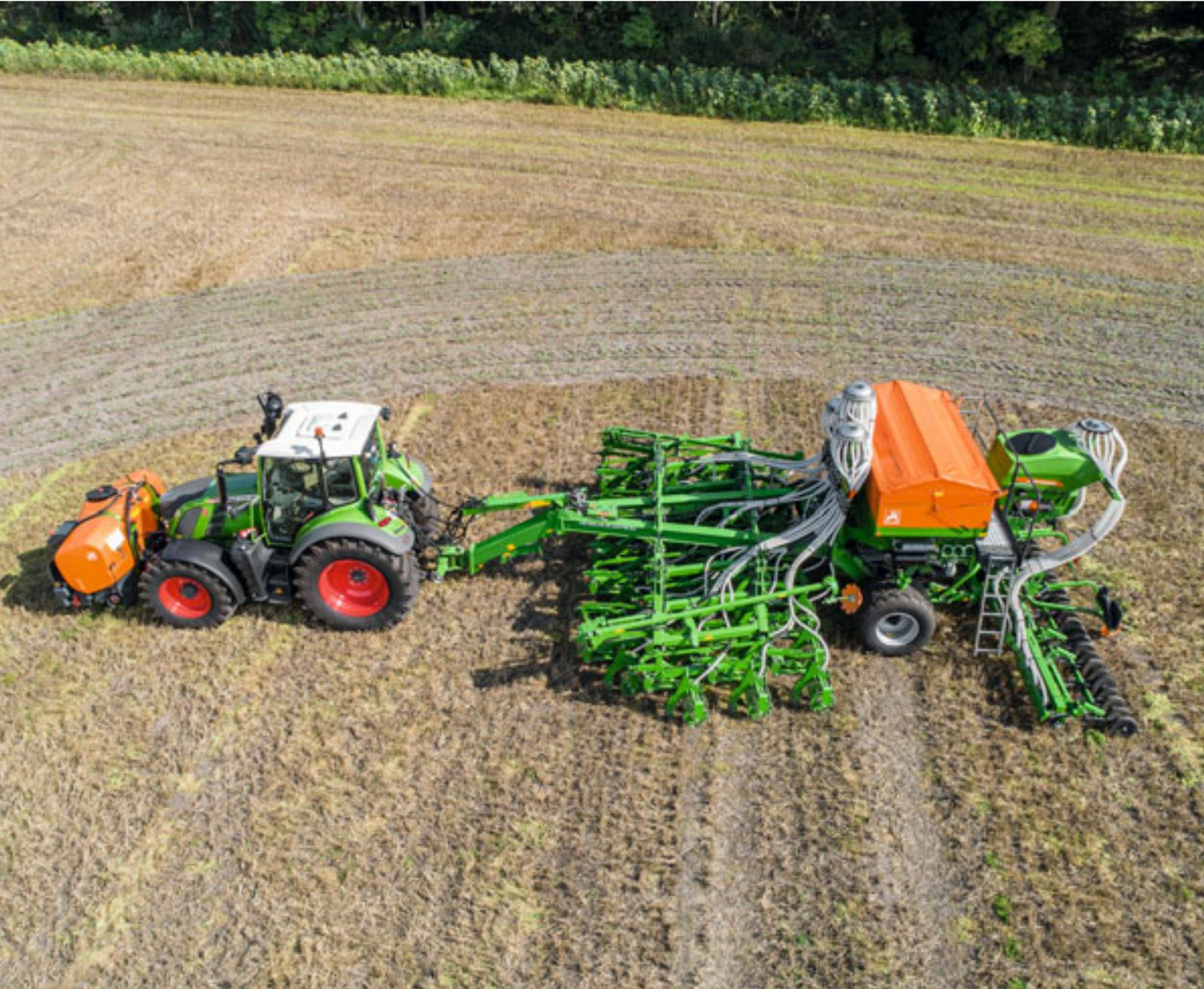
Die Kombination aus Fronttank FT-P 1502 und Primera DMC ermöglicht die Nährstoffinjektion direkt am Saatkorn.
