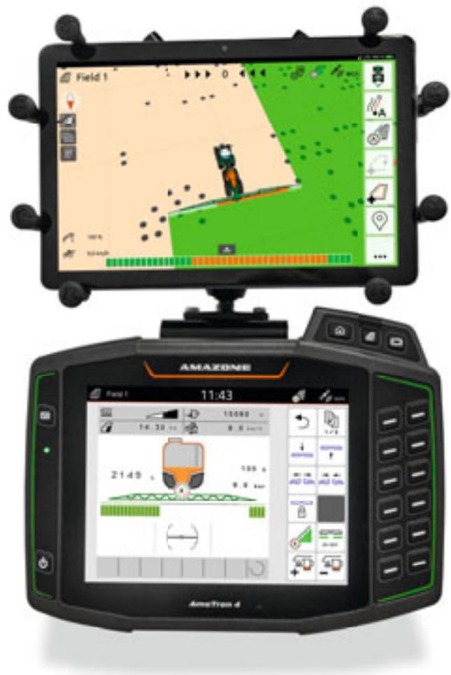
Komfortables Abarbeiten einer Spot-Applikationskarte. Neben der Maschinenbedienung im AmaTron 4 hat der Fahrer die Spot-Karte in der AmaTron Twin App stets im Blick
