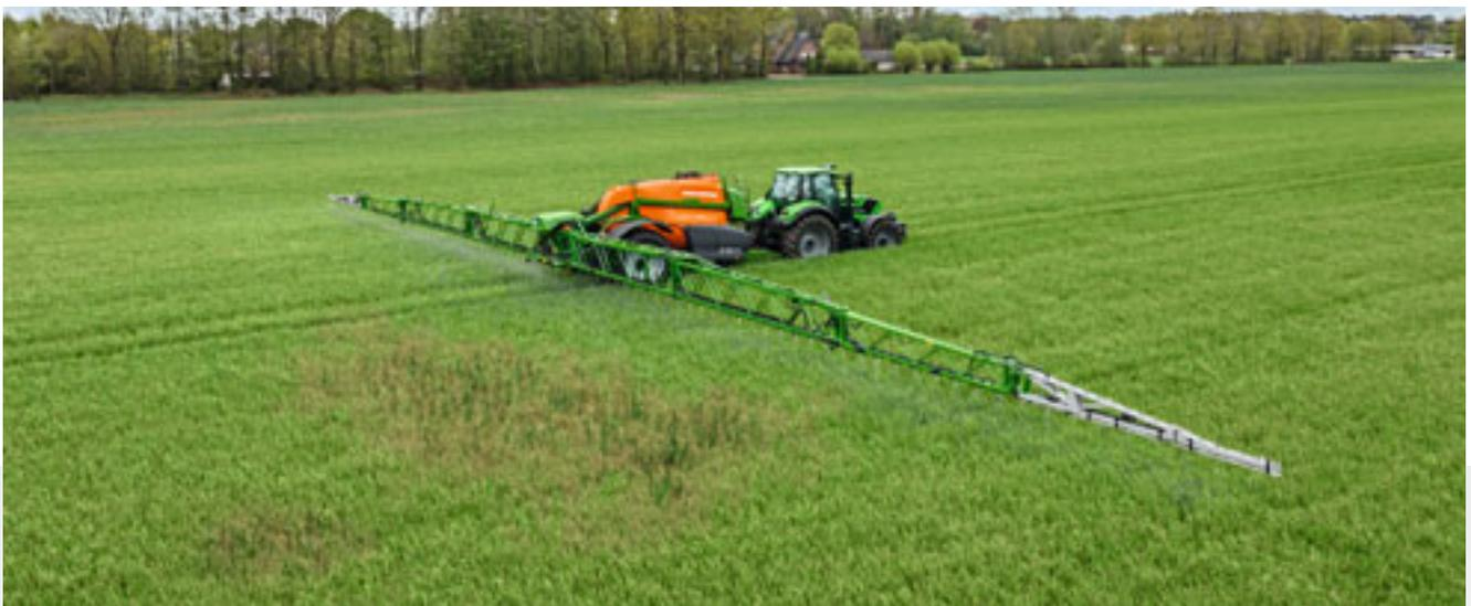
Mittels DirectInject und der Verwendung von Applikationskarten lassen sich Unkrautnester individuell und präzise in der Fläche behandeln.
