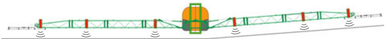
Einseitiges Anwinkeln rechts (Flex-Klappung)
