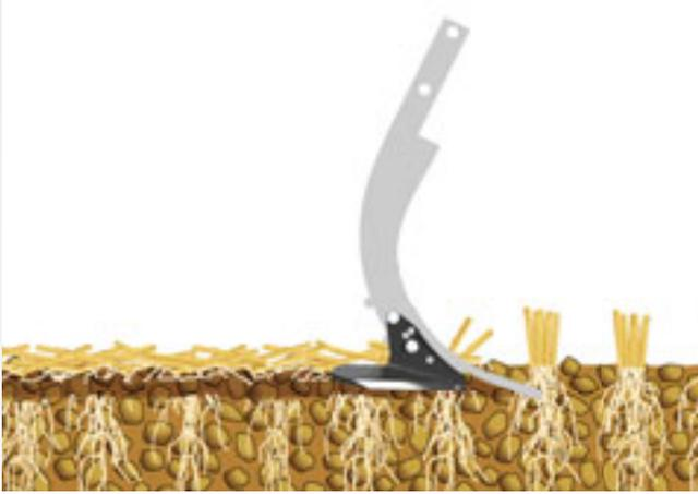
Das neue Flügelschar 360 ermöglicht ein flaches Arbeiten und Schneiden der Organik in Pos. 1.
