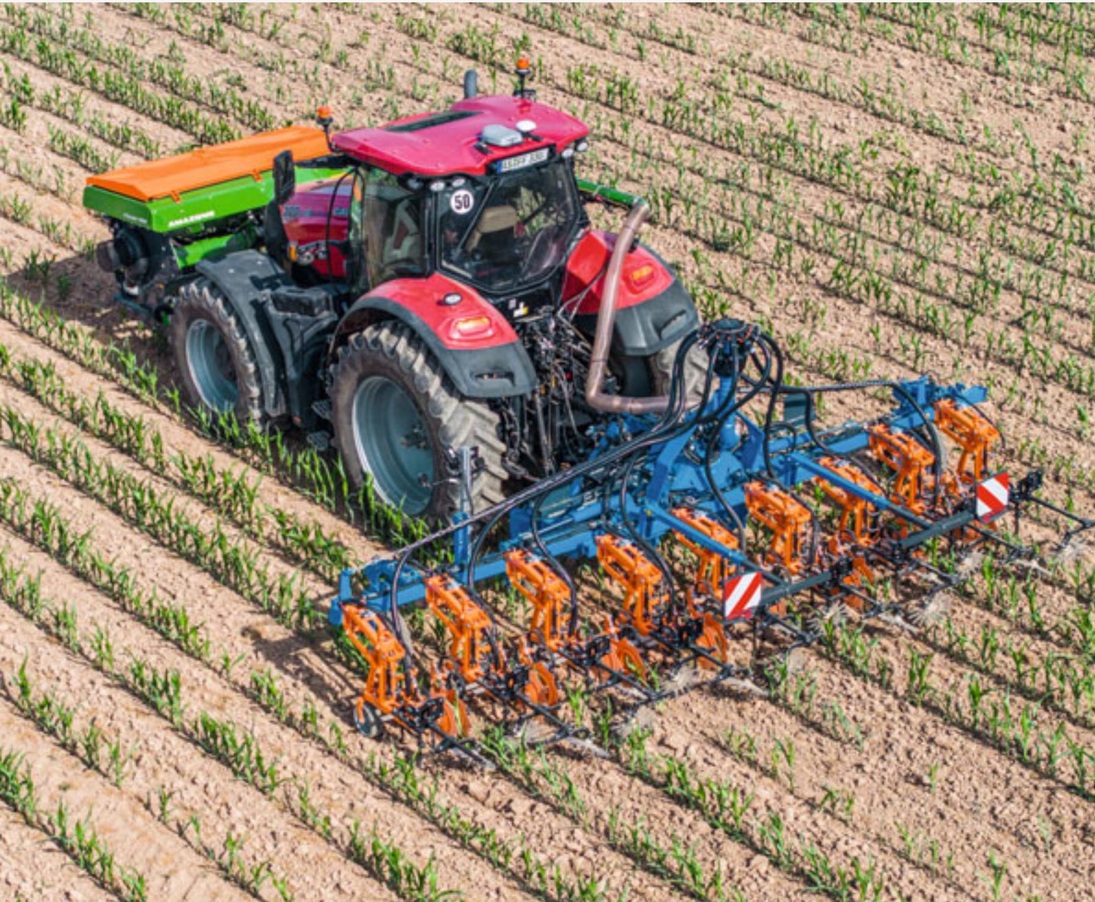
SCHMOTZER Hackmaschine Venterra 2K in Kombination mit dem AMAZONE Frontanbaubehälter FTender 1600 zur Unkrautbekämpfung und Düngung in einer Überfahrt.
