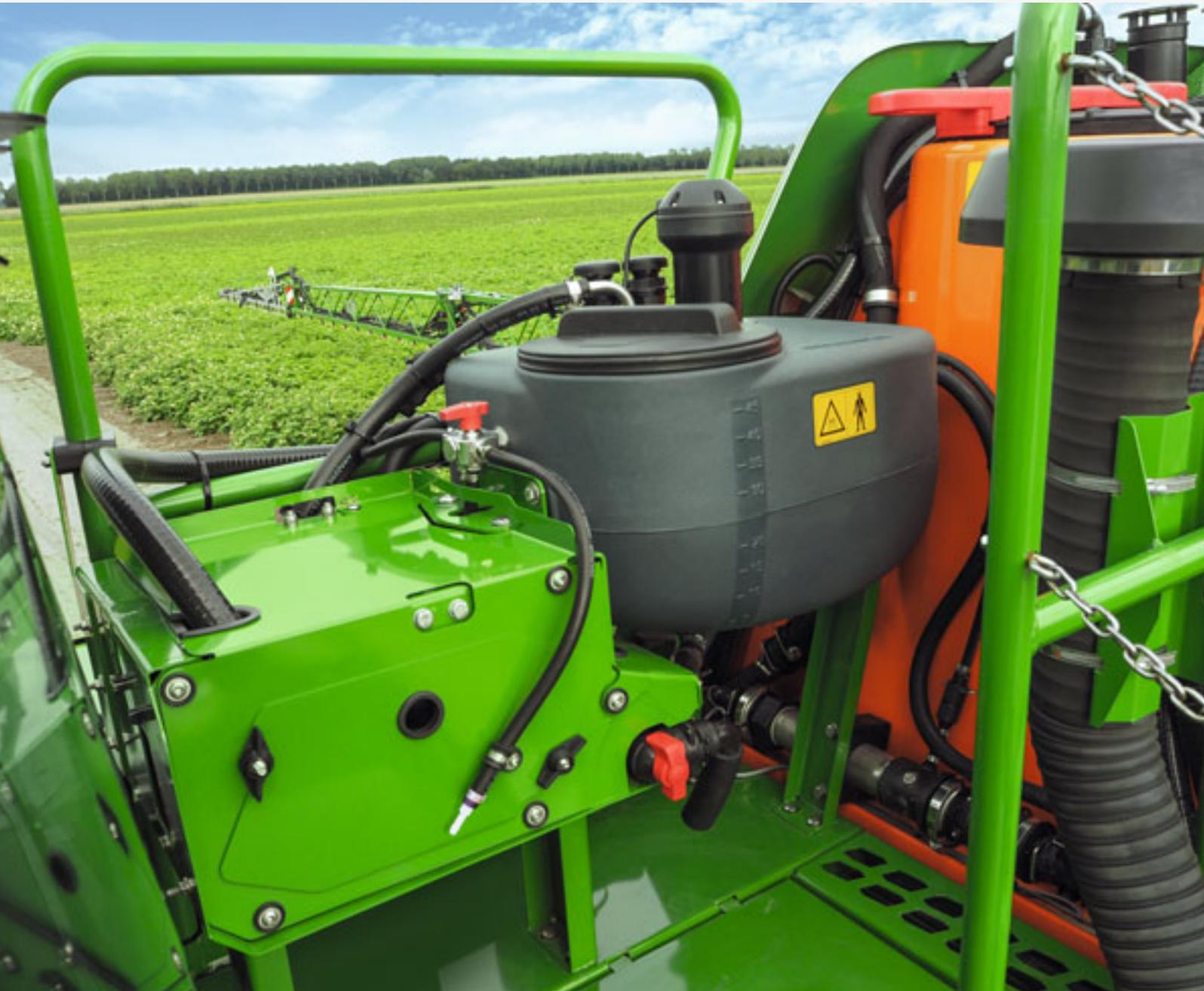
DirectInject auf der Pantera 4504 zwischen Kabine und Spritzflüssigkeitstank
