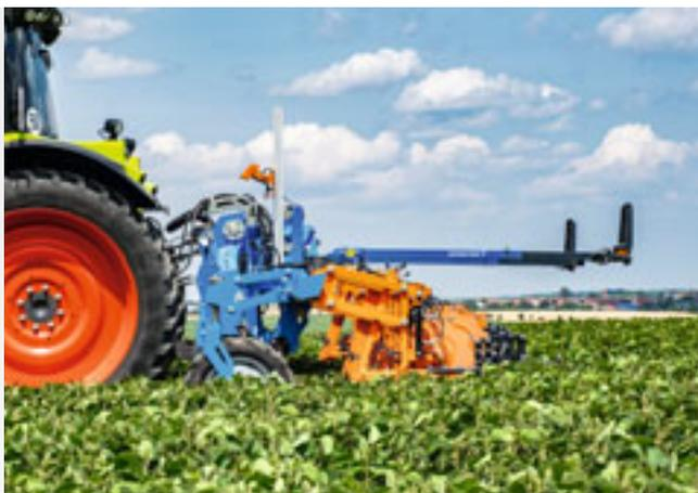
Durch die sehr geringe Bautiefe des Verschieberahmens sitzt der Schwerpunkt der Hackmaschine sehr nah am Traktor.
