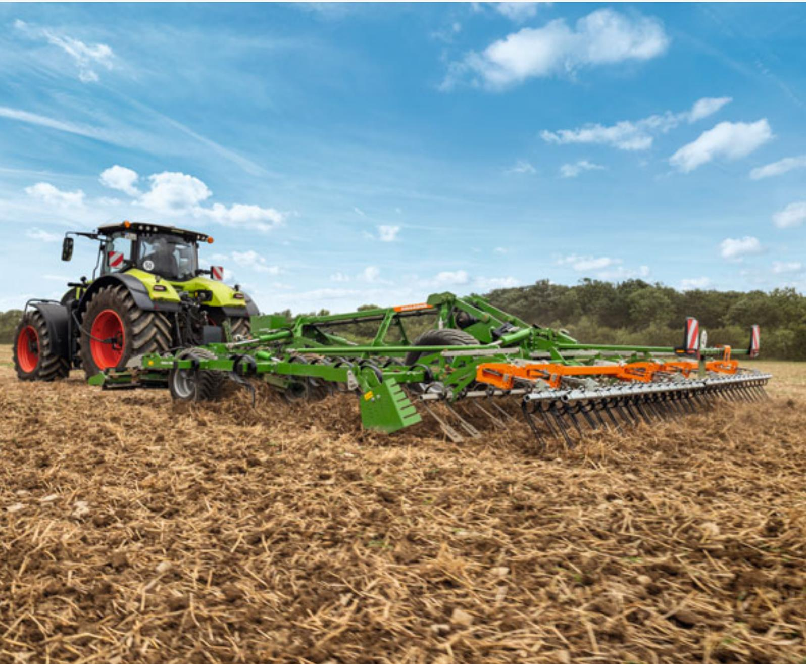
Der AMAZONE Cobra mit dem Doppelstriegel im zweiten Bearbeitungsgang zur Bekämpfung von Ausfallgetreide und Unkräutern
