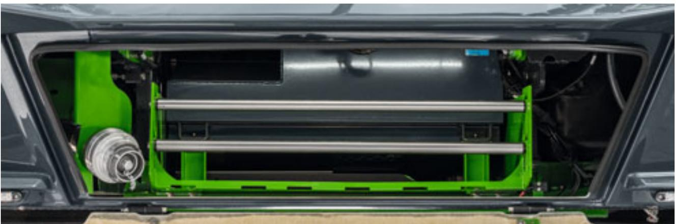
Beleuchtetes Ablagefach unter der Kabine mit Druckbefüllanschluss und automatischem Befüllstopp
