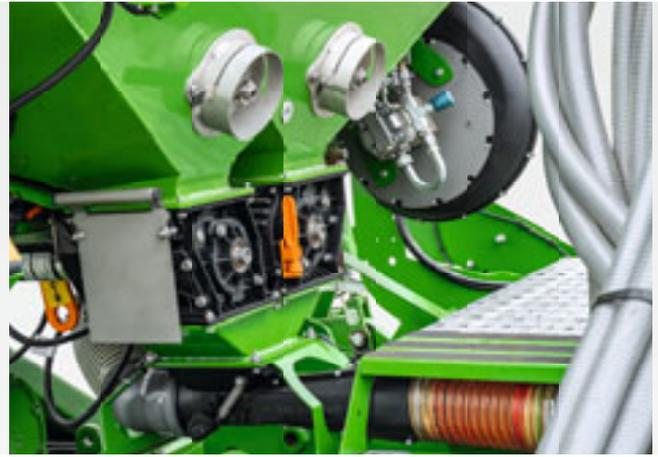
Beide Ausbringergüter werden einzeln über 2 Dosiereinheiten dosiert und über eine Förderstrecke zum Segmentverteilerkopf geleitet. Das bringt den Vorteil, dass die Dosierwalze für jedes Medium separat ausgewählt werden kann.
