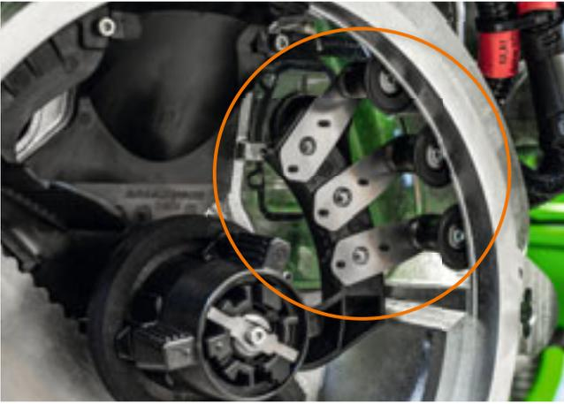
Die automatische Abstreiferverstellung SmartControl übernimmt die Einstellung der Abstreifer und entlastet damit den Fahrer enorm
