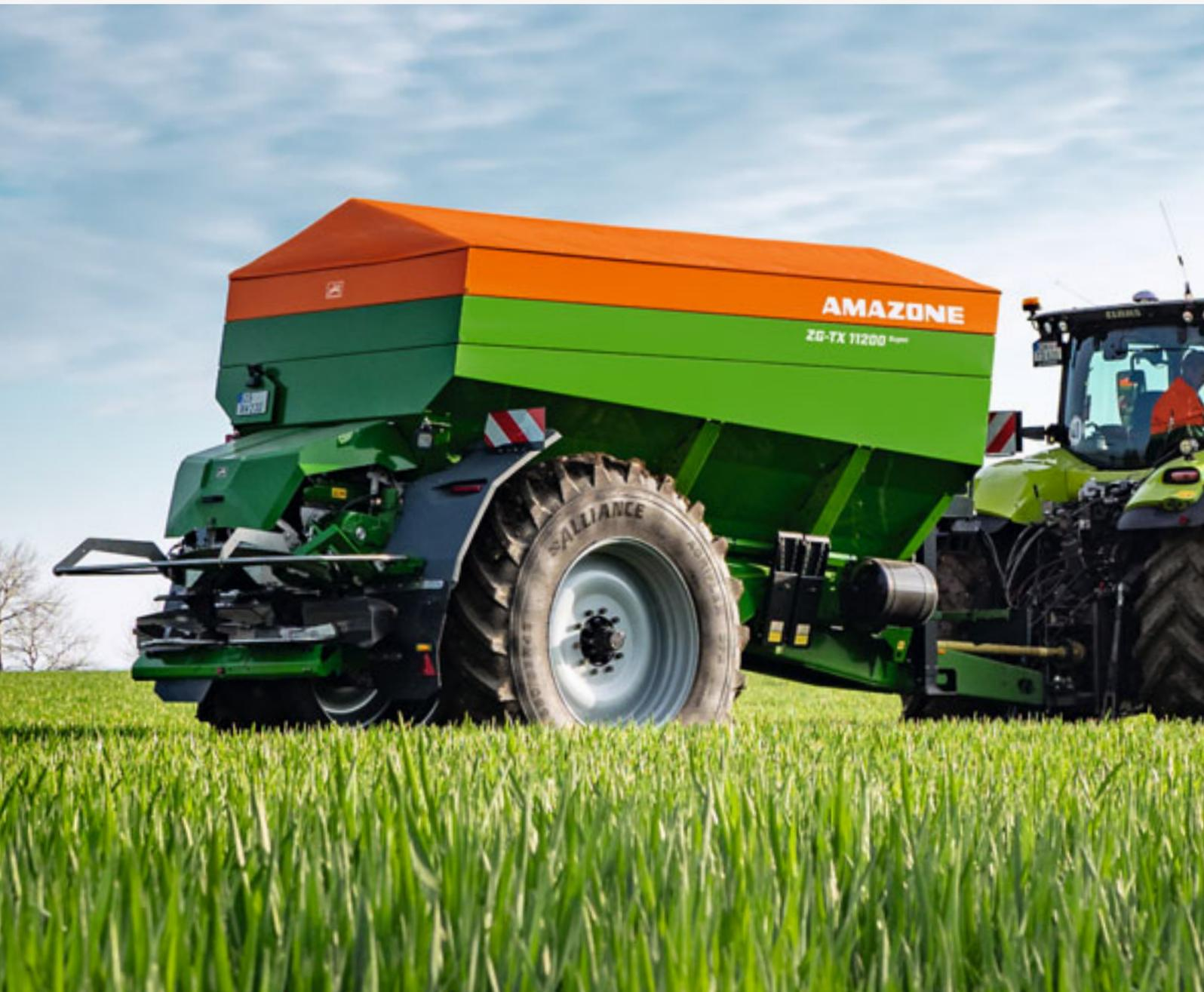
Der angehängte Kombistreuer ZG-TX 11200 Super mit maximalem Volumen bei großen Arbeitsbreiten
