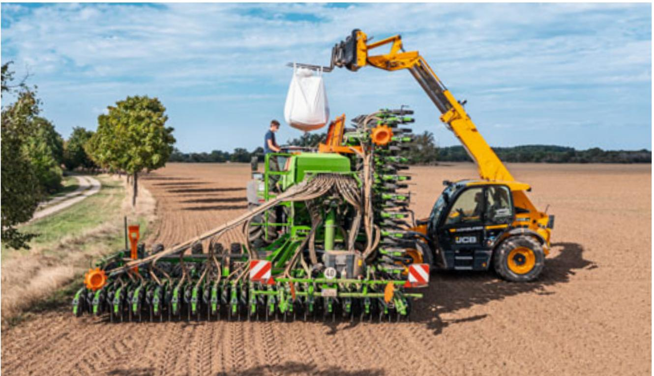
Die halbseitige Klappung beim Beladen reduziert die Überladeweite deutlich und ermöglicht die Befüllung der Maschine auch mit kleinen Teleskopladern
