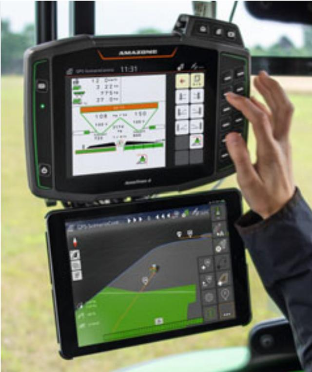
GPS-ScenarioControl wird in Verbindung mit dem ISOBUS-Bedienterminal AmaTron 4 und der App AmaTron Twin genutzt.
