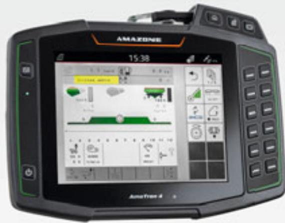
FertiSpot ist voll in die ISOBUS Software der Precea eingebunden. Über das AmaTron 4 lässt sich die Dosierung von Spotdüngung auf Bandablage umstellen.
