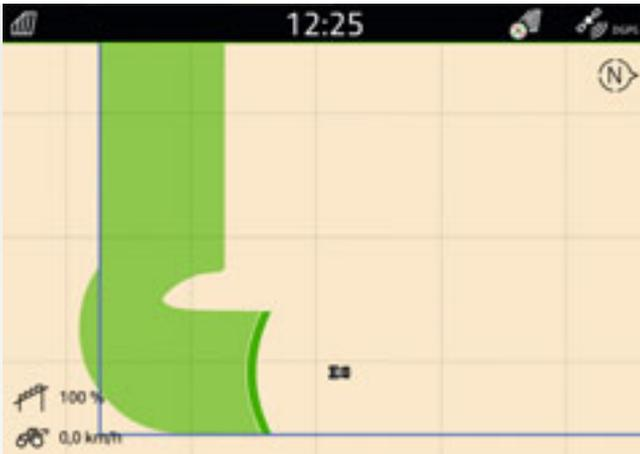
GPS-Ansicht in einer Kurve ohne CurveControl. Der Streufächer befindet sich viele Meter hinter dem Traktor und es kommt zu unerwünschten Schwenkbewegungen.
