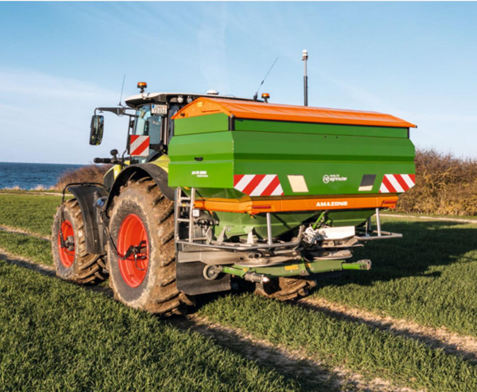
5.000 l Fassungsvermögen und 4.500 kg Nutzlast garantieren beim ZA-TS 5000 maximale Flächenleistung
