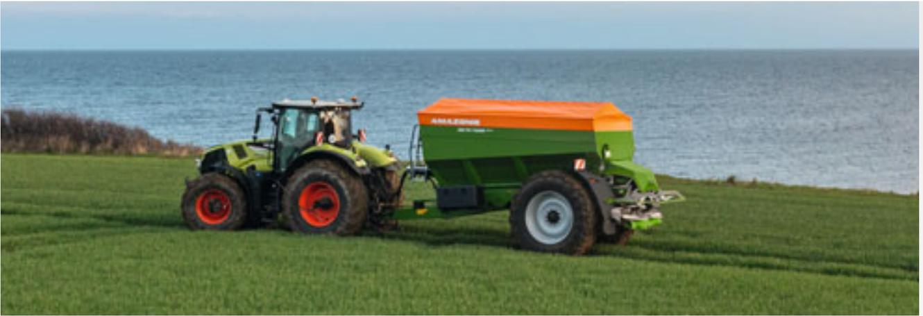
Das in Fahrtrichtung rechts verbaute Grenzstreusystem AutoTS generiert den maximalen Ertrag bis zur Feldgrenze und setzt neue Maßstäbe im Segment der Kombistreuer.
