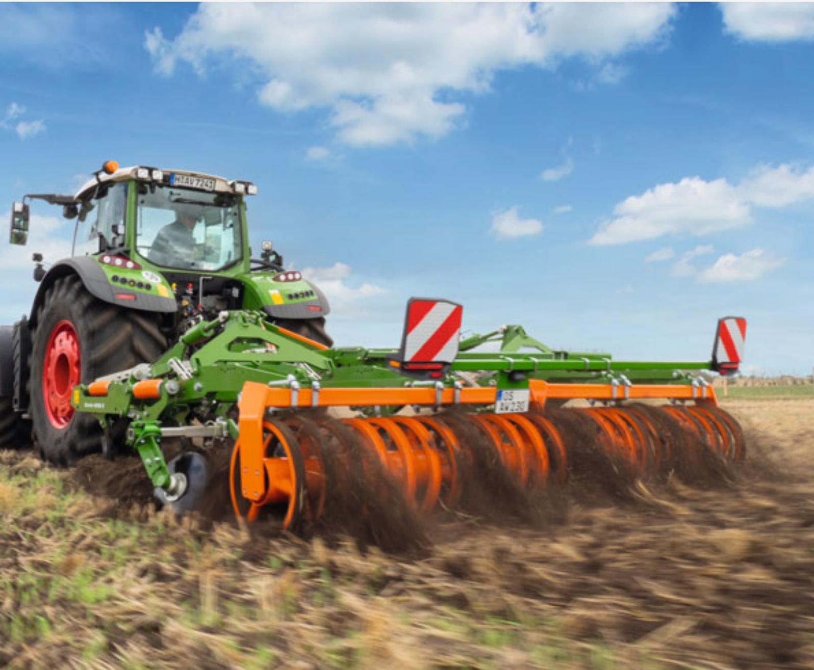
Passende Rückverfestigung für jeden Boden mit der großen Auswahl an Nachlaufwalzen
