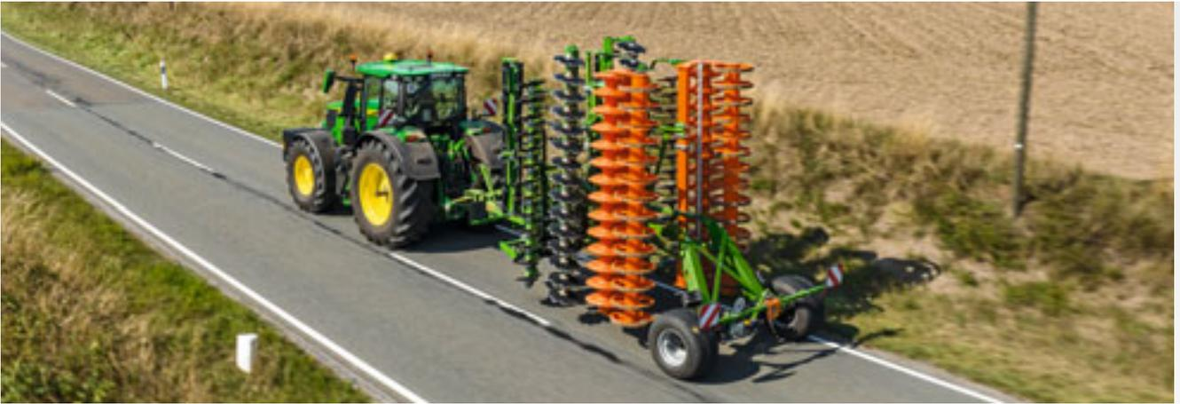
zeitig auch für eine hohe Haltbarkeit gesorgt. Durch die Einzelscheibenaufhängung liegen die Lager der Scheiben immer im Schatten des Erdflusses, um diese vor Verschleiß zu schützen und einen hohen Durchgang generieren zu können. Durch die vorgespannten Gummifederelemente und der Einzelscheibenaufhängung wird darüber hinaus eine optimale Bodenkonturanpassung bei wartungsfreien Überlastsicherungen erzeugt.
