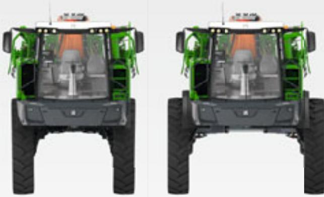
Fahrwerksvarianten mit hydraulischer Spurweitenverstellung
