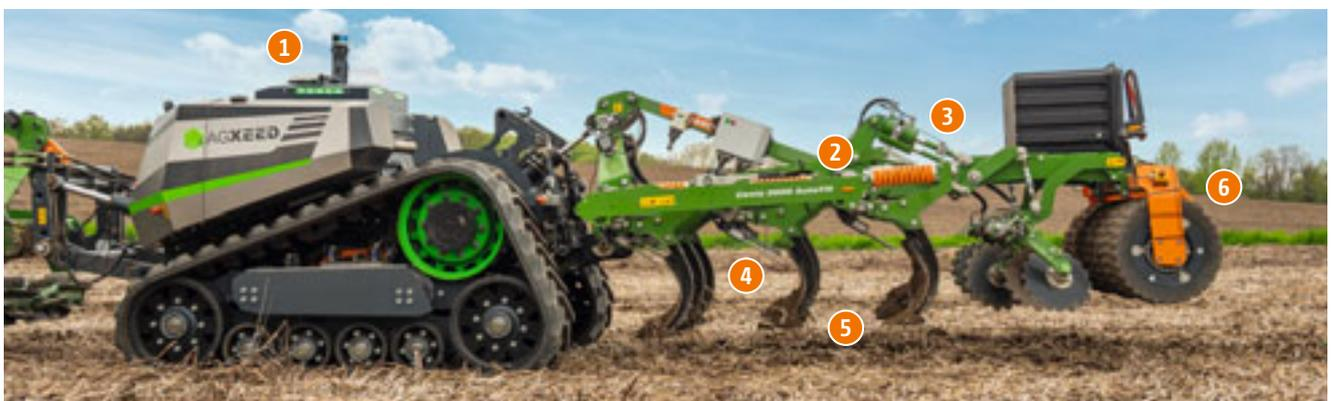
Verschiedene Sensoren helfen bei der Funktionsüberwachung der Maschine
