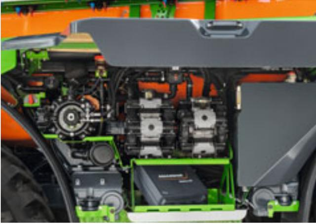
Leicht zugängliche Pumpeneinheit sowie zusätzliches Ablagefach
