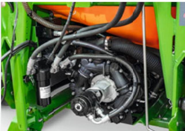
Hydraulischer Pumpenantrieb an der 300-l/min-Pumpe der UF 02
