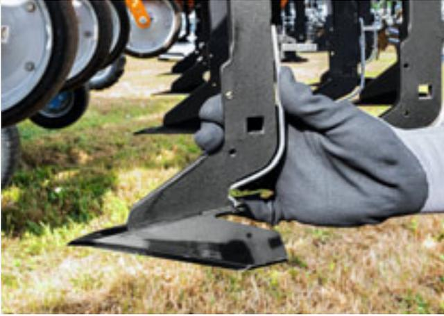
RapidoClip ist das erste werkzeuglose Schnellwechselsystem für Hackmesser.
