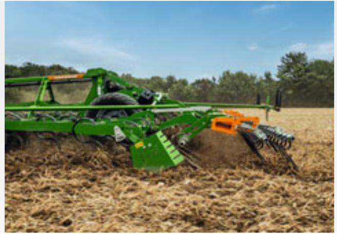
Dank des Doppelstriegels wird die Erde vom Ausfallgetreide getrennt und die Pflanzen oberflächlich abgelegt. Dort vertrocknen die Pflanzen durch die Sonneneinstrahlung
