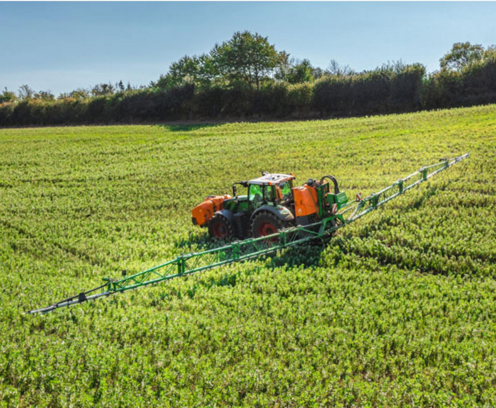
Kraftstoffsparender Einsatz einer UF 2002 mit hydraulischem Pumpenantrieb in hügeligem Gelände
