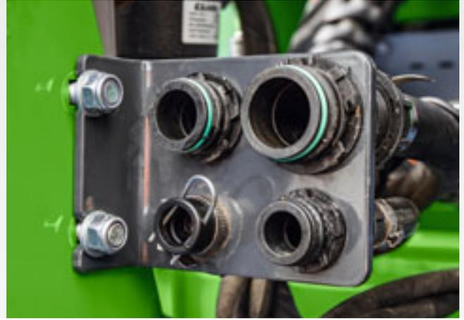
Schnittstelle zwischen Fronttank FT-P 1502 und Teilbreitenarmatur auf der Primera DMC.
