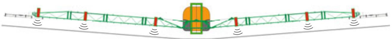
Beidseitiges Anwinkeln (Flex-Klappung)
