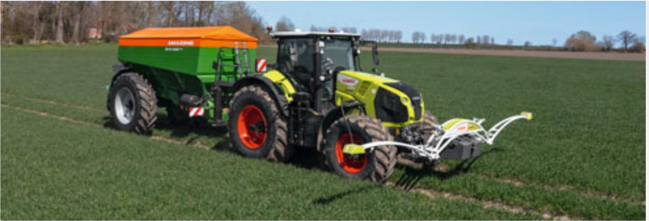
Das Zusammenspiel von Bandboden und Doppelschieber ermöglicht eine exakte seitenunabhängige Dosierung. Das zapfwellenbetriebene TS-Streuwerk garantiert präzise Streubilder bei Arbeitsbreiten bis zu 54 m.
