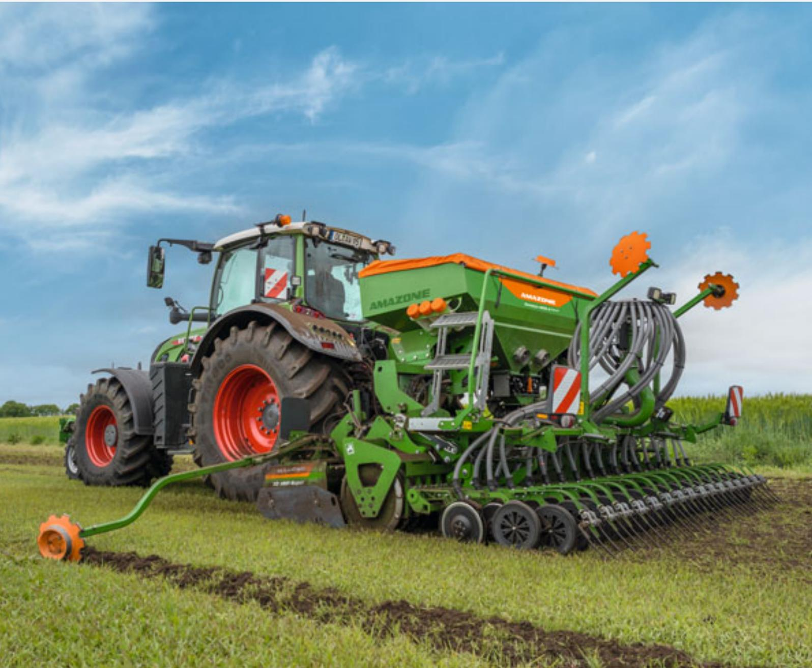
Centaya 4000-C Special aufgebaut auf einem Kreislergrubber KG 4001, der Boden wird gut gelockert und durchmischt und das Saatgut sauber über das TwinTeC-Doppelscheibenschar im Saathorizont platziert.
