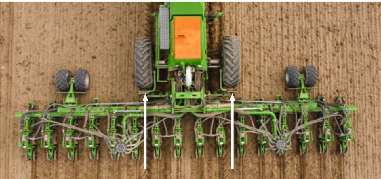
Gleichmäßige Feldaufgänge durch teleskopierbare Achse bei der die Reifen zwischen den Saatreihen laufen
