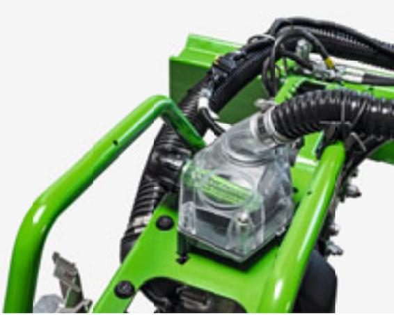
Die Beschickung der einzelnen Reihen aus dem zentralen Behälter regelt sich über das Central Seed Supply selbst
