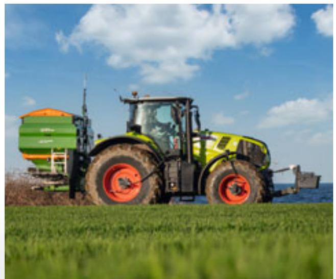
Der kompakte Traktoranbau erzeugt eine optimale Gewichtsverteilung auch großer Lasten
