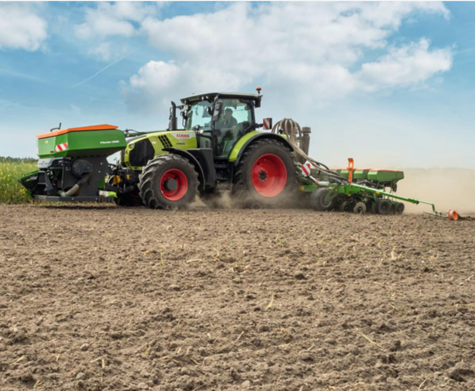
Precea 6000-2FCC mit dem FertiSpot Dosierer für portionierte Düngerabgabe. Der Dünger gelangt vom Frontbehälter FTender 2200 über die Düngerleitung ins Heck der Maschine und wird dort portioniert.
