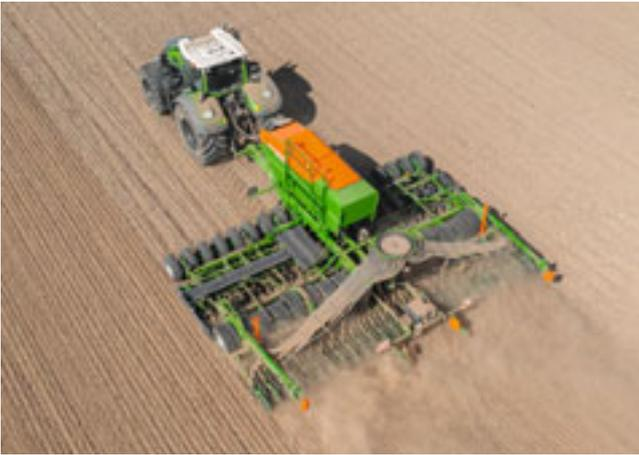
Die Arbeitsbreite von 9 m und hohe Arbeitsgeschwindigkeiten ermöglichen den schlagkräftigen Einsatz der Maschine
