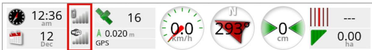
O painel de intensidade de sinal mostra a intensidade de sinal do GPRS e da rede sem fio.
