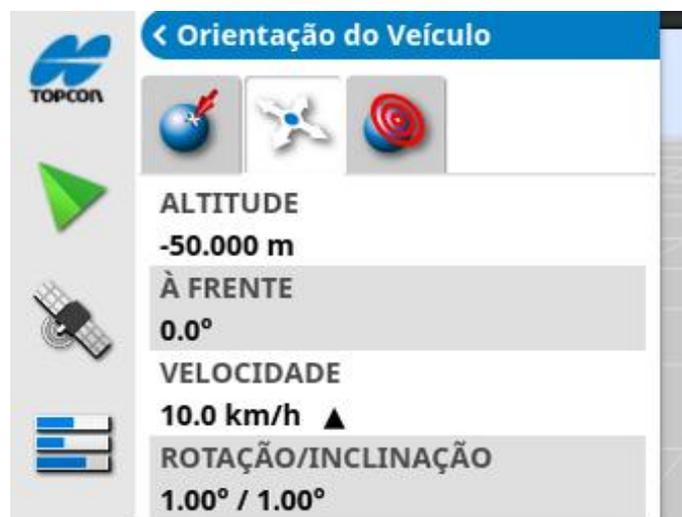
Ela mostra a altitude, a direção (graus), a velocidade real do veículo e a rotação/inclinação (graus). Rotação é a inclinação esquerda/direita do veículo. Inclinação é o desnível para frente/para trás do veículo.
