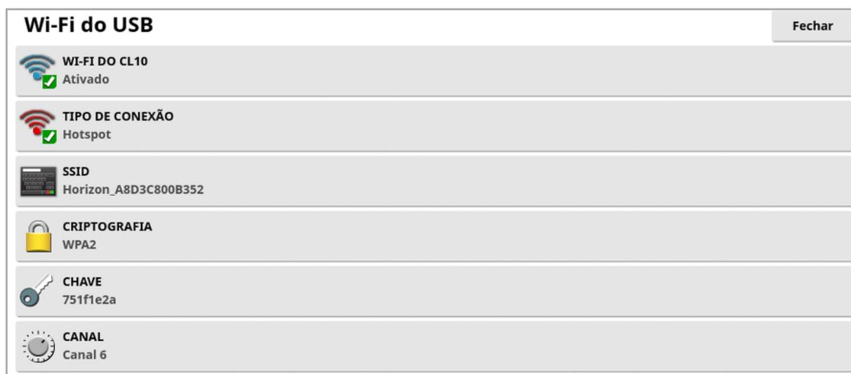
**Observação:** Quando o dongle USB estiver conectado, o modem de Internet (3G [se estiver usando um CL-10] ou LTE) estará sempre habilitado. Portanto, o suporte remoto e a TAP podem ser usados.
