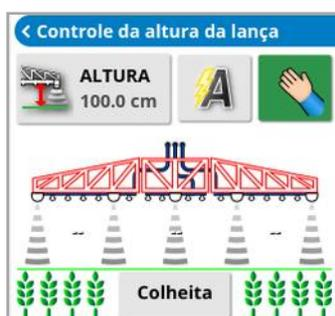
**Observação:** A configuração do sistema de controle de altura da lança deve ser realizada por meio da tela do TU. Consulte os manuais fornecidos com o sistema NORAC.
