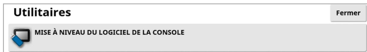
1. Pour mettre à niveau le logiciel, copiez les fichiers d'installation dans le répertoire racine d'un lecteur USB et insérez-les dans un écran en cours d'exécution.
