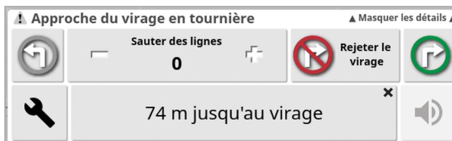
L'écran d'alarme peut être utilisé pour modifier la direction du virage, modifier le nombre de lignes à sauter ou annuler le virage. Appuyez sur l'alarme pour accepter le virage en tournière.
