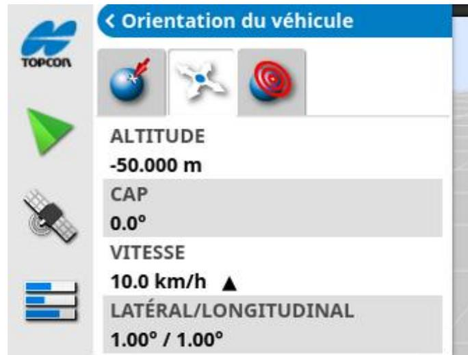
Celui-ci indique l'altitude, le cap (itinéraire, en degrés), la vitesse actuelle du véhicule et le roulis/tangage (latéral/longitudinal, en degrés). Le roulis est l'inclinaison droite/gauche du véhicule. Le tangage est l'inclinaison avant/arrière du véhicule.
