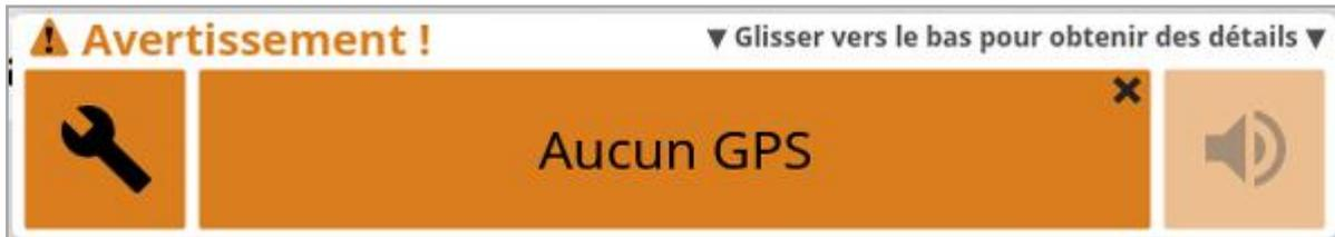
6. Pour confirmer la prise en compte de l'alarme, appuyez au centre de la fenêtre d'alarme.
