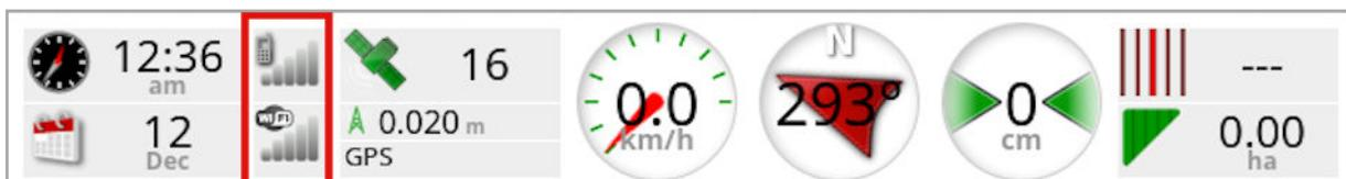
Le panneau de puissance du signal montre l'intensité des signaux GPRS et sans-fil.
