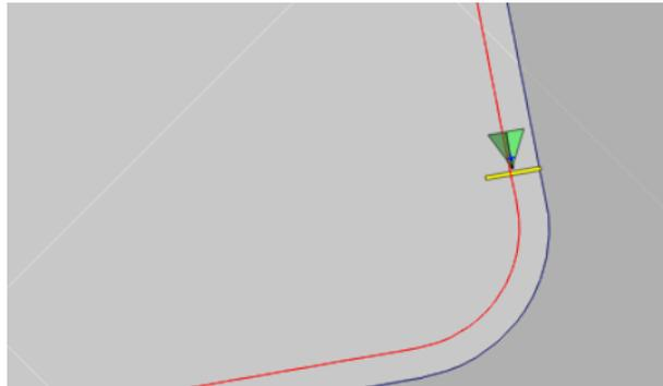
**Nota:** Compruebe que la pauta se coloca a una distancia suficiente del perímetro para evitar colisiones con vallas, etc.
