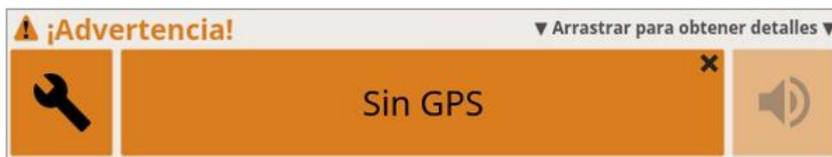
La ventana de alarma puede arrastrarse hacia abajo para mostrar detalles adicionales sobre la alarma si **Arrastrar para obtener detalles** se muestra en la parte superior de la ventana de alarma.
