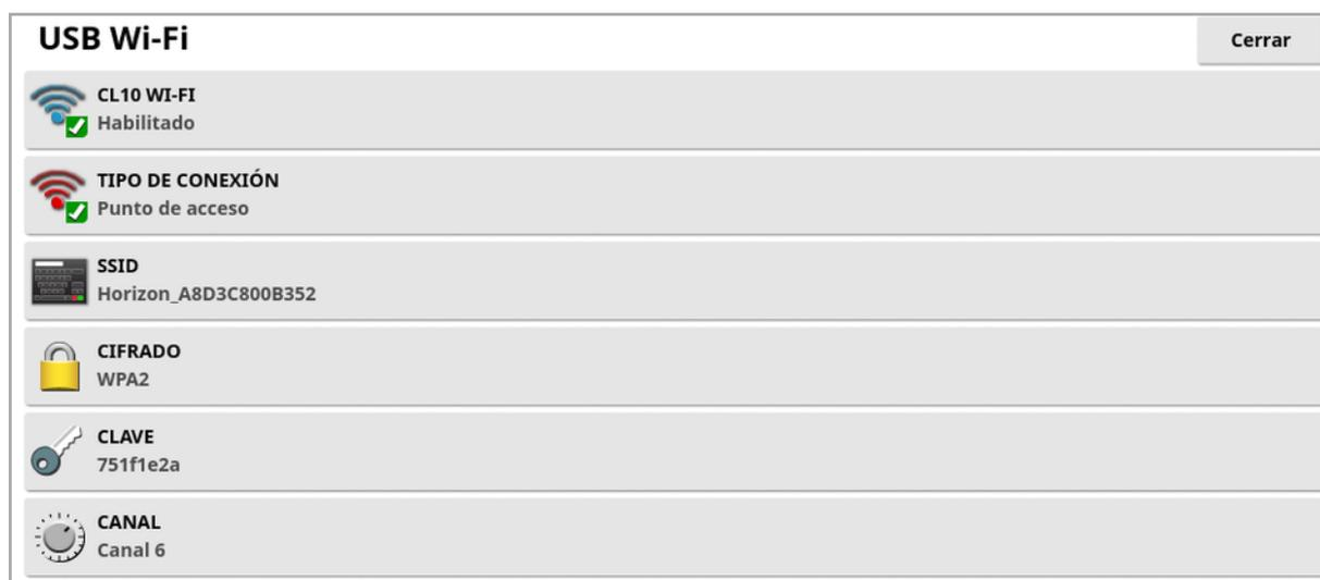
**Nota:** Una vez conectado el dongle USB, el módem de Internet (3G [si se utiliza un CL-10] o LTE) permanece siempre activado para que se puedan utilizar TAP y la función de asistencia remota.
