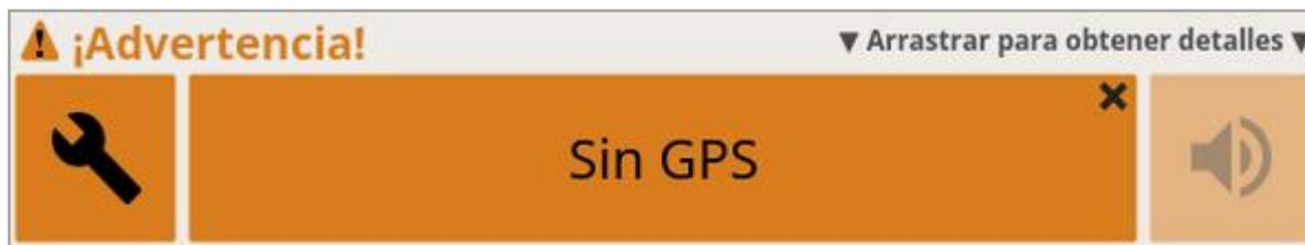
6. Para confirmar la alarma, pulse el centro de la ventana de la alarma.
