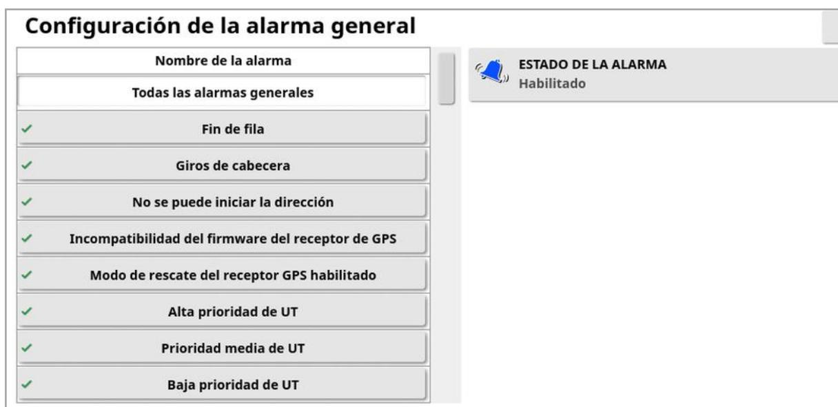
Aparece la lista de alarmas generales. Las alarmas generales se pueden activar o desactivar si se selecciona **Todas las alarmas generales**.
