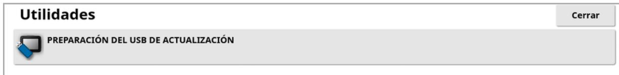
Esta opción se utiliza si el software de la pantalla se está actualizando a través de un dispositivo USB. Inserte el USB y seleccione esta opción para ejecutar una secuencia de comandos que permita al USB realizar una actualización del software. Se mostrará un mensaje de reinicio para realizar la actualización inmediatamente, o podrá realizarla la próxima vez que conecte el USB a una pantalla y la encienda. Consulte [Instrucciones de actualización de software, página 23](#).
