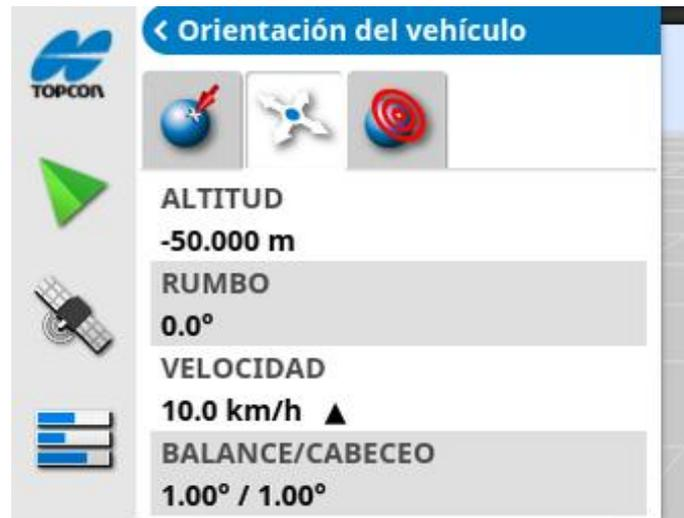
En esta ficha aparece la altitud, el rumbo (grados), la velocidad real del vehículo y el balance/cabeceo (grados). El balance es la inclinación del vehículo hacia la derecha o hacia la izquierda. El cabeceo es la inclinación del vehículo hacia delante o hacia atrás.
