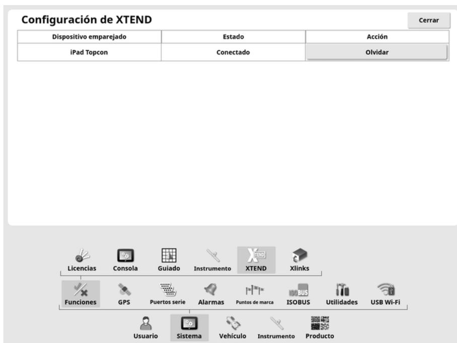
La opción **Olvidar** impide que un dispositivo externo se vuelva a conectar a esta pantalla a través de XTEND, a no ser que el operador de la pantalla confirme la conexión.
