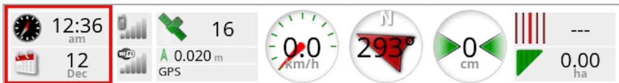
La hora se ajusta mediante la pantalla de configuración, **Usuario / Región / Hora/Fecha**. La fecha se obtiene a través de la señal GPS.
