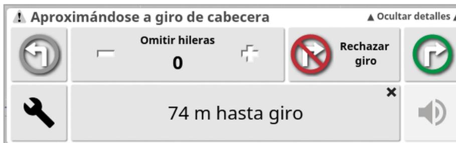
La pantalla de alarma se puede utilizar para cambiar la dirección del giro, cambiar el número de hileras que se deben omitir o cancelar el giro. Al pulsar la alarma, se acepta el giro de cabecera.
