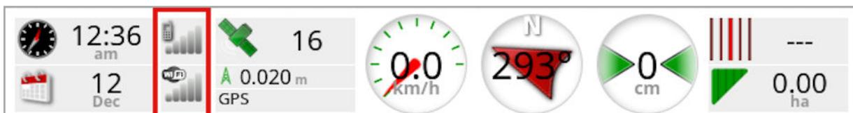
El panel de intensidad de la señal muestra la intensidad de la señal GPRS e inalámbrica.
