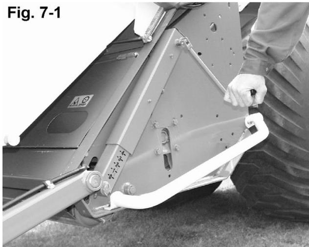
При повороте по часовой стрелке опорный ролик втягивается, тем самым уменьшая высоту среза; при повороте против часовой стрелки опорный ролик выдвигается и увеличивает высоту среза (см. рис. 7.1-2).
