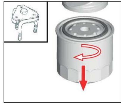
Sostituire il filtro a cartuccia del carburante
