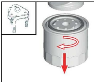
Sostituire il filtro a cartuccia dell'olio lubrificante
