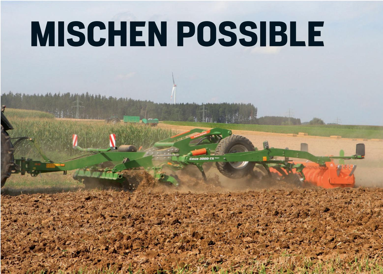
Die Scheiben schneiden, mischen und krümeln den Boden bis 14 cm tief. Der Grubber kann je nach Schartyp von flach bis 30 cm Tiefe arbeiten.
