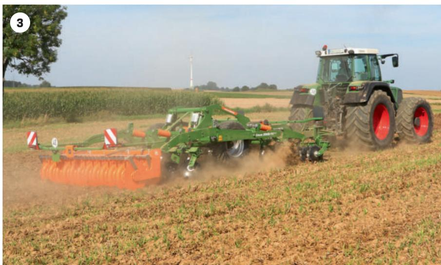
So müssen die Randscheiben des Scheibenfelds vor dem Arbeiten herunter geklappt werden, ein notwendiges Übel, das der Straßenverkehrsordnung geschuldet ist. Um das Klappen möglich einfach zu machen, gibt es jetzt einen praktischen Stecker, der mit einer Hand bedient werden kann und ohne Splint auskommt.
