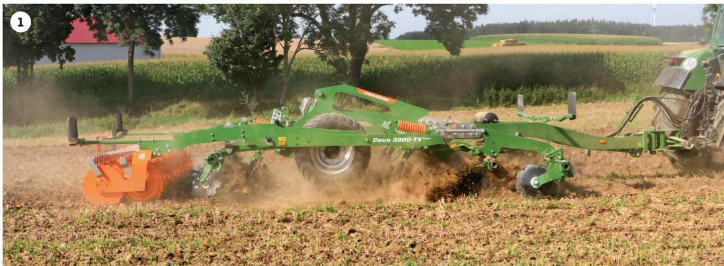
**1** Der Ceus 3000-TX wird über die Unterlenker und die Walze im Heck in der Tiefe geführt. Die Arbeitstiefe des Grubbers wird über Bolzen, die des Scheibenfelds, hydraulisch verstellt.
