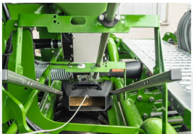
Vasca di calibrazione in posizione di calibrazione
