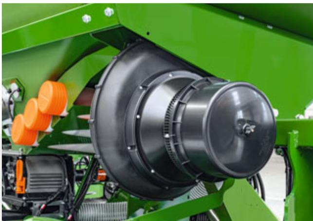
Il ciclone separatore opzionale riduce il carico da polvere
