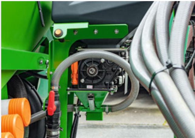
Il dosaggio viene effettuato comodamente mediante un dosatore elettrico situato subito sotto la tramoggia della semente
