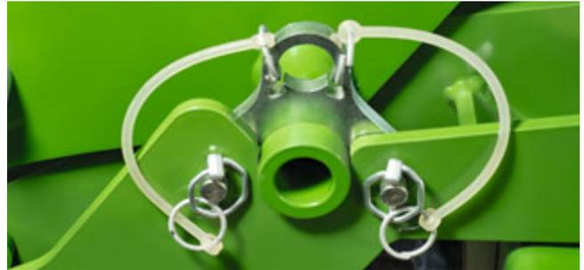
I tre punti di accoppiamento facilmente accessibili del sistema QuickLink assicurano un accoppiamento e distacco sicuro, veloce e senza utensili.
