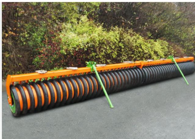
❗ « Grâce aux pinces vissées, le rouleau est très facile à démonter lorsque les conditions sont humides ou pour un sillon approximatif à l'automne »
