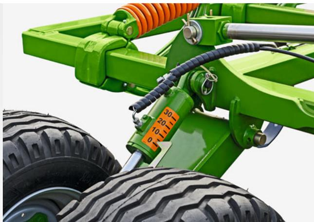
Echelle graduée du réglage hydraulique de la profondeur de travail du compartiment de dents
