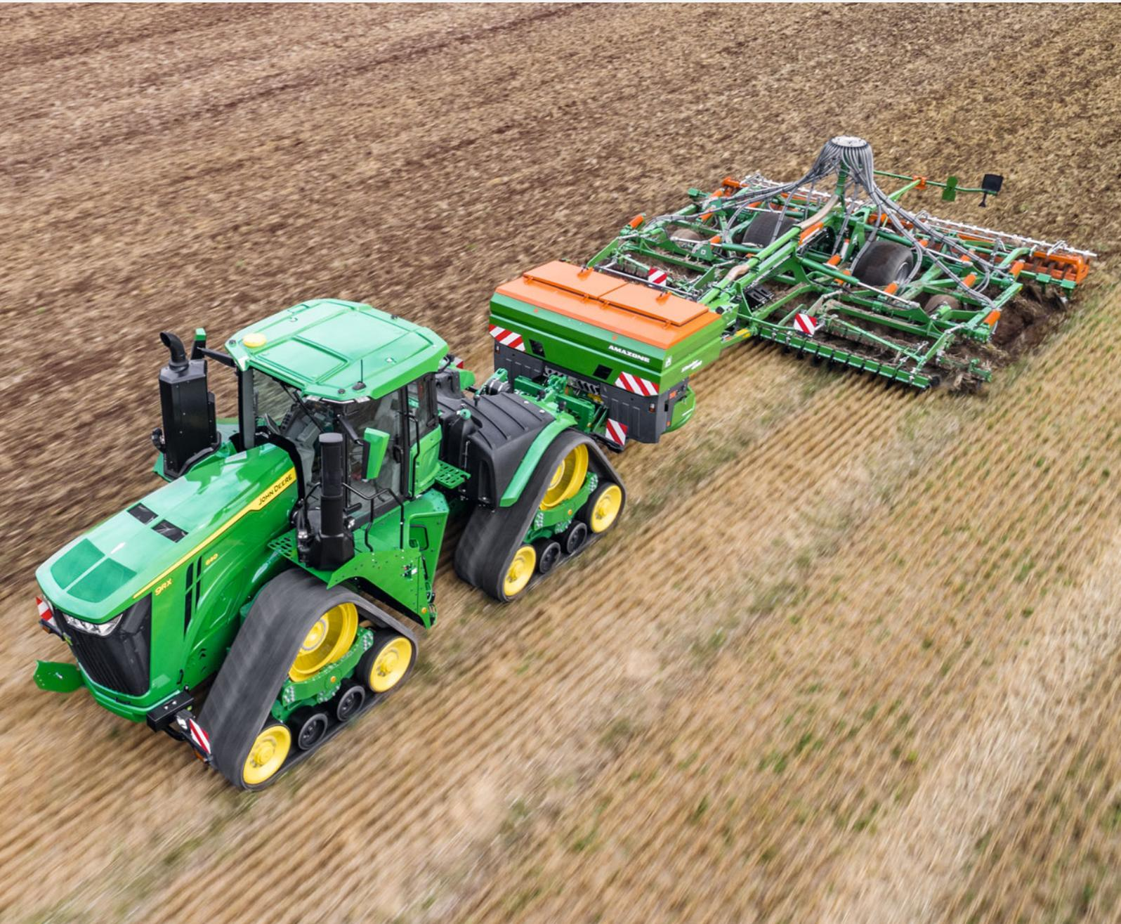
XTender 4200 avec une capacité de trémie de 4 200 l
