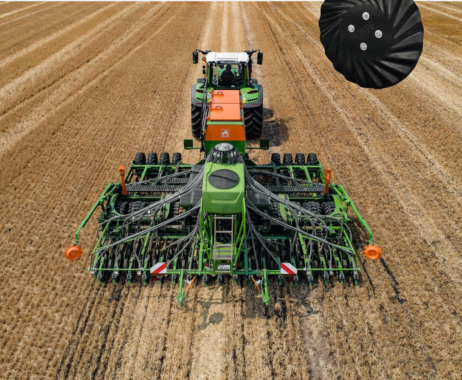
Movimento del terreno minimo e con impiego ridotto di acqua mediante lavorazione a fasce con il disco ondulato Minimum TillDisc.
