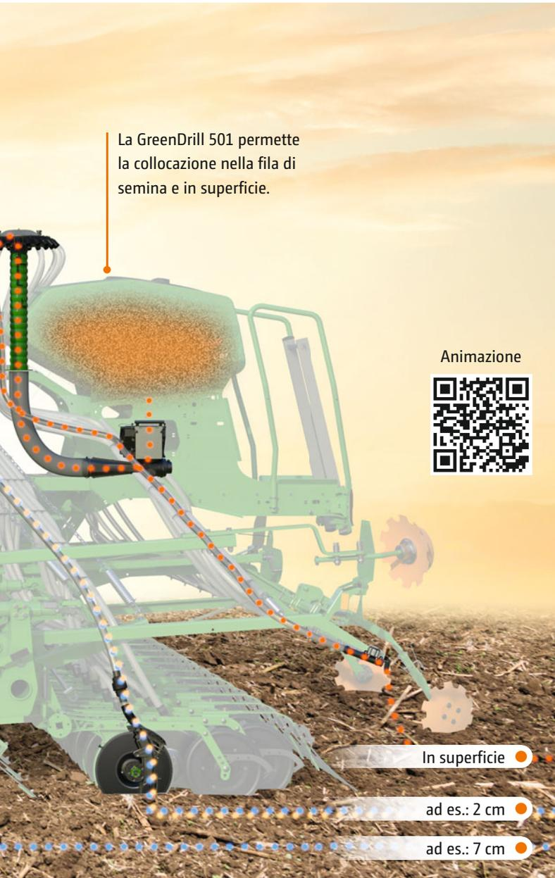
La GreenDrill 501 permette la collocazione nella fila di semina e in superficie.
