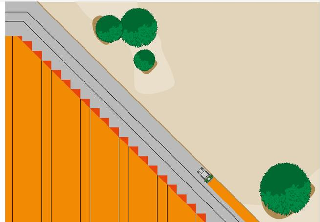
Attivazione e disattivazione automatiche del dosatore elettrico con GPS-Switch, in funzione della posizione
