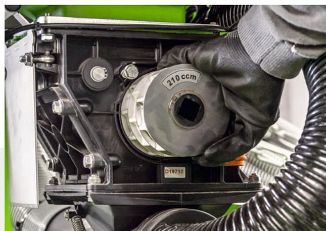
Facile sostituzione del cilindro dosatore
