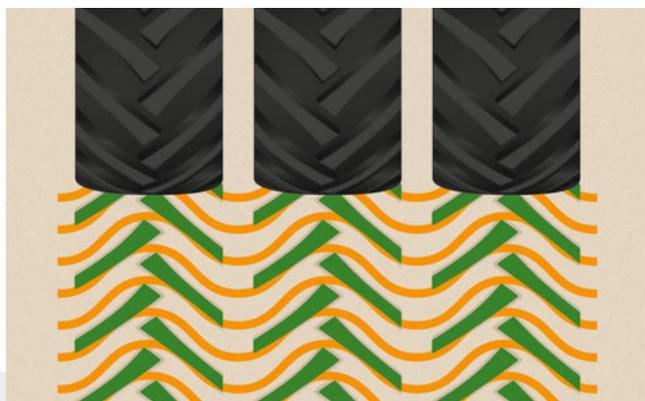
Ricompattamento con ruote AS: rispetto alle ruote Matrix, la ruota AS presenta un disegno di lavoro molto più semplice. Un'alternativa semplice per i terreni non molto sensibili.
