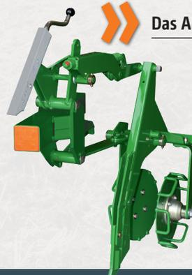
Die einzeln im Parallelogramm aufgehängten Meißelschare ermöglichen eine sehr präzise Ablage des Saatgutes bei Geschwindigkeiten von bis zu 18 km/h und sehr gleichmäßige Feldaufgänge.
