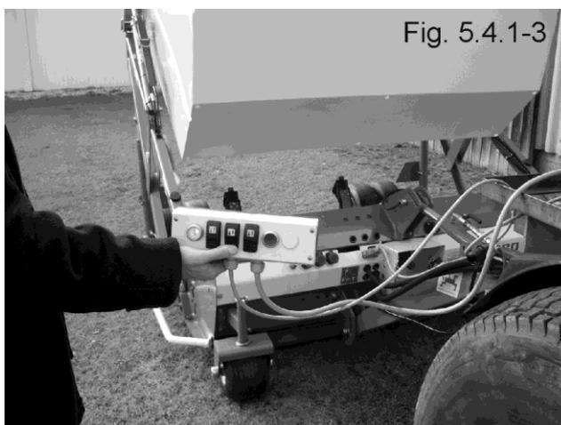
Si un commutateur est relâché pendant la commande, le bloc hydraulique se verrouille et la machine maintient sa position actuelle.
