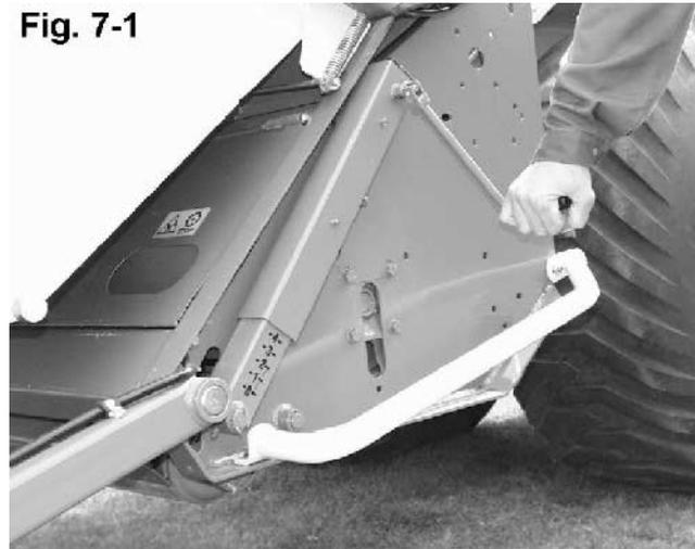
Lorsque la manivelle est tournée dans le sens des aiguilles d'une montre, le rouleau d'appui est rentré et la hauteur de coupe est réduite ; lorsque la manivelle est tournée dans le sens contraire des aiguilles d'une montre, le rouleau d'appui est sorti et la hauteur de coupe est donc augmentée (voir fig. 7.1-2).
