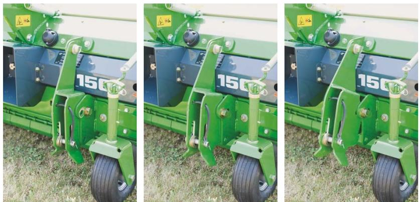
**Der Durchmesser der Unterlenkerbolzen entspricht KAT I.**
