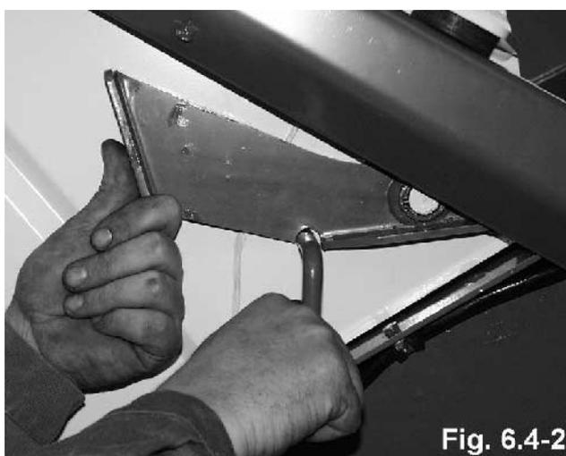
La machine doit toujours être relevée ou abaissée de manière uniforme, c.-à-d. qu'il faut veiller à maintenir une position la plus horizontale possible à chaque phase. En cas de relevage plus important sur un côté vers l'avant ou l'arrière, l'arbre à cardan peut être endommagé lorsque la machine est en marche.
