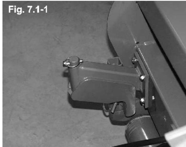
Pour régler la hauteur, enlevez la goupille et l'axe de chaque côté après avoir relevé la machine et amenez le rouleau à la position souhaitée. Puis bloquez l'axe à l'aide de la goupille. (fig. 7.1-2).
