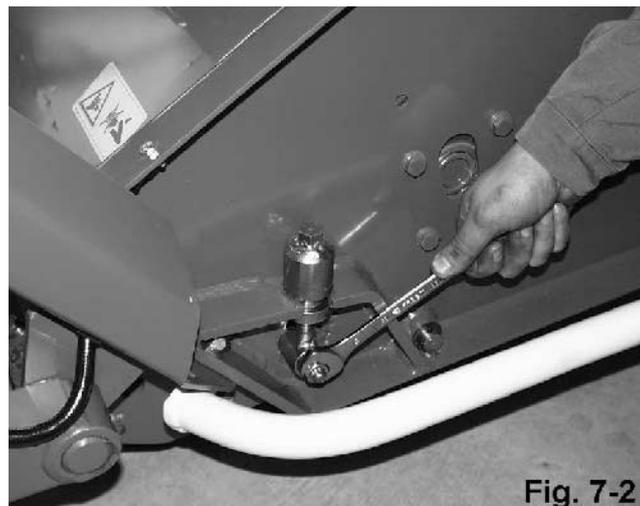
5. amenez le rouleau d'appui à la position souhaitée en tournant les vis de réglage (fig. 7-3),
