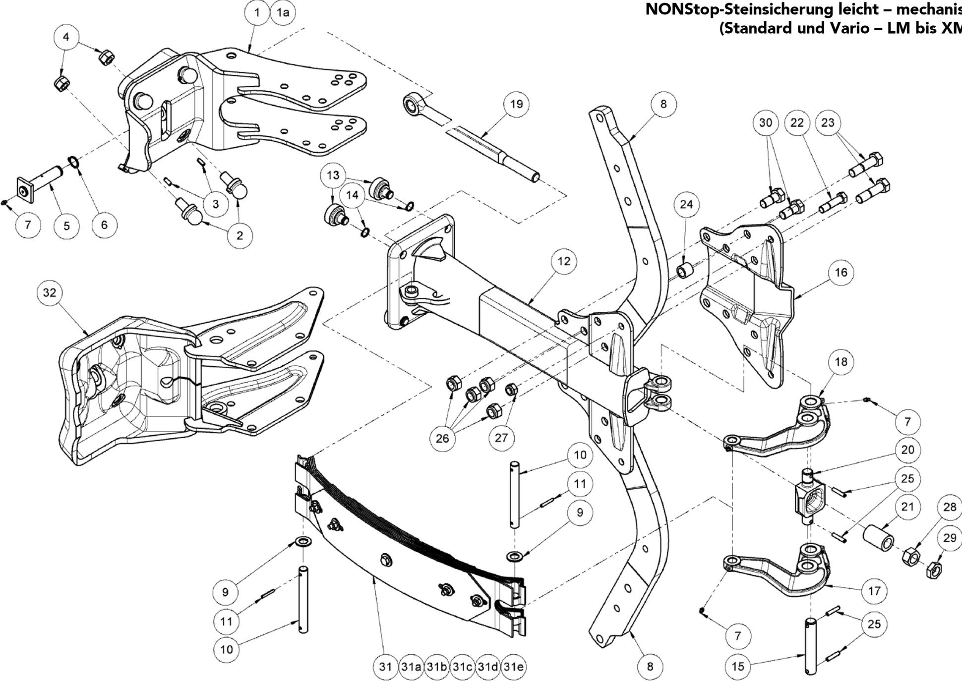
**NONStop-Steinsicherung leicht - mechanisch**
