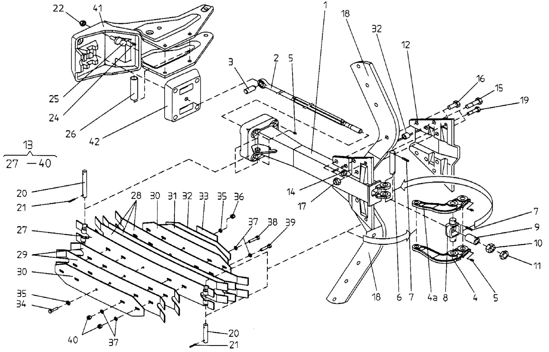
**NON-Stop-Steinsicherung VARIO (schwer, mechanisch)**
