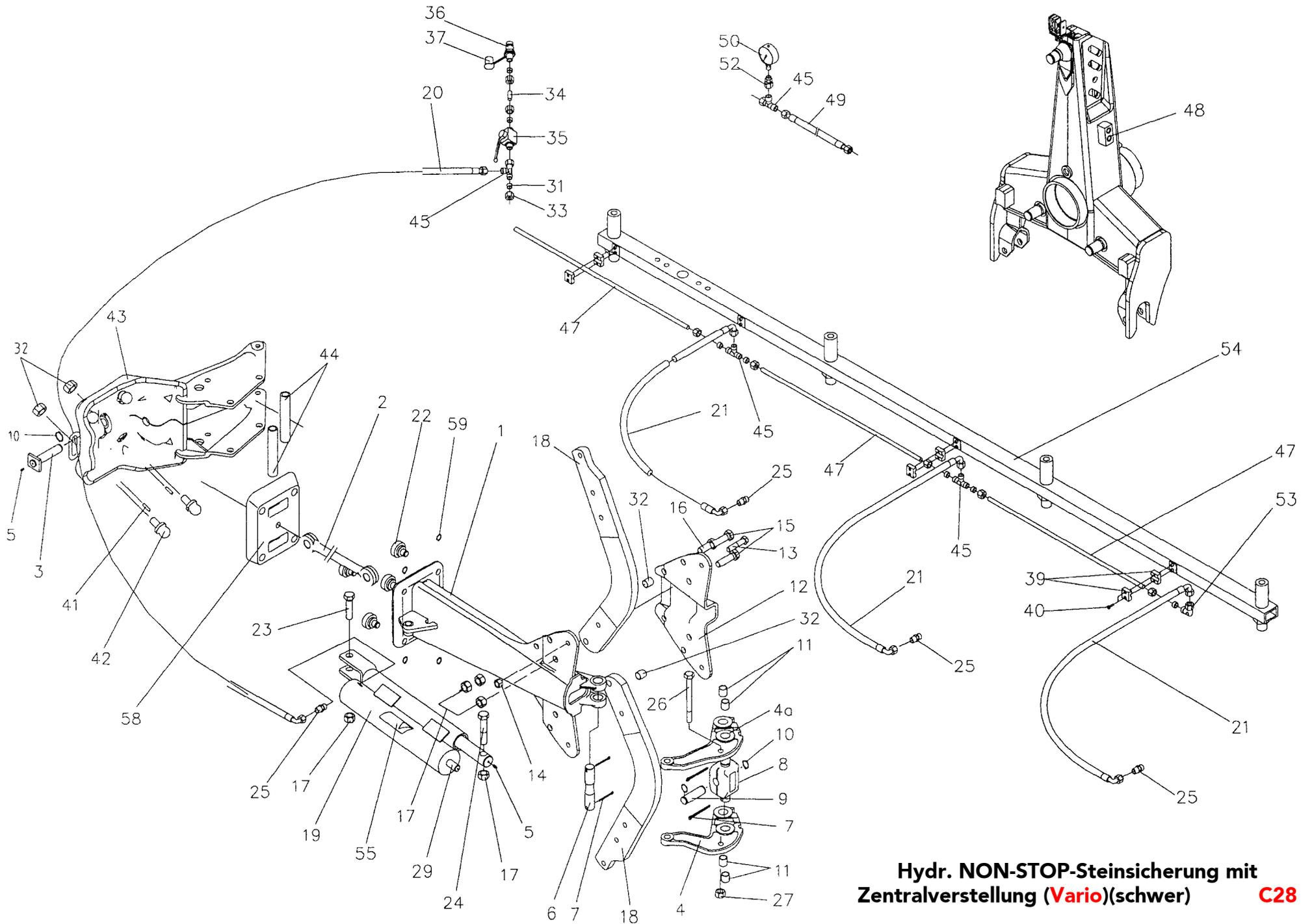
**Hydr. NON-STOP-Steinsicherung mit Zentralverstellung (Vario)(schwer) C28**
