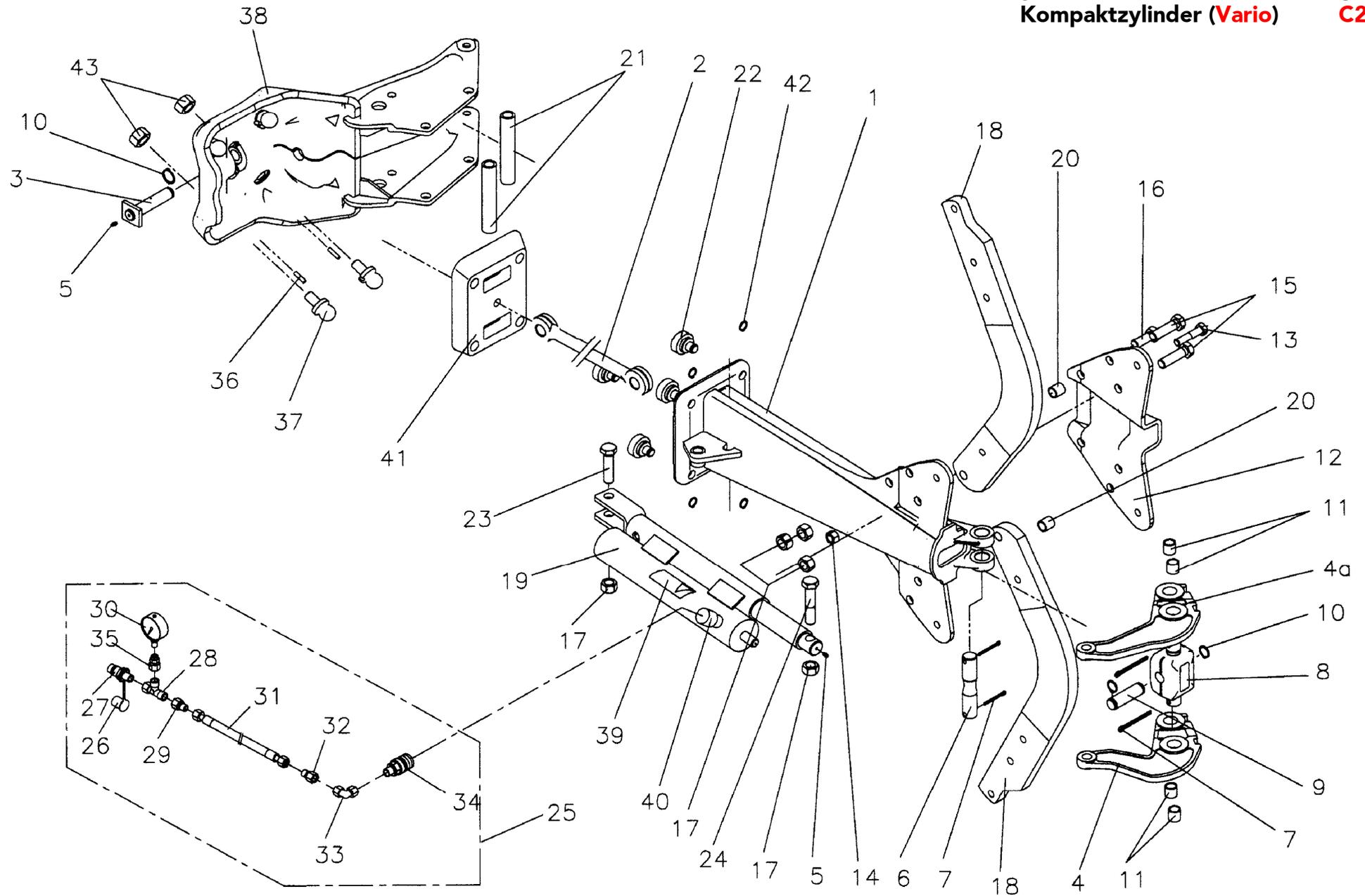
**Hydr. NON-STOP-Steinsicherung mit Kompaktzylinder**
