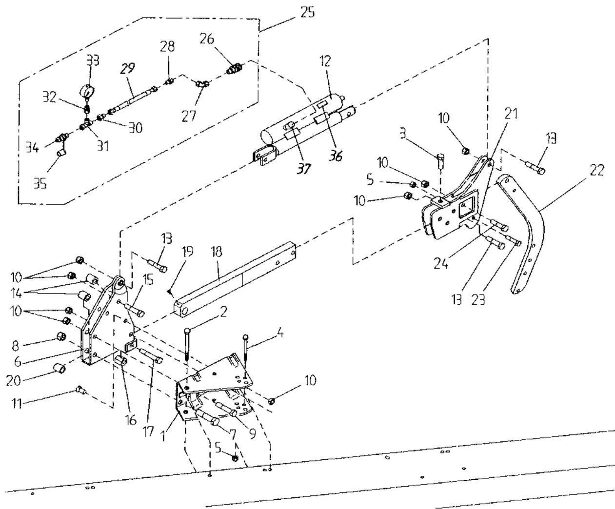
**Hydr. NON-STOP-Steinsicherungselement mit Kompaktzylinder**
