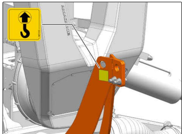
Elementos de elevación colocados inadecuadamente en el depósito de abono.
