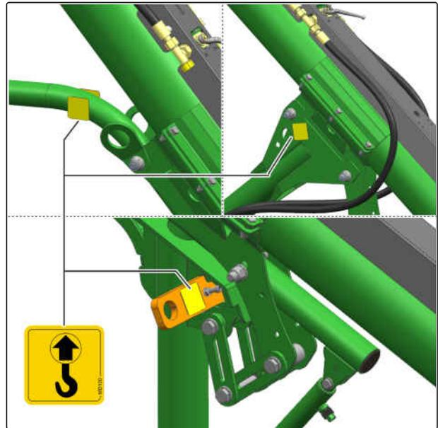
En las máquinas sin sinfín de llenado existen puntos de amarre en las rejillas de siembra centrales **1**.
