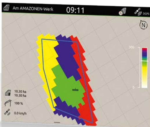
Représentation d'une carte de modulation sur l'AmaTron 4
