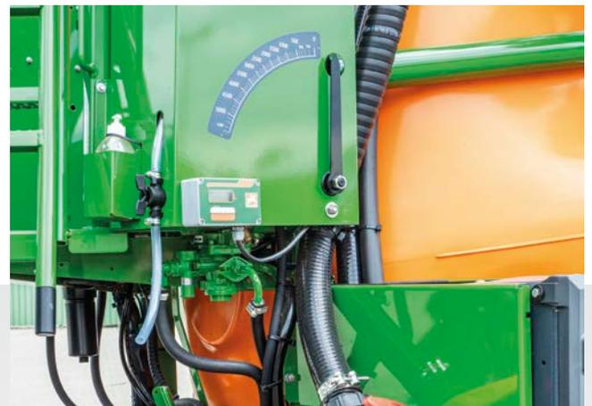
UX 5200 Special avec pack Confort et affichage digital du niveau de remplissage
