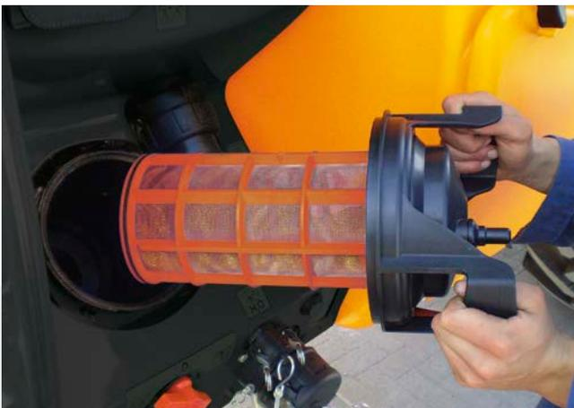
Le filtre d'aspiration peut être ouvert et nettoyé sans perte de bouillie, même lorsque la machine est pleine.
