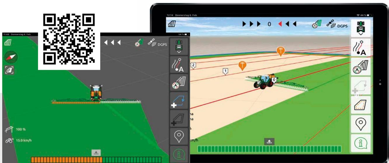
Mode d'affichage Cartes avec AmaTron Twin – Représentation claire de la machine et de ses tronçons et boutons de commande à droite de l'écran de la tablette
