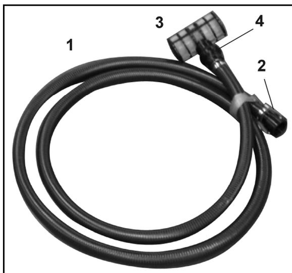
Support du tuyau d'aspiration sur rampe Super-S
