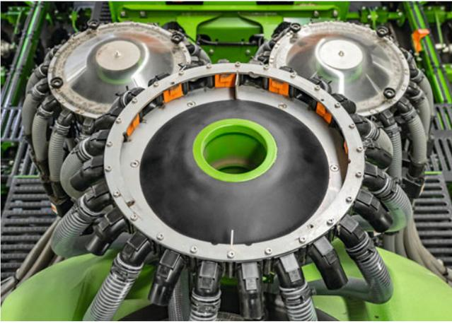
Segmentverteilerkopf zur exakten Verteilung des Saatgutes
