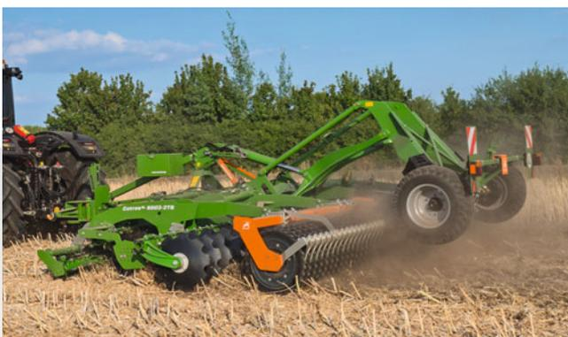
Catros<sup>XL</sup> 6003-2TS mit Schwenkfahrwerk und vorlaufender Messerwalze
