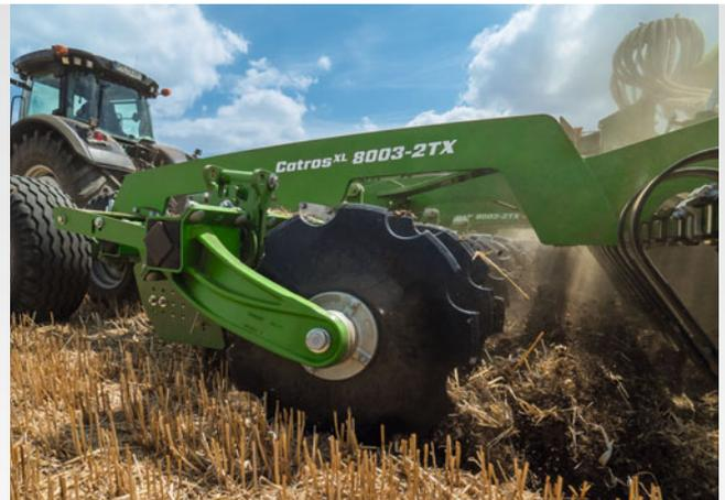
Catros<sup>XL</sup> 8003-2TX mit speziell geformtem Scheibenarm aus Gusseisen
