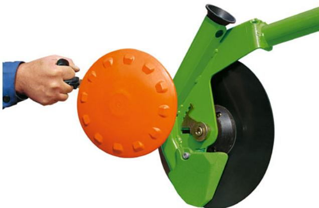
Per profondità di semina particolarmente elevate, il disco di guida in profondità dev'essere rimosso tramite l'apposita maniglia.
