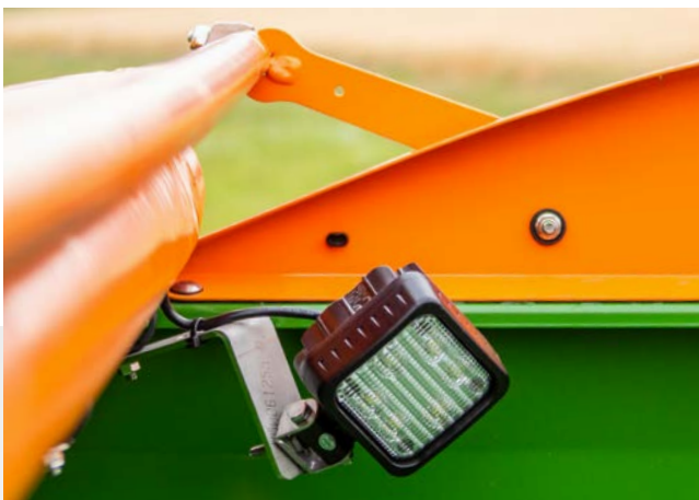
Éclairage de l'intérieur de la trémie
