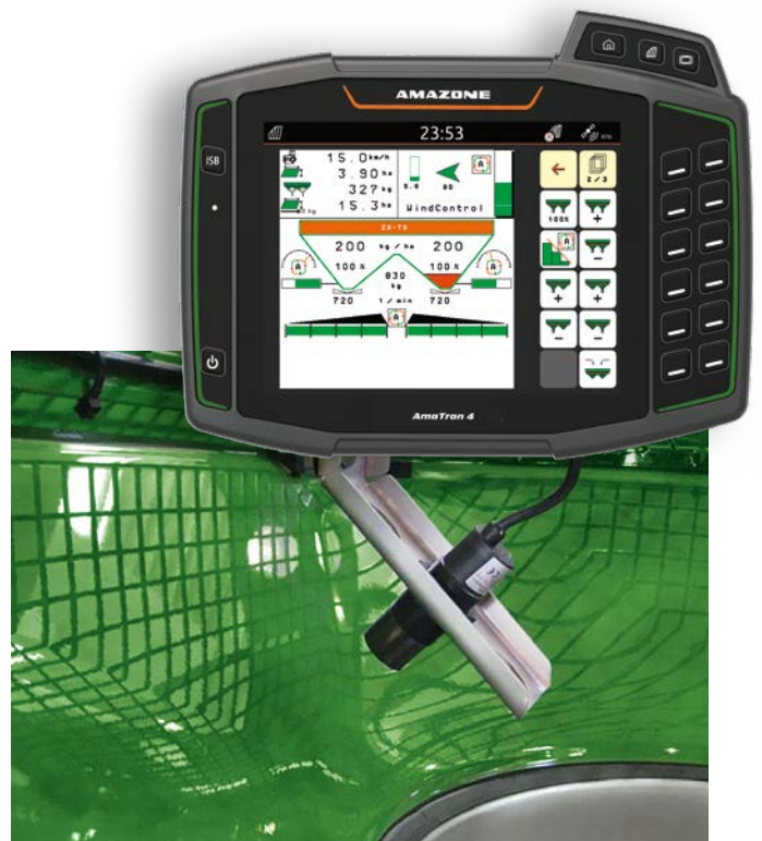
✓ Capteur de trémie vide sur le ZA-TS
